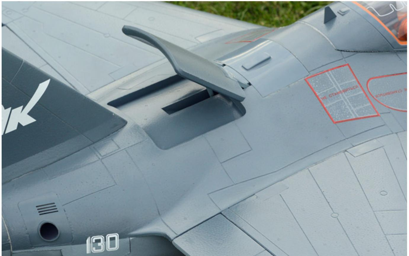
Das kann man, wenn man es unbedingt braucht, auch nachträglich erledigen. Dazu die Plastikabdeckung vor der Luftbremse in Richtung Cockpit vorsichtig lösen und dann kommt man an das Servo. Wir haben eines mit 5 kg Stellkraft und Metallgetriebe eingebaut und über den Anlenkungsdraht ein CFK-Rohr mit 1,3 mm Innendurchmesser rüberschieben. So kann man die Luftbremse auch ohne Probleme im Flug hochstellen – zumindest als Showeffekt denn wie man sehen wird, ist dies in der Praxis nicht erforderlich.
