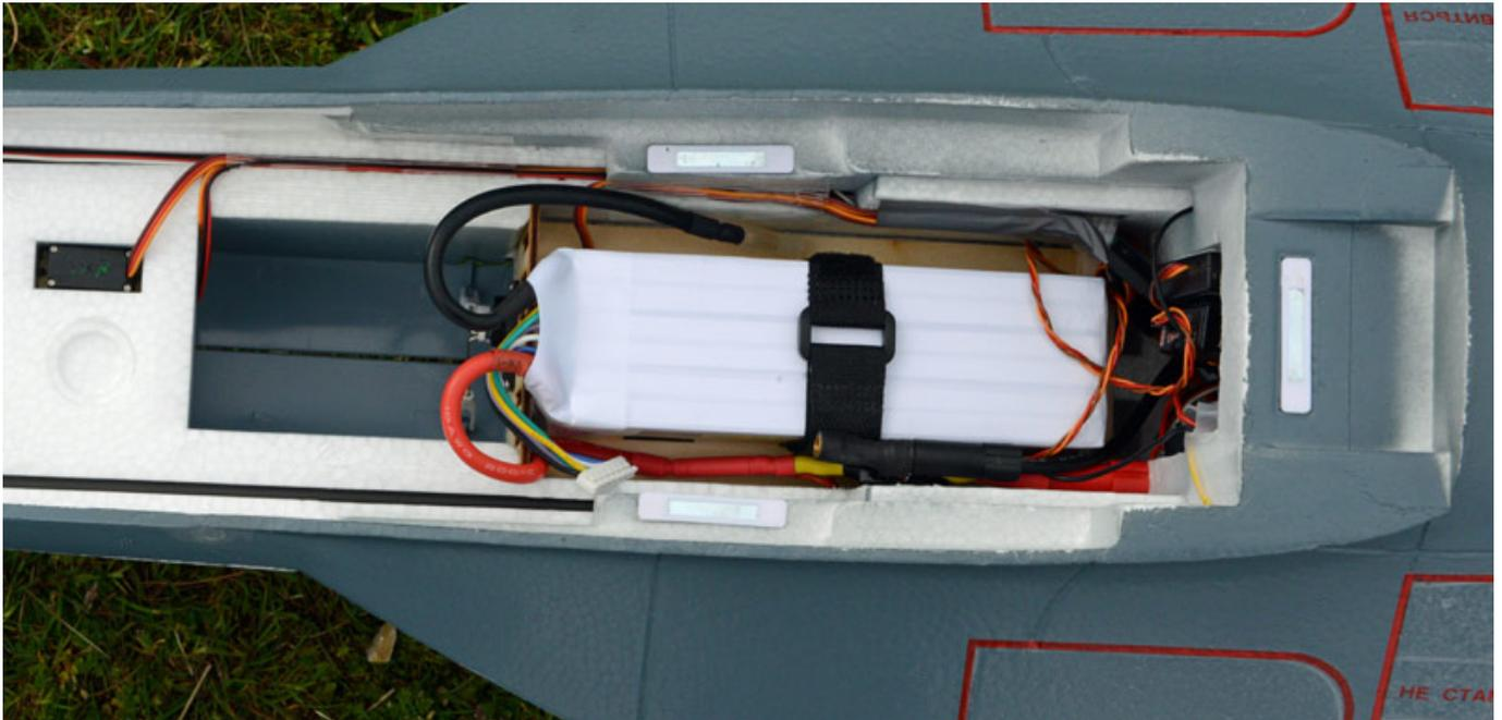
Den Empfänger klebt man mit selbstklebendem Klettband am besten nach der Verdrahtung auf das Sequenzer-Modul. Wenn man nun noch die seitlichen Servokabel mit einem Stück Gaffa-Tape sichert ist der Raum unter dem Cockpit sehr schön aufgeräumt. Kein Kabel ist im Wege.
