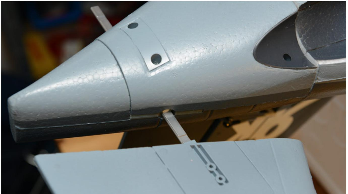
Nun ist die Heckmontage abgeschlossen und die beiden Höhenruder werden aufgeschoben und mit vier Schrauben gesichert. Die Schrauben müssen fest angezogen werden. Die Schrauben lassen sich zum Transport auch wieder lösen und die Höhenruder dann wieder abnehmen.
