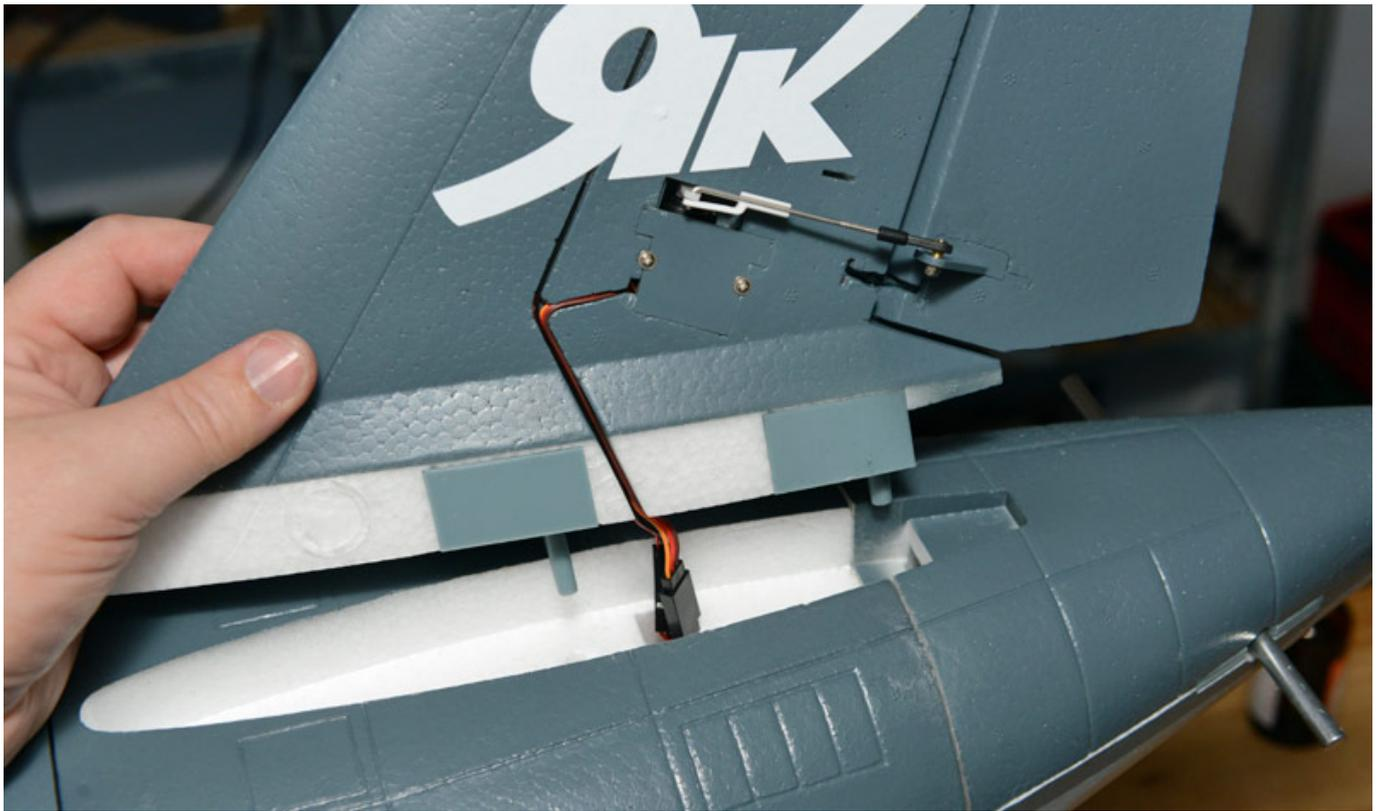
Nun ist noch das Seitenleitwerk zu befestigen. Hierzu muss man eine Servo- und eine Verbindung für die Beleuchtung herstellen, Kleber in die Aussparung, einsetzen und fertig. Am besten vorab mal das Seitenruder einsetzen und mit einem Servotester im Cockpitbereich mal das Seitenruder-Servo auf Funktion überprüfen bevor man das Seitenruder verklebt.
