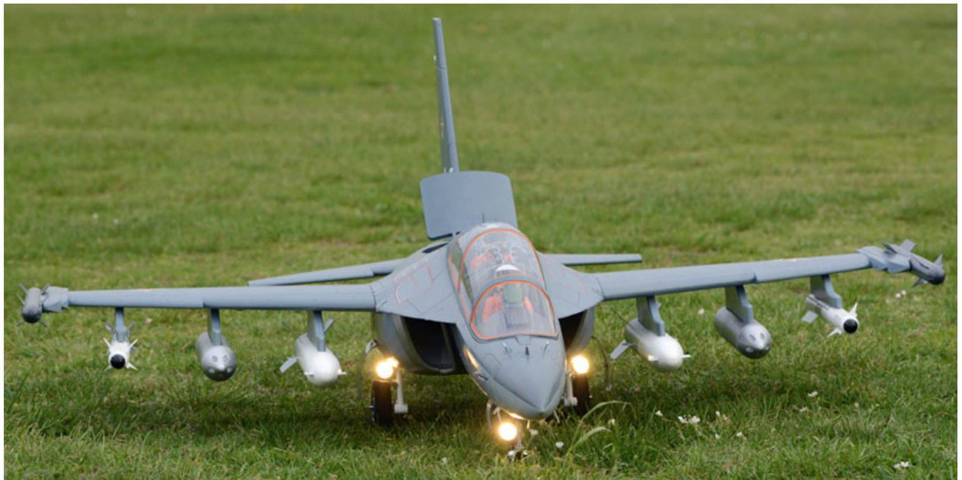
Die weiteren Flüge haben wir mit voll bestückten Waffenartrappen durchgeführt. Man muss sagen, dass die Erhöhung des Stirnwiderstands nicht so viel ausmacht wie gedacht, denn der Performance-Unterschied ist gering. Allerdings verschiebt sich der Schwerpunkt etwas nach vorne und man benötigt die großen Ausschläge.
