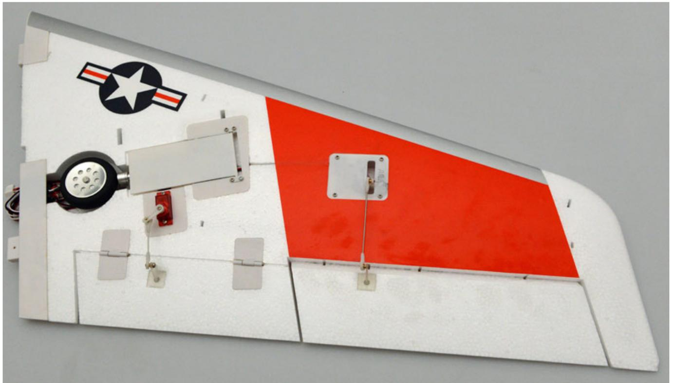
Sehr schön gelöst ist, dass man für die Flächenmontage auf dem Platz keine Servokabel anstecken muss sondern es gibt ein Multi-Pin-Stecker an der Tragfläche wo alle Signale aufliegen. Im Rumpfinnenen gibt es eine zentrale Platine wo die beiden Multi-Ppin-Stecker eingesteckt werden. Nun müssen noch die Kabel für Seiten- und Höhenruder in die Buchsen auf der Zentralplatine eingesteckt werden. Die Anleitung lässt leider offen, wo diese einzustecken sind.
