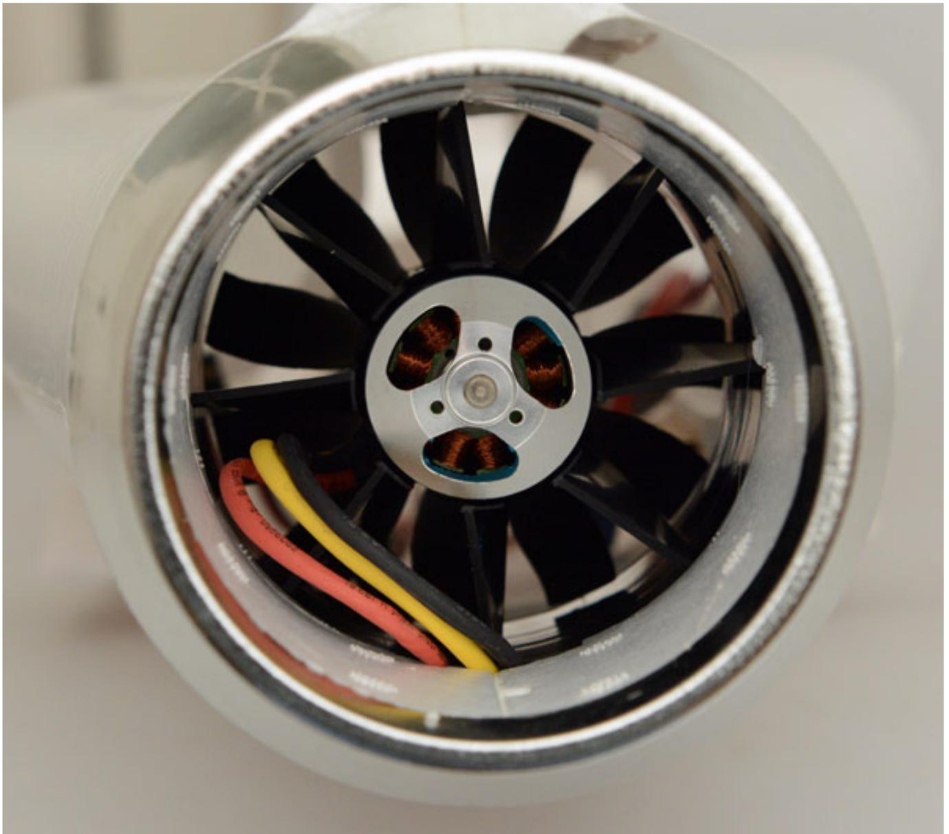
Der Impeller hat einen Durchmesser von 90 mm und besitzt elf Blätter. Als Motor kommt ein BL3541 (mit 1450 KV) zum Einsatz. Der Sound ist dank der elf Blättern und der niedrigen Drehzahl sehr Jet-like mit viel Strömungs- und wenig Motorgeräusch.
