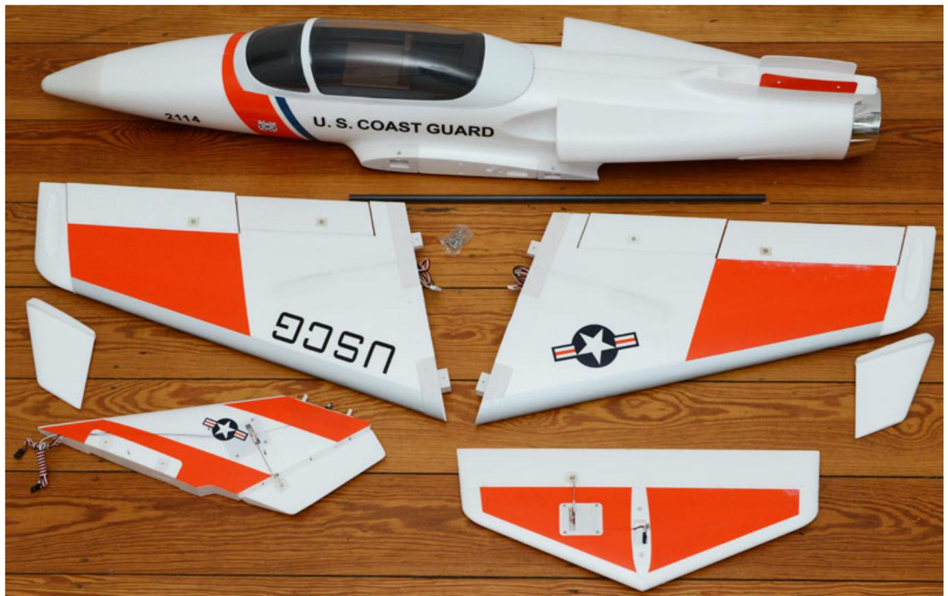
Weiter werden zwei Tragflächen, Winglets, Seiten- und Höhenleitwerk sowie ein Holm und Schrauben mitgeliefert. Es wird nichts geklebt sondern alles geschraubt. Die Tragflächen verfügen über fertig installierte Servos und Hauptfahrwerke. Auch im Höhen- und Seitenleitwerk sind die Servos eingebaut und angelenkt und entsprechende Servoverlängerungen sind ebenfalls verlegt.
