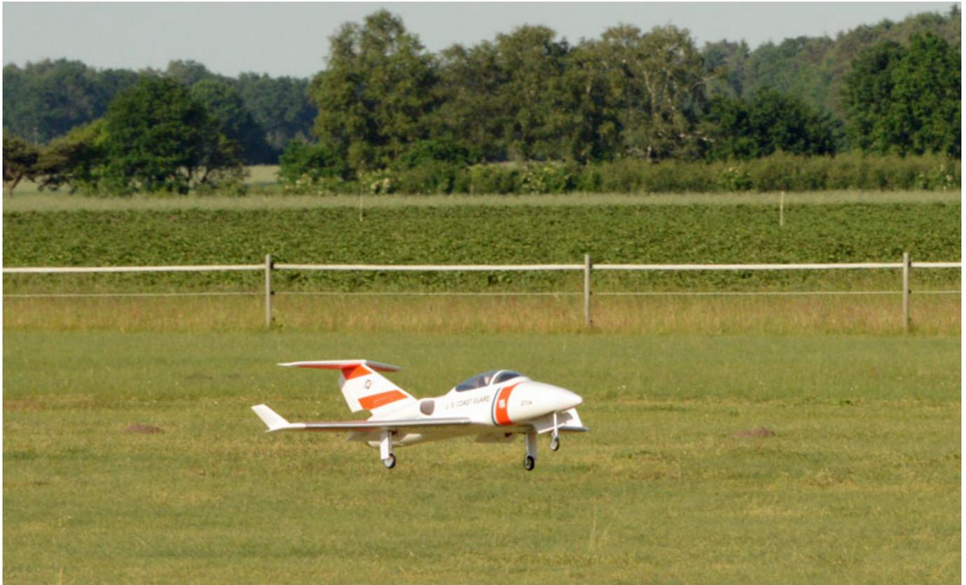
Die Landung ist mit dem Valkyrie-Jet sehr einfach. Ich setze schon in der Kurve beim Endanflug halbe Klappen und wenn das Modell gerade zur Piste ist setze ich dann volle Klappen. Das Modell segelt sehr gut und man kann, selbst an windstillen Tagen, sehr früh das Gas ganz rausnehmen und den Flieger ausgleiten lassen. Kurz vor der Bodenberührung muss man ggf. das Höhenruder ganz durchziehen. Hier hilft wenn man die Ausschläge vor der Landung auf "High" stellt.
