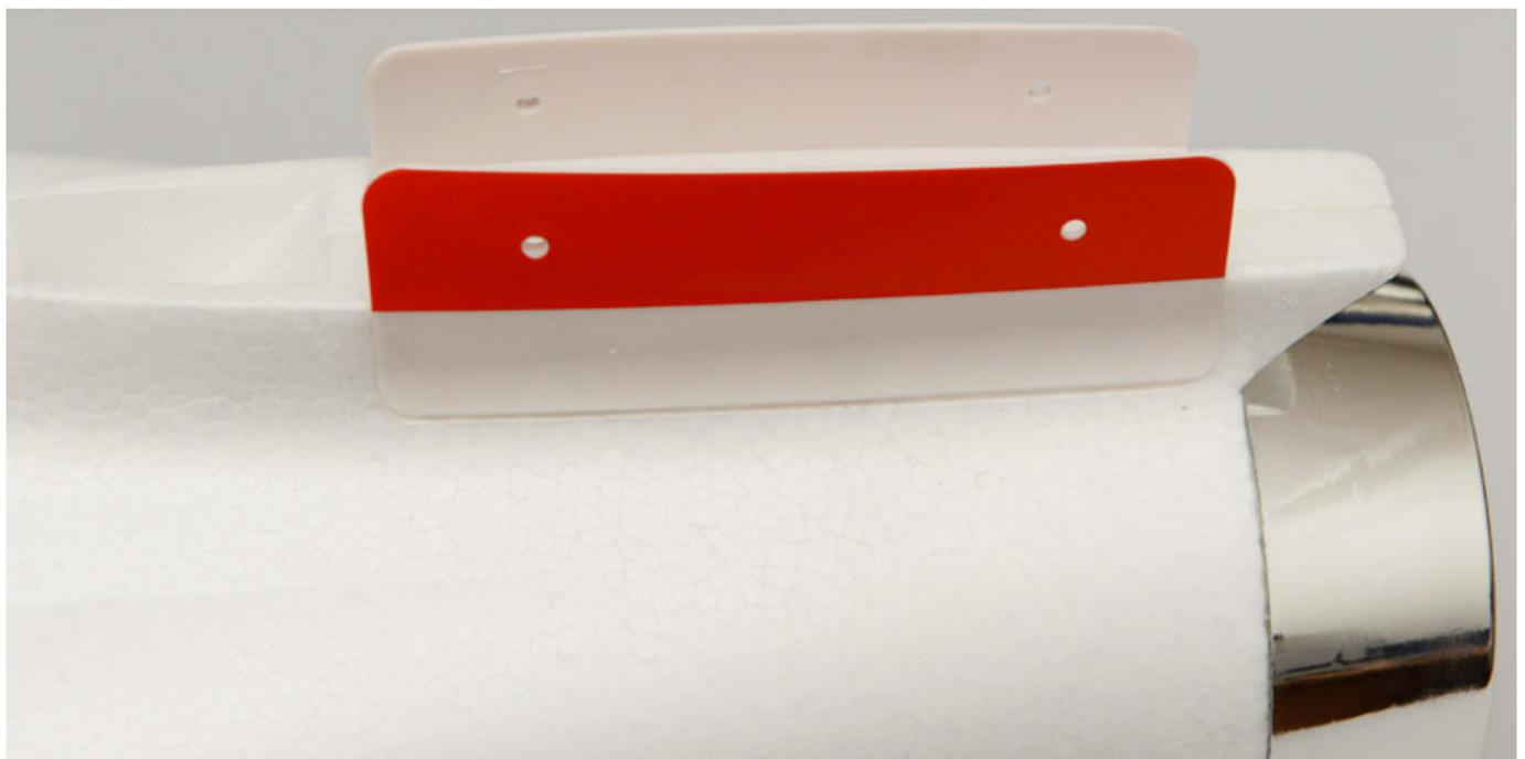
Auf dem Seitenleitwerk wird nun das Höhenleitwerk angebracht.
