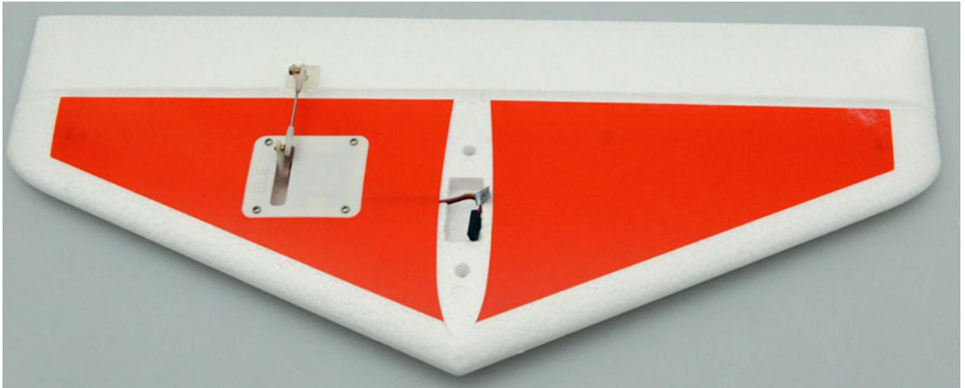
Auch hier wird als erstes das Servokabel angesteckt (s. Abb. unten) und dann das Höhenleitwerk aufgesetzt und mit zwei Schrauben fixiert.
