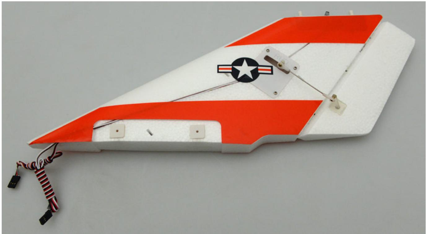
Der Valkyrie ist ja mit einem T-Leitwerk ausgestattet. Als erstes wird das Seitenleitwerk montiert indem das Servokabel an der Verlängerung angeschlossen wird und dann Leitwerk eingesetzt und verschraubt wird. Man muss darauf achten, die richtigen Schrauben zu verwenden.
