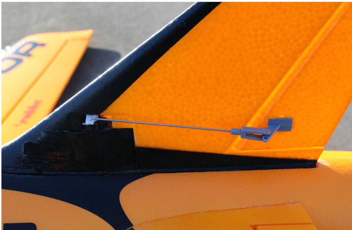
Das getrennte Höhenruder wird von zwei Servos angesteuert, die unter dem Höhenleitwerk im Rumpf verbaut sind.
