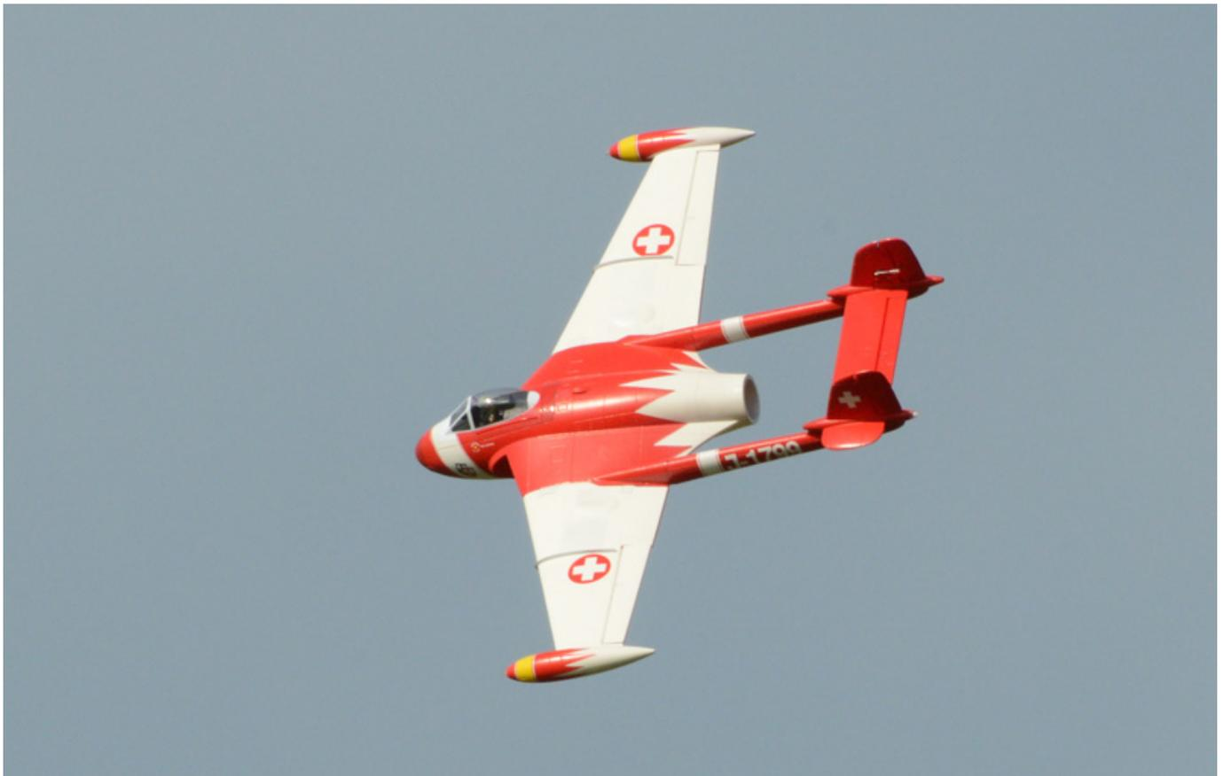
Man kann die Venom lange Zeit mit Halbgas fliegen, denn dann ist sie immer noch agil unterwegs und es spart Akkukapazität. Mit dem 4.400 mAh Akku lassen sich leicht über fünf Minuten Flugzeit erreichen und wenn man sehr sparsam fliegt, kann man auch noch ein paar Minuten draufpacken. Es macht daher auch keinen richtigen Sinn einen 5000er-Akku einzusetzen, der das Modell schwerer macht. Der 4400er-Akku ist der beste Kompromiss. Ggf. sollte man besser einen 40 C LiPo-Akku vorsehen.
