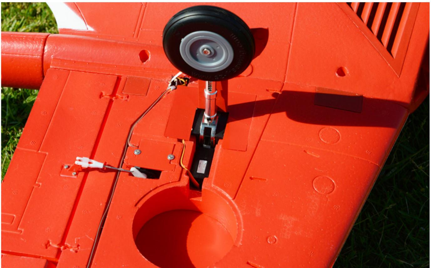
Auch beim Bugfahrwerk (s. Abb. unten) ist die Aufnahme nun aus Alu. Beim ersten Testmodell hatten wir öfter ein Problem mit der vorderen Klappe. Bei der Venom V2 trat dieses Problem im Test nun nicht mehr auf.
