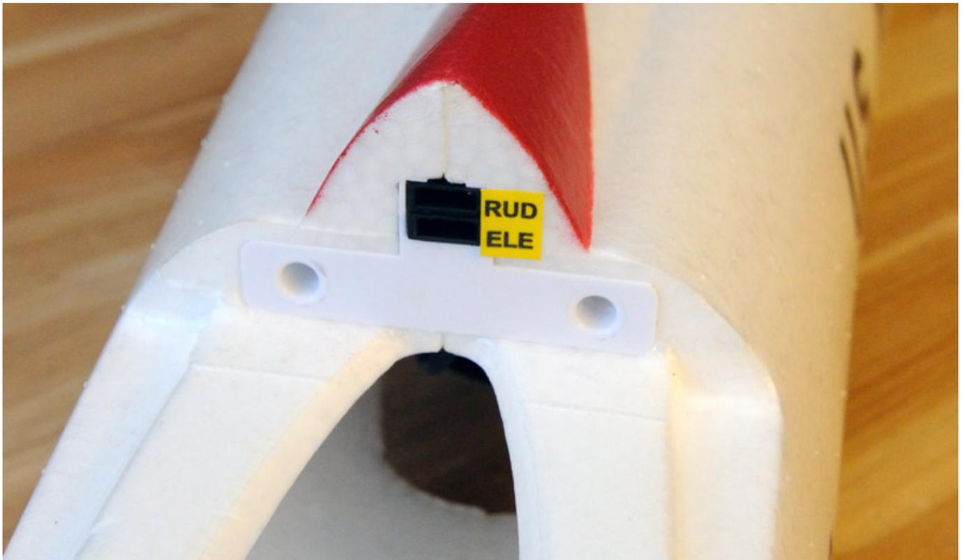
Nach dem Verbinden der beiden Servokabel wird das Höhenleitwerkssegment aufgelegt. Man sollte nun vor der weiteren Montage testen, ob sich die Höhenruder bei angeschlossenem Empfänger in der Neutralstellung befinden. Ansonsten
