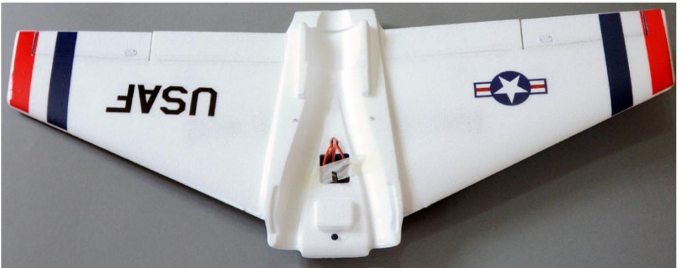
Das Höhenleitwerk ist ebenfalls schon mit dem Servo für das Höhenruder sowie dem Servo für das Seitenruder ausgestattet. Das geteilte Höhenruder ist auch bereits angelekt.
