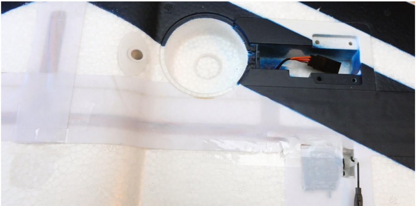
Nach dem Einsetzen des Beines in die Hauptfahrwerkskulissen muss man das Fahrwerk einlegen und das Bein so kürzen, dass das Rad genau in die dafür vorgesehene Aussparung passt. Auf die Längenangabe im Handbuch kann man sich verlassen. Die passt genau.
