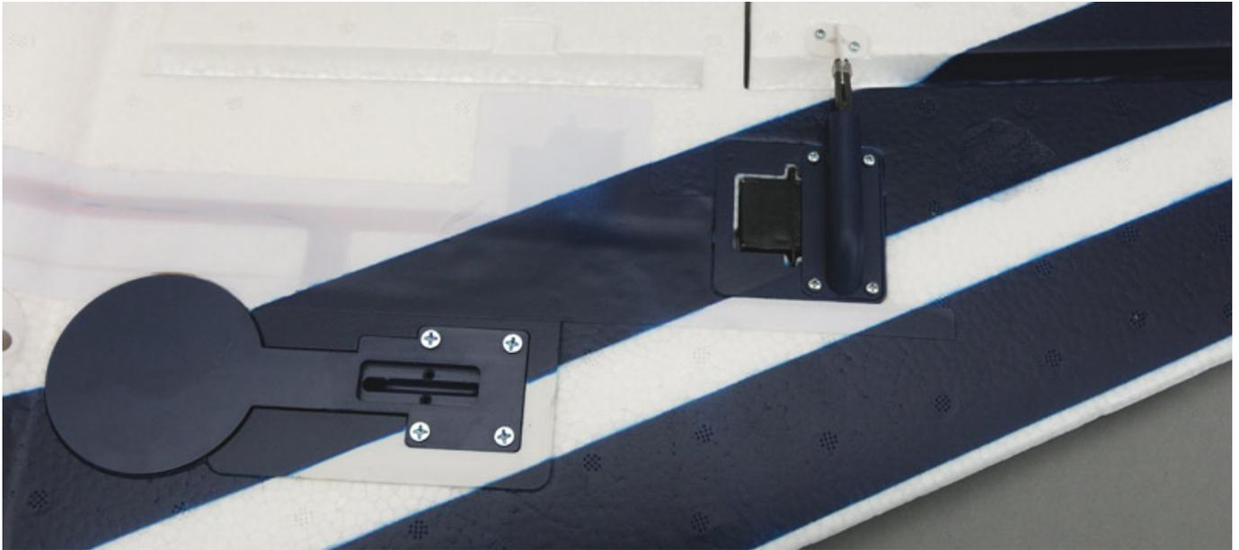
Neben den Servokabeln für die Querruder sind auch schon die Servokabel für das optionale Einziehfahrwerk verlegt. Unten im Bild sieht man, dass bei Verwendung der Landeklappen sechs Servokabel zu stecken sind.
