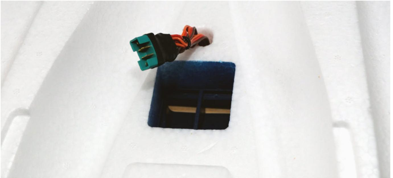
Die Servokabel für Höhe und Seite sind nach hinten durchgeführt und am Heck schauen zwei Servokupplungen heraus. Die beiden Kupplungen sind entsprechend beschriftet (s. Foto unten).
