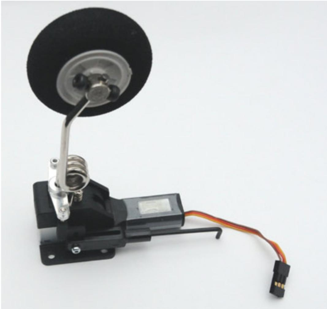
Das Fahrwerk wird nun mit der angebauten Anlenkung eingesetzt und festgeschraubt und dann im Servo eingeklinkt und mit einem Clip arretiert. Auch hier muss man die Stellen auf denen die Schrauben auf den Fahrwerksdraht treffen unbedingt leicht flachschleifen und die Schrauben nicht vergessen mit Sicherungslack zu sichern.
