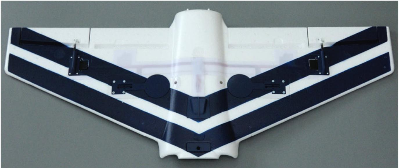
Der Flügel besteht aus einem Stück und die Servos für die Querruder sind bereits eingebaut und auch angelekt.
