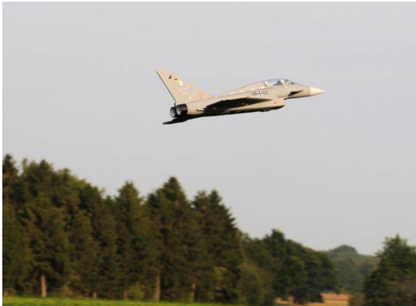
Die Performance ist für ein Standardantrieb überraschend gut. Hier macht sich der Doppelantrieb mit zwei Impellern sowie die großen Cheater Holes auf der Rumpfunterseite, die für viel zusätzliche Ansaugluft sorgen, positiv bemerkbar. Loopings, Abschwünge, Immelmans sowie Rollen sind kein Problem. Ein Langsamflug kann man mit entsprechendem Anstellwinkel - ganz wie man es von einem Delta gewohnt ist - erreichen. Eine Flugzeit von fünf Minuten ist auch bei flottem Flugstil kein Problem.
