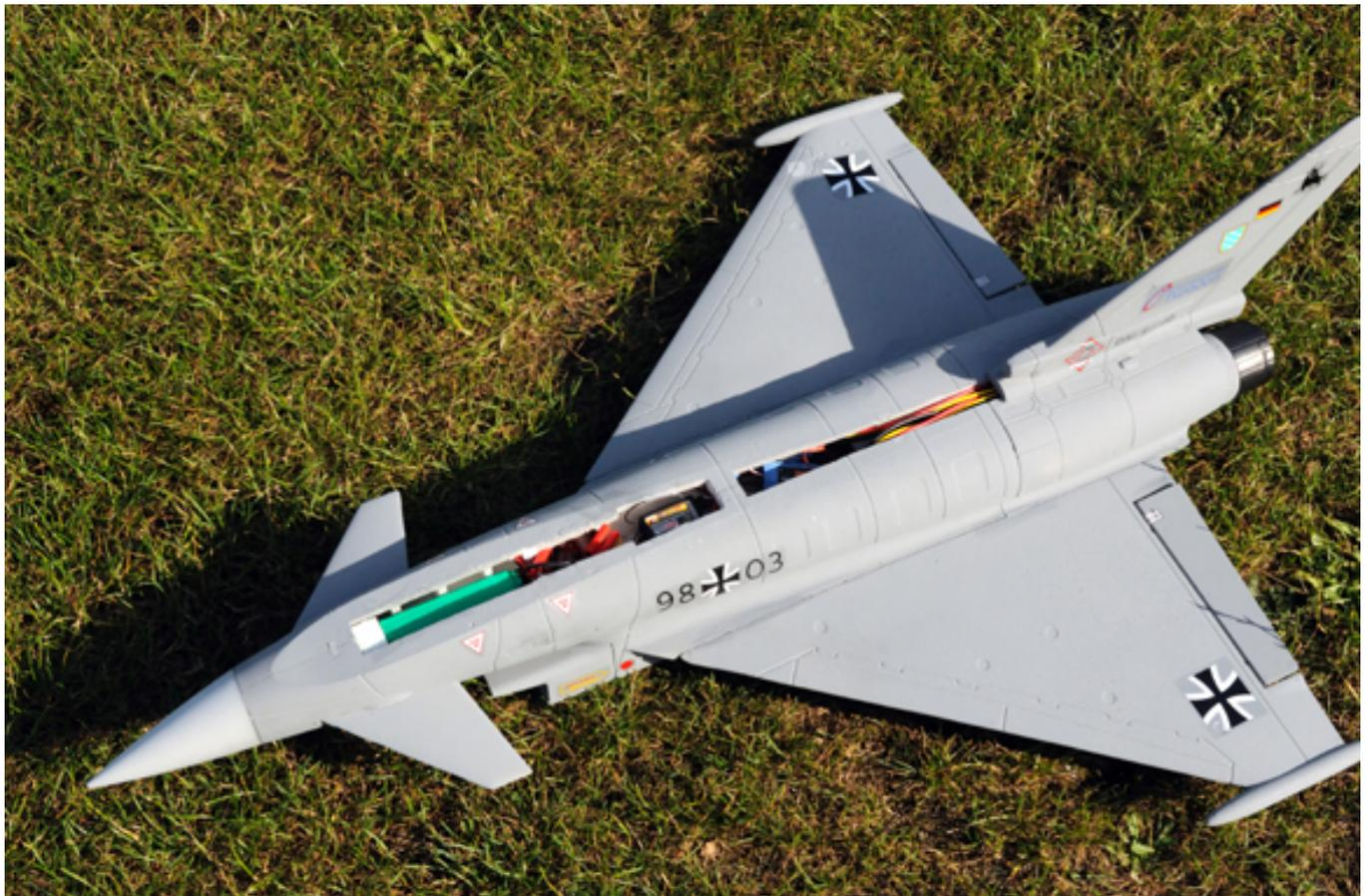
Geliefert werden in beiden Fällen ein Rumpf mit eingebautem Antrieb (5-Blatt-Impeller und Außenläufer-Brushless-Motor), zwei Flügelhälften, zwei Canards, Seitenleitwerk, fertiges Cockpit mit zwei Piloten sowie ein Rumpfberteil. Die Konstruktion darf man als sehr gelungen bezeichnen. Da können sich andere Hersteller mal den J-Power Eurofighter als Vorbild nehmen.
