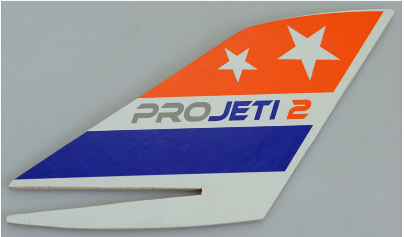
Festzustellen ist, dass auch bei richtigem Aufkleben der Dekorfolie eine Unsymmetrie entsteht. Es gibt eine Seite mit einem korrektem weißen Rahmen herum (s. Abb. oben) und eine Seite wo der orange Teil mit der Außenkante verschmilzt (s. Abb. unten). Man sollte die Folie so aufkleben, dass der Teil mit der weißen Außenkante (im Bild also unten) sich jeweils außen befindet.
