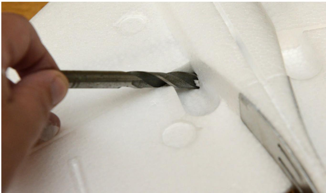
Wichtig ist dass die Löcher schräg gebohrt werden so dann man auf der anderen Seite im Innenraum des Rumpfs herauskommt (s. Abb. unten).
