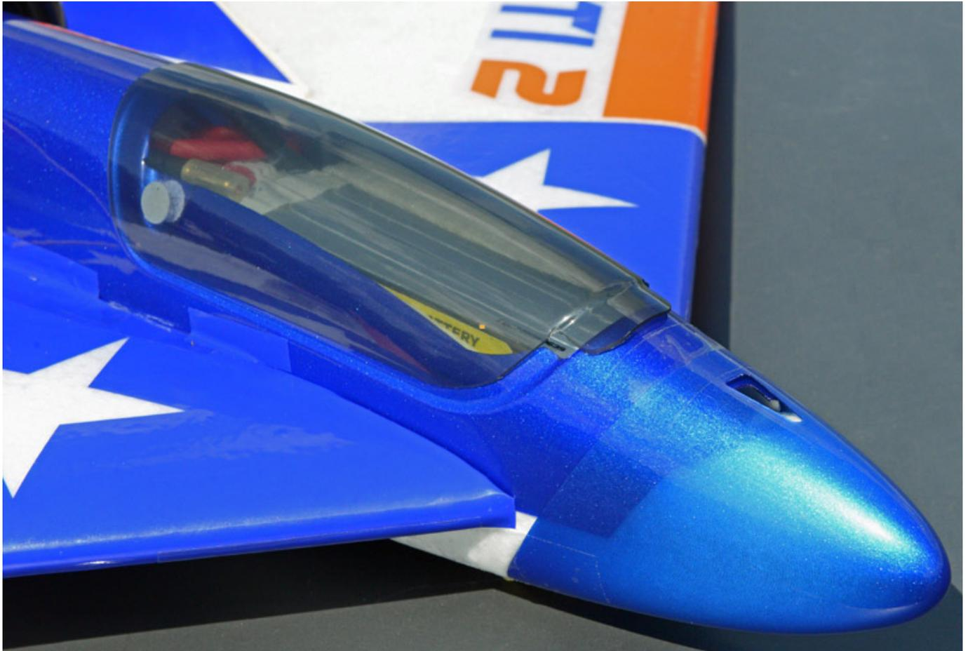
Die Nase (s. Abb. oben) wird einfach bei aufgesetztem Rumpfrückenteil aufgestülpt und mit drei Tesastreifen (zwei unten an den Seiten und einer oben) befestigt. Ein Verkleben mit Sekundenkleber ist nicht erforderlich.
