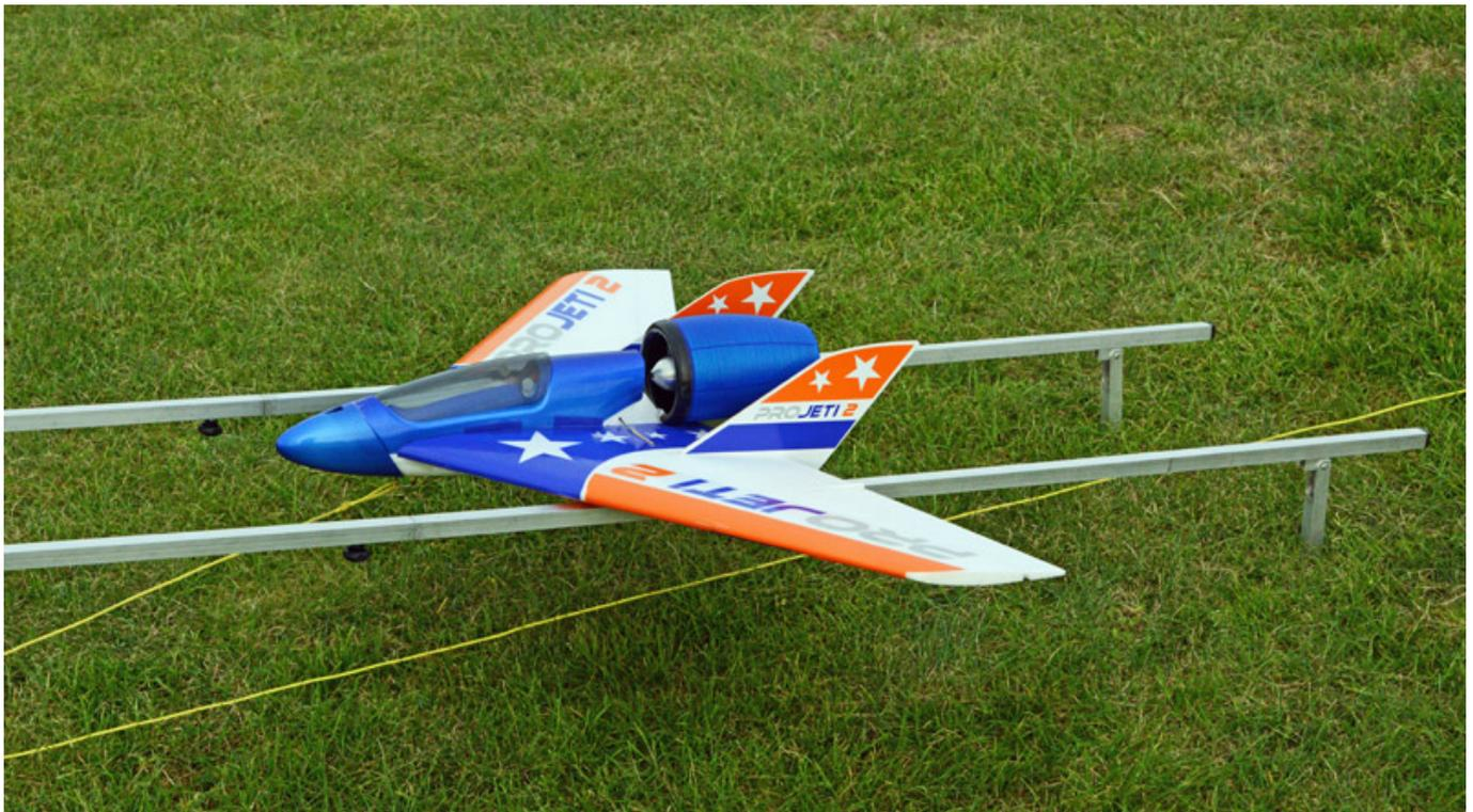
Nach Auslösen des Gummiseils stieg der Projeti EDF und wurde mit zusätzlichem Höhenrunder auf Flughöhe gebracht. Nach Ausschalten der zusätzlichen Höhenruderausschläge für die Startflugphase sank der Projeti EDF deutlich durch und es musste ordentlich Höhe getrimmt werde.
