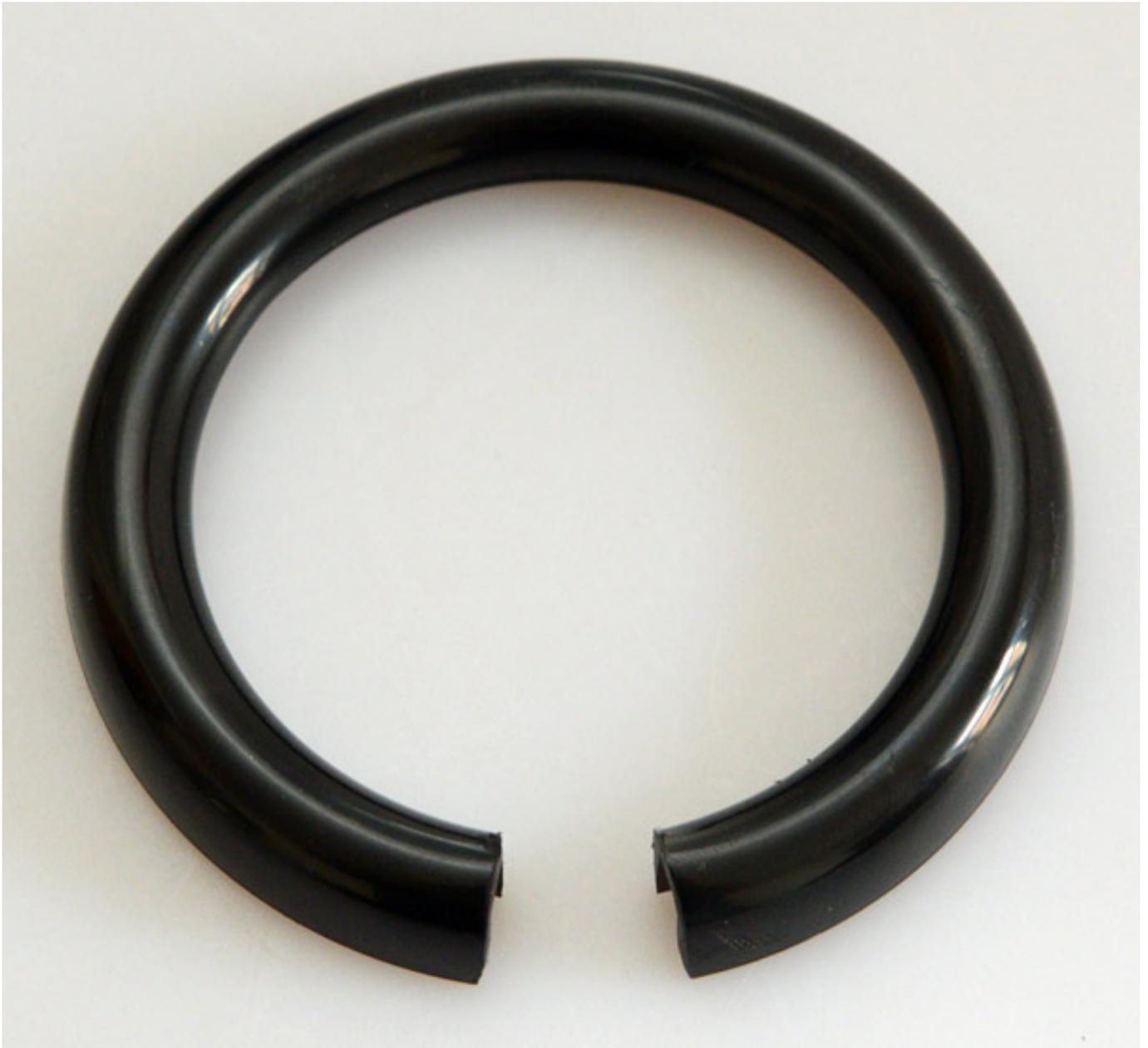
Die Lippe umdrehen und dann außen so viel mit einem Dremel oder ähnlichem Werkzeug wegschleifen (s. Abb. unten), dass die Lippe sich auf die Impeller-Gondel aufsetzen lässt ohne das unten am Rumpf etwas klemmt. Die Lippe aber erst später montieren, in dem man an der Impeller-Gondel und innen an der Lippe ein paar Tropfen Sekundenkleber mit mittlerer Viskosität aufbringt. Man sollte auf keinen Fall Aktivator aufsprühen, denn dann kann sich innen die Gondel durch die Dämpfe weiß verfärben.
