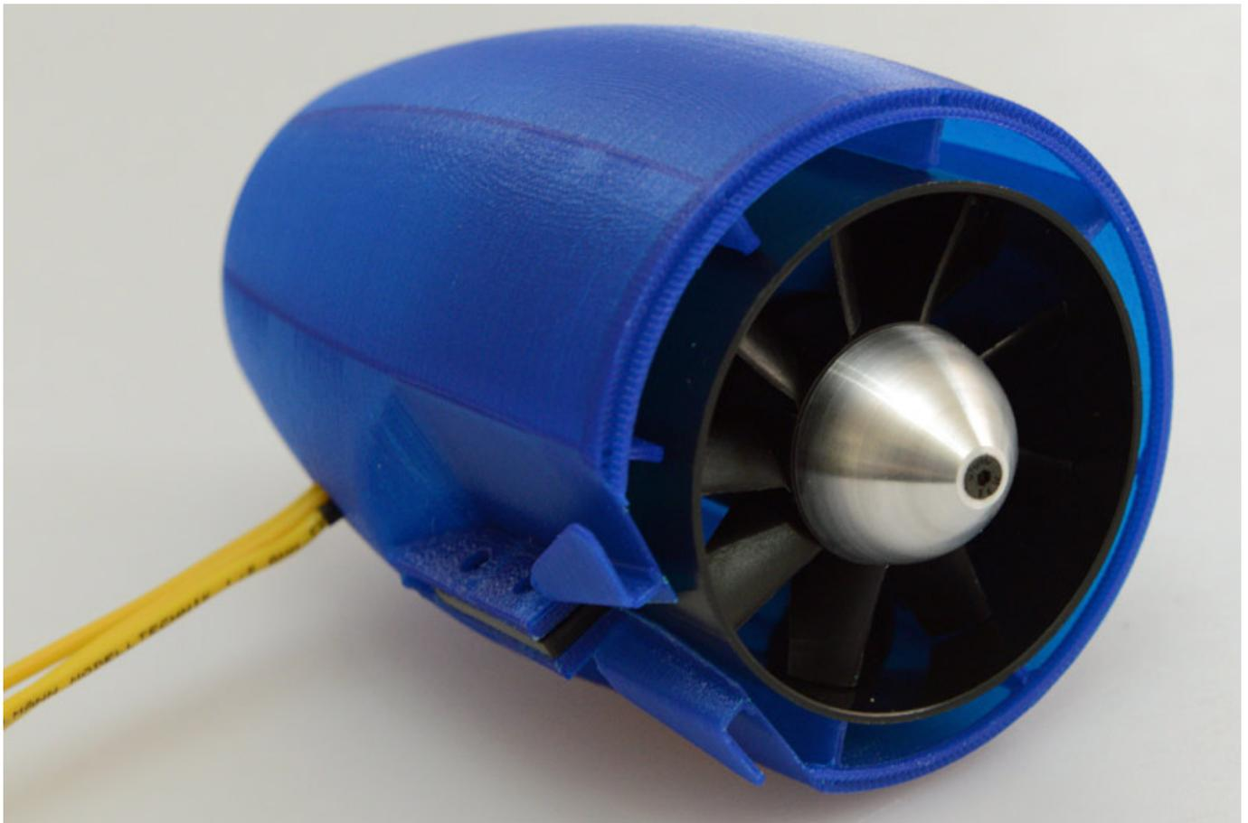
Nun muss die Impeller-Einlauflippe für die Montage vorbereitet werden. Dazu zunächst die Lippe auftrennen und einen Spalt von ca. 20 mm einbringen (s. Abb. unten).
