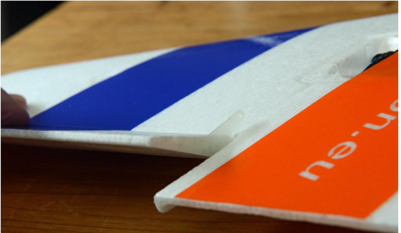
Die Ruderhörner werden zunächst mit 400er-Schleifpapier auf der Klebeseite angeschliffen und mit mittelflüssigem Sekundenkleber an der Seite des Ruders angeklebt (s. Abb. oben). Auf exaktes Ausrichten achten. Nach kurzer Zeit Aktivator aufsprühen. Wenn das Ruder fixiert ist ggf. etwas mit dünnflüssigem Sekundenkleber oben und unten an der Klebestelle nachkleben.
