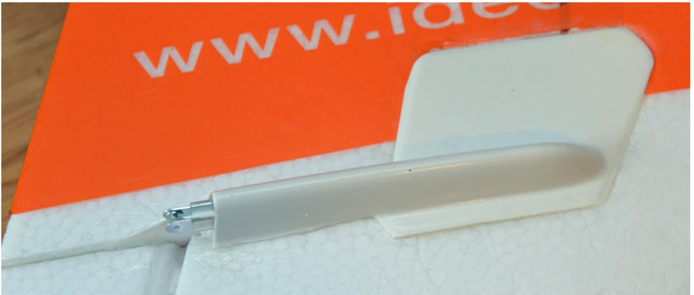
So und nun kommen wir zu den Dingen die anders sind als bei der Propellerversion nämlich der Antrieb. Die Impellergondel (s. Abb. unten) ist sehr schon konstruiert. Sie wiegt ca. 50 Gramm und ist im hinteren Bereich Doppelwandig mit integriertem Schubrohr. An der Gondel sind vor dem Einbringen des Impellers noch einige
