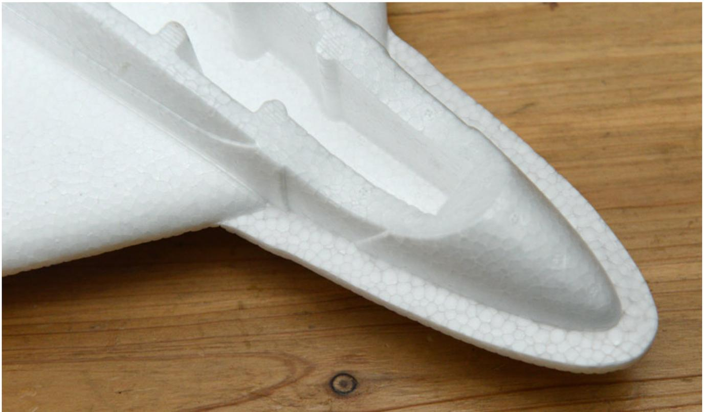
Als erstes muss man am Rumpf den fertigungsbedingten Überstand (s. Abb. oben) entfernen und mit 400er-Schleifpapier glattschleifen (s. Abb. unten). Die Oberfläche der Flügel und der Rumpf muss dann ebenfalls mit 400er-Schleifpapier von kleinen fertigungsbedingten Noppen befreit werden.
