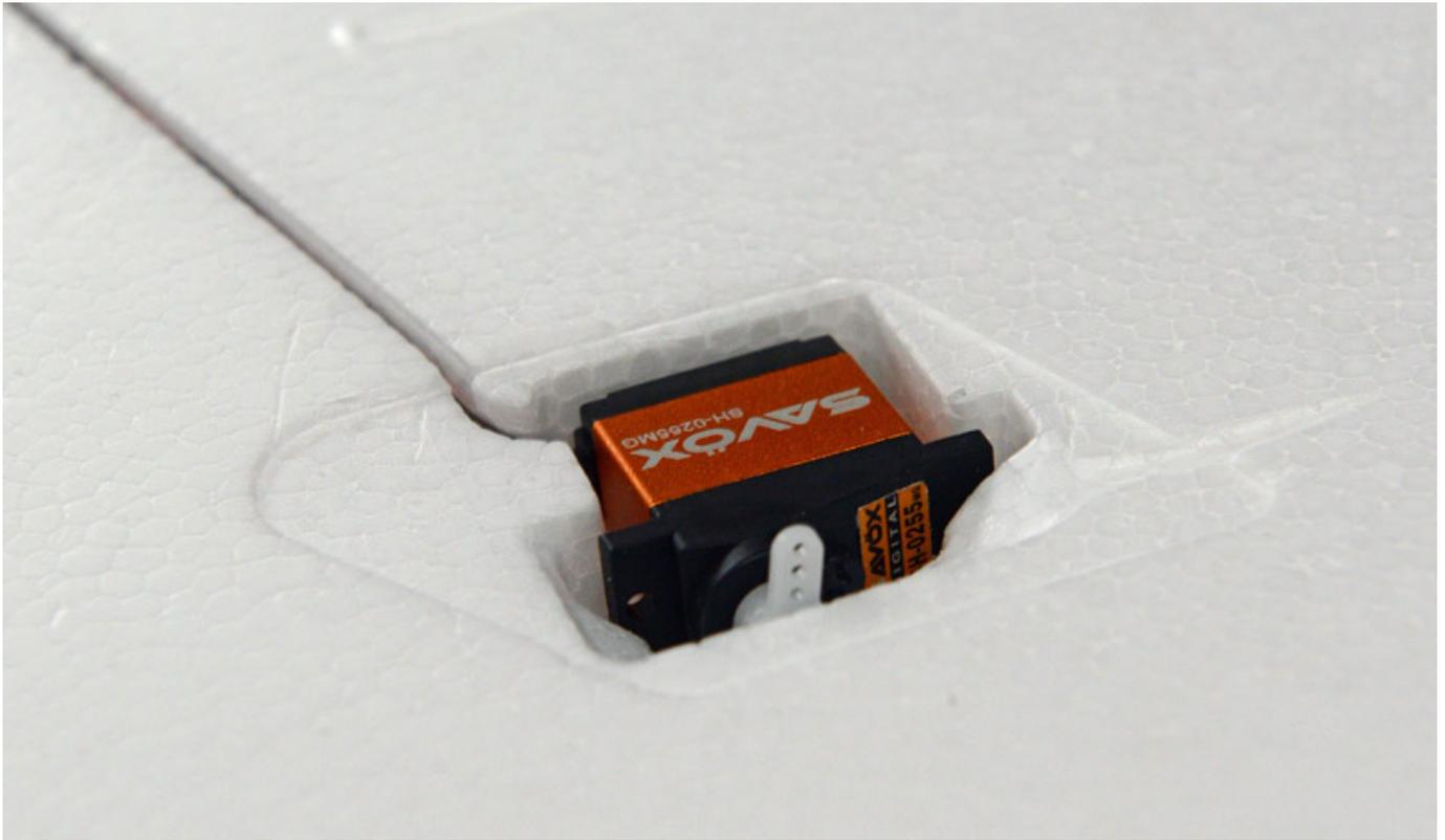
Von den technischen Anforderungen her passt der Servo perfekt. Wir haben das Servo mit ein paar Tropfen Sekundenkleber in den Schaum geklebt. Die Aufnahme für die Servos ist allerdings für größere Servos gedacht gewesen. Den Hohlraum sollte man mit etwas Holz ausfüllen und mit etwas Beli-Zell um den Servo herum den Servo etwas einschäumen (s. Abb. unten).
