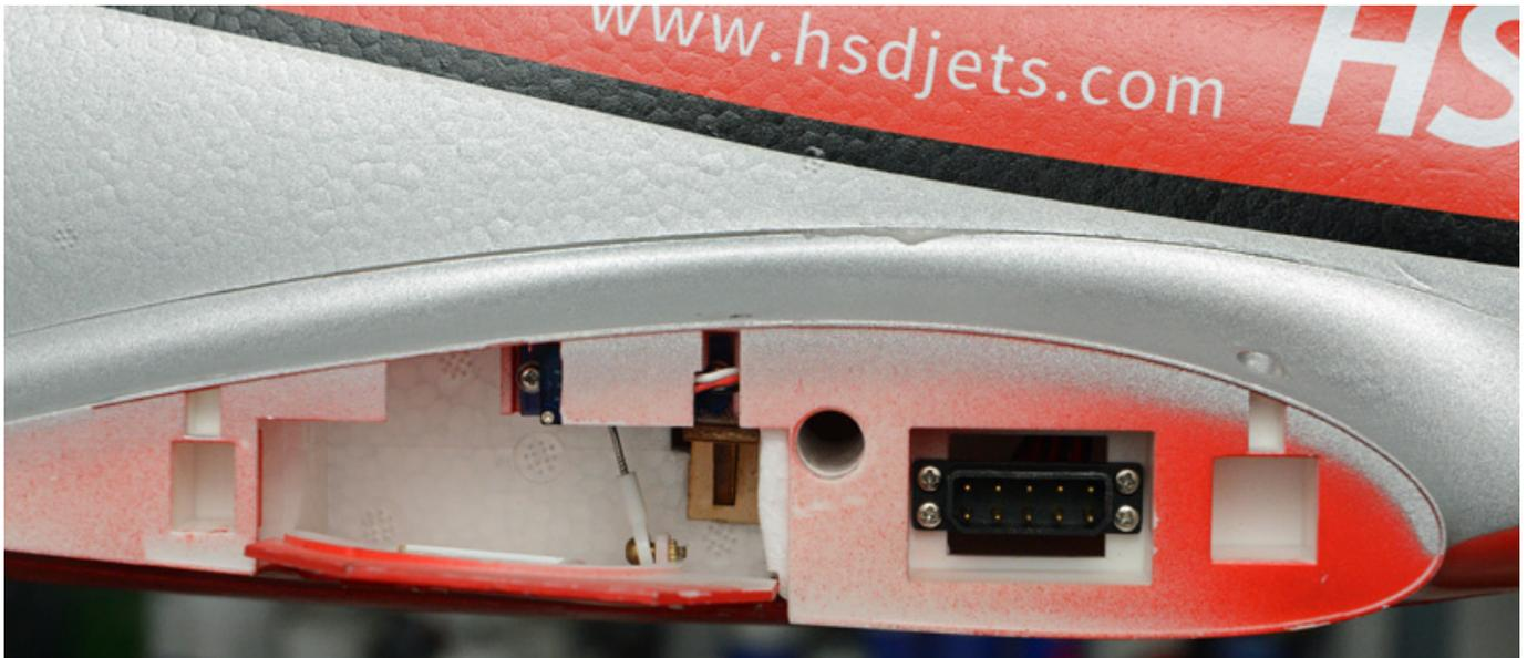
Das Fahrwerk und alle Klappen sind bereits ab Werk montiert. Die Winglets sind übrigens in der Form mit geschäumt worden und werden nicht nachträglich montiert. Schade, dass man diese nicht abnehmbar ausgeführt hat. Winglets leider ja leider immer beim Transport, wie auch die unteren Stabilisatoren, die ebenfalls aus Schaum gefertigt sind. Hier muss man halt etwas Obacht geben.
