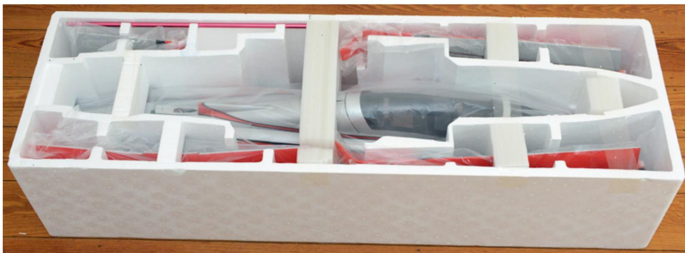
Die Anzahl der Komponenten ist sehr überschaubar: komplett fertiger Rumpf mit eingebautem Antrieb, Regler, Elektronik und dem Cockpit sowie Flügel, Höhen- und Seitenleitwerk, Alu-Steckungsrohr und Kleinteile, sowie eine englischsprachige Anleitung. Allerdings braucht man die Anleitung eigentlich erst beim Nachschlagen der Werte für die Einstellen der Ruderausschläge denn alles andere ist weitgehend selbsterklärend.
