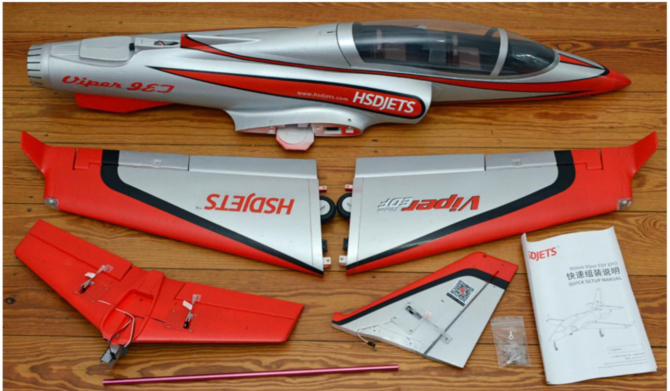
Alle Servos sind eingebaut und auch schon angelenkt. Ersatzteile für die Anlenkung liegen auch noch bei. Auch die Beleuchtung, Fahrwerke und Fahrwerkklappen sind montiert und angelenkt. Der Vorfertigungsgrad ist also für einen Jet dieser Größe sehr hoch. Auffällig auch, dass die Komponenten die verbaut werden alle hochwertig sind. So kommen zum Beispiel 12-Gramm-Servos mit Metallgetriebe zum Einsatz.
