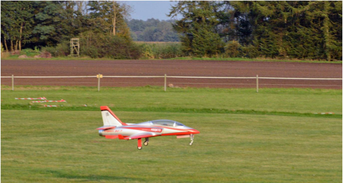
Das Fahrwerk ist absolut Rasen-tauglich und sehr robust. Es ist das Beste was ich bisher bei einem ARF oder RTF-Jet gesehen habe. Kleines Manko ist, dass die Räder relativ klein - aber dafür scale - sind und Maulwurfshügel müssen unbedingt umfahren werden sonst bleibt man stecken.
