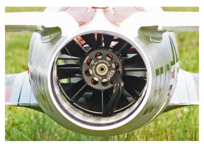
Nun zum Antrieb. Der maximale Strom betrug 123 Ampere. Damit braucht man sich keine Gedanken um eine Überhitzung des verbauten 160-Ampere-Regler machen, da er im Luftstrom gut gekühlt untergebracht ist.
