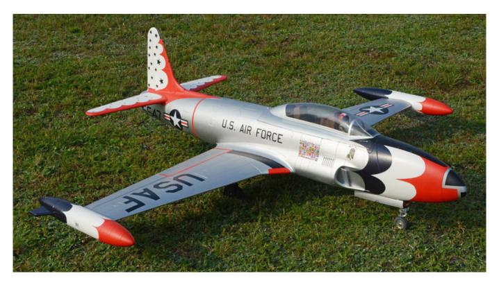
Neben Freewing hat auch HSD nun eine EDF-Modell der Lockheed T-33 Shooting Star herausgebracht und zwar eine gigantisch große mit 1.800 Millimeter Länge und einer beachtlichen Spannweite von 2.018 Millimeter mit üppiger Ausstattung. Sicherlich zurzeit das größte EDF-Schaummodell was in Serie hergestellt wird. Der Maßstab beträgt ca. 1:6, wobei die Flächen etwas größer sind als beim Original. Wir haben im August 2020 ein Modell von Natterer Modellbau zum Test bekommen.
