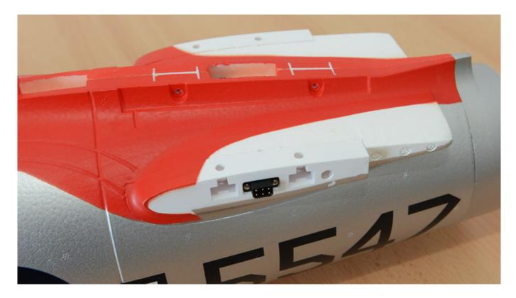
Die beiden Teile des Höhenleitwerks werden wie folgt montiert. Es wird der 6 mm x 650 mm Holm eingeschoben so dass er auf jeder Seite 250 mm herausschaut. Nun einfach die Höhenleitwerks-Komponenten aufschieben und verschrauben. Die Servoverbindung erfolgt über schon eingebaute Steckverbinder.
