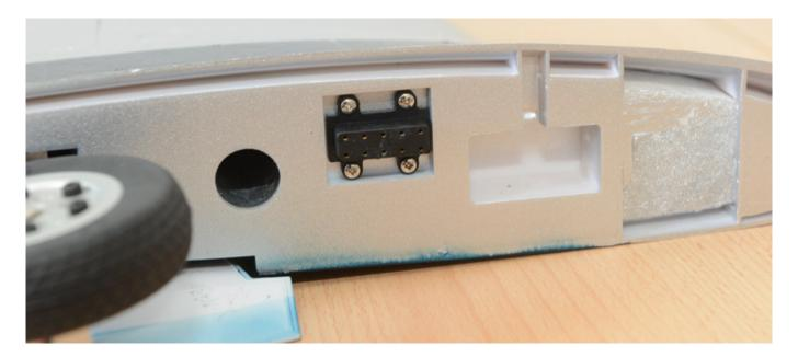
Nun muss man nur noch die Flügelhälften aufschieben und diese mit den vier 3 x 14 mm mit Innensechskant-Schrauben befestigen. Am besten nutzt man dazu einen Schraubendreher mit Sechskant wie den Wera 354 2,5 x 75. Einen Sechskant-Winkelschlüssel sollte man nicht nutzen, denn dann kann man sich bei der Montage leicht den Rumpf beschädigen. Bei unserem Testmodell ließ sich eine Schraube nicht eindrehen, da die Bohrung im Plastikstück am Flügel zu klein war. Die haben
