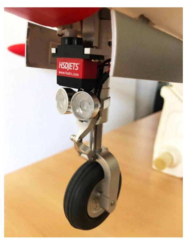
Die Fahrwerke sind sehr stabil ausgeführt. Der Landescheinwerfer wird automatisch geschaltet und zwar so intelligent: wenn das Fahrwerk ausgefahren ist und über die Control-Box die Empfängerpannung aktiviert wird, dann bleibt der Landescheinwerfer aus, damit nicht unnötig Strom fließt. Erst wenn das Fahrwerk
