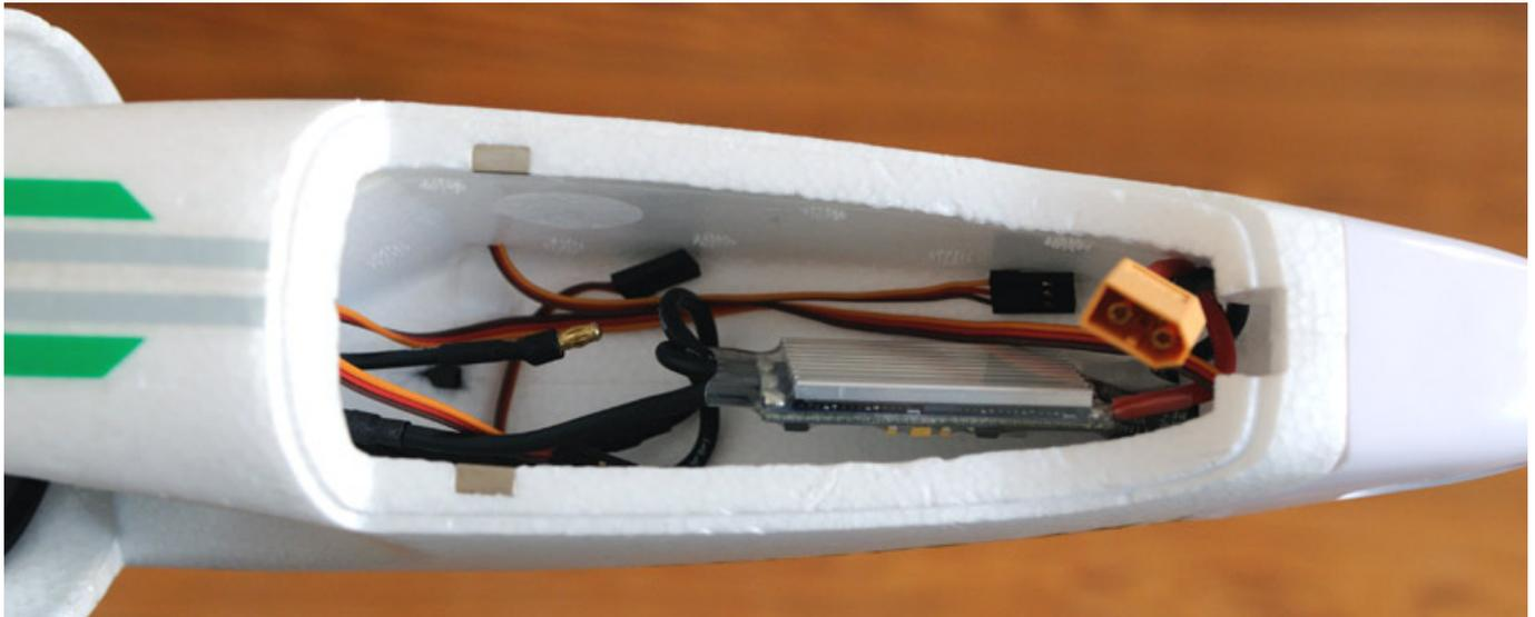
Nun muss nur noch der Empfänger angeschlossen und der Akku eingesetzt werden und der Flugspaß kann beginnen. Den vorhandenen Stecker für den Akkuanschluss am Regler haben wir als erstes gegen 4-mm-Goldstecker getauscht.
