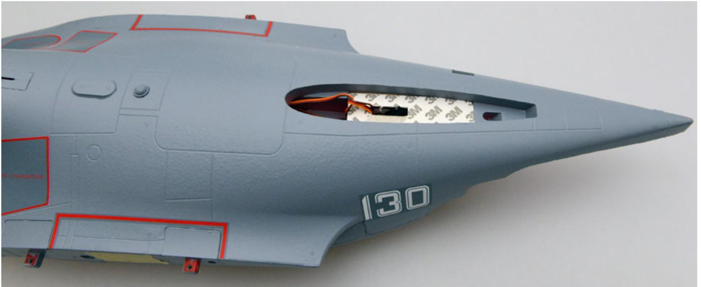
Im Rumpfhinterteil ist bereits ein zweiseitiges Klebeband eingebracht. Man steckt das Kabel des Seitenleitwerks in das Servo-Verlängerungskabel das aus dem Rumpf kommt, zieht die Schutzfolie des Klebeband auf der Oberseite ab, verstaute die Kabel und drückt dann das Leitwerk in den Rumpf. Wir haben zusätzlich noch vorne und hinten in der Rumpfaussparung für das Leitwerk zusätzlich noch etwas Kleber eingebracht.
