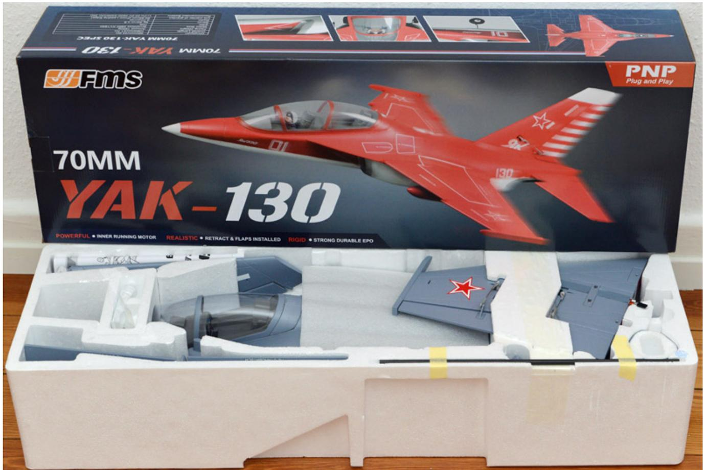
Schon bei einer ersten Sichtung des Bausatzes wird klar, dass das Wort Bauen keinen Platz hat denn es ist lediglich die Montage einiger weitgehend vorgefertigter Komponenten erforderlich. Der ganze Bausatz besteht aus Rumpf, Cockpit, Nase, zwei Flügel mit montierbaren Zusatztankartrappen, Seiten- und Höhenleitwerk.
