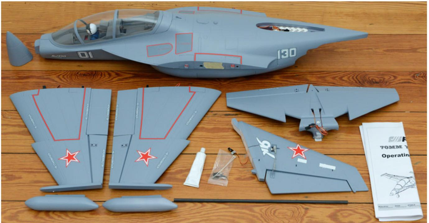
Der Rumpf inklusive abnehmbarer Cockpithaube und die Flügel und Leitwerke sind bereits komplett fertiggebaut und auch alle Servos (9 Gramm) und Kabel sind eingebaut und die Anlenkungen montiert. Auch der Antrieb und die Elektronik ist komplett verbaut. Ein verwendbarer Einkomponenten-Kleber sowie vier Schrauben für die Flügel und zwei für das Höhenleitwerk komplettieren den Bausatz.
