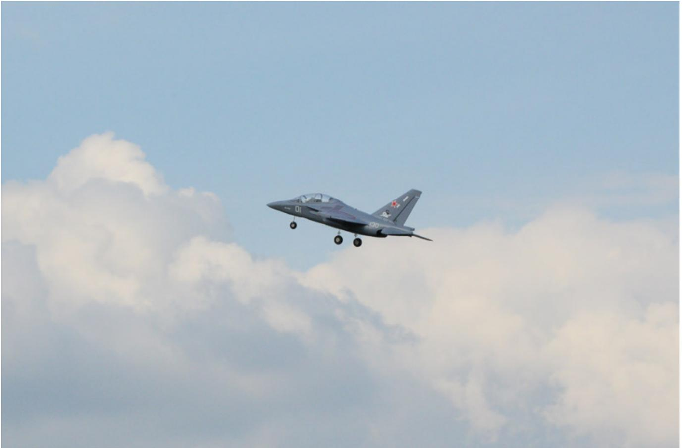
Der Start sollte ohne Klappen erfolgen. Die Klappen benötigt man nur für die Landung. Das Modell hat so viel Schub das auf Rasen bereits nach wenigen Metern abhebt. Bei unserem Modell war lediglich einiges an Höhentrimmung für Vollgasflug erforderlich. Alles anderen passte, auch der eingestellte mit ca. 82 mm eingestellte Schwerpunkt. In den Kurven muss man Jet-like ordentlich ziehen wenn man keine Höhe verlieren will.
