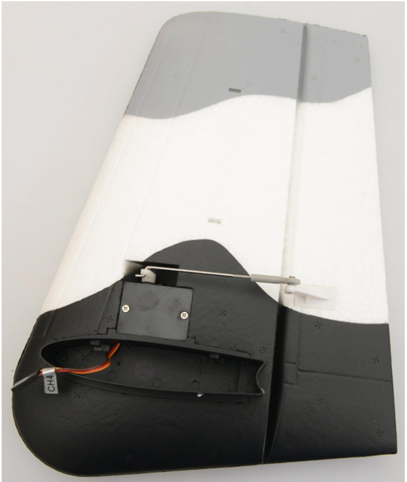
Zuvor müssen die Servokabel in die schon vorhandenen Verlängerungskabel angesteckt werden (s. Abb. unten).
