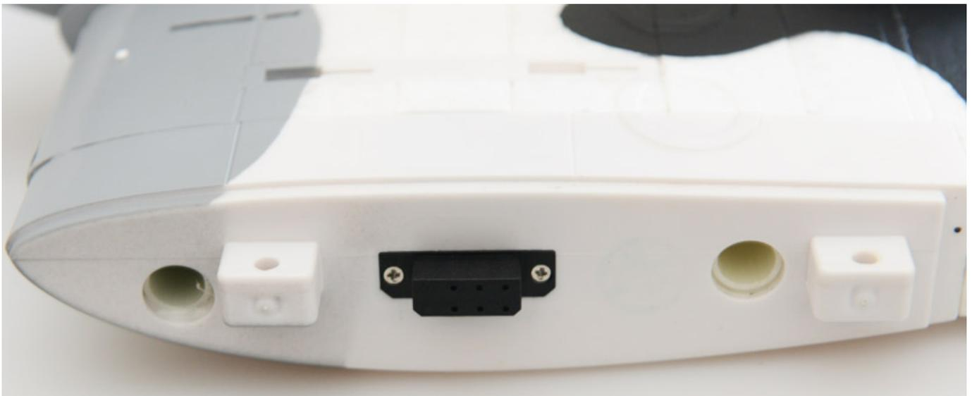
Sehr schön gelöst sind die elektrischen Verbindungen zwischen Rumpf und Flügelhälften und zwar über mehrpolige Buchsen an der Flügelenseite (s. Abb. oben) und entsprechende Stecker an der Rumpfseite (s. Abb. unten). Die Montage der Flügel erfolgt so, dass als erstes die beiden Holme eingeschoben werden.
