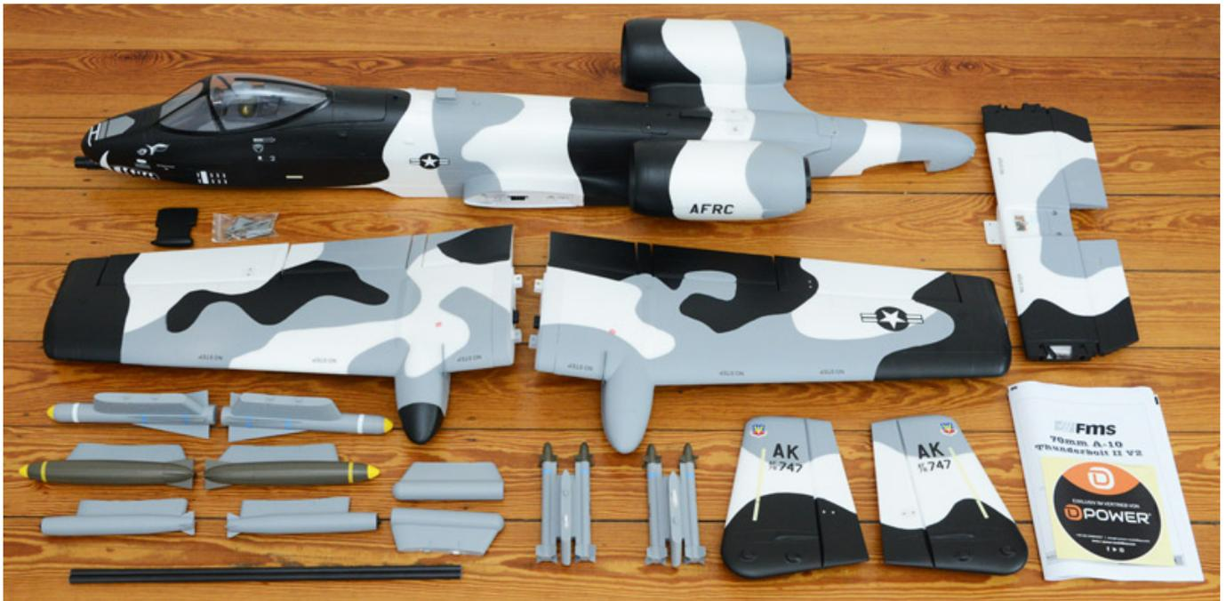
Das Semi-Cockpit ist auch mit einem Piloten versehen (s. Abb. unten). Die Waffenträger sind bei dem Modell - im Gegensatz zum Original - an den Attrappen angeformt. Wenn man diese nicht montiert fehlen also auch die Waffenträger am Modell. Das ist aber eine pragmatische Lösung die zu akzeptieren ist, da die Strömungsverhältnisse am Flügel ohne Attrappen und eben auch ohne Waffenträger besser sind, als mit Waffenträger.
