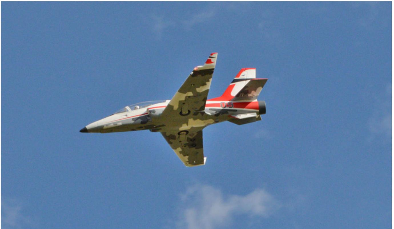
Der erste Start erfolgt sicherheitshalber mit halben Klappen, aber wie sich herausstellte, ist ein Klappensetzen beim Start mit der beschriebenen Konstellation von Komponenten überhaupt nicht erforderlich. Das Modell startet nach sehr kurzer Strecke nach leichtem Ziehen am Höhenruder. Beim Erstflug musste ich ganz wenig Querruder trimmen und Einiges an Tiefe, da der Flieger bei Vollgas deutlich stieg. Das ist nicht mein Fall, sondern ich ziehe dann ggf. lieber.
