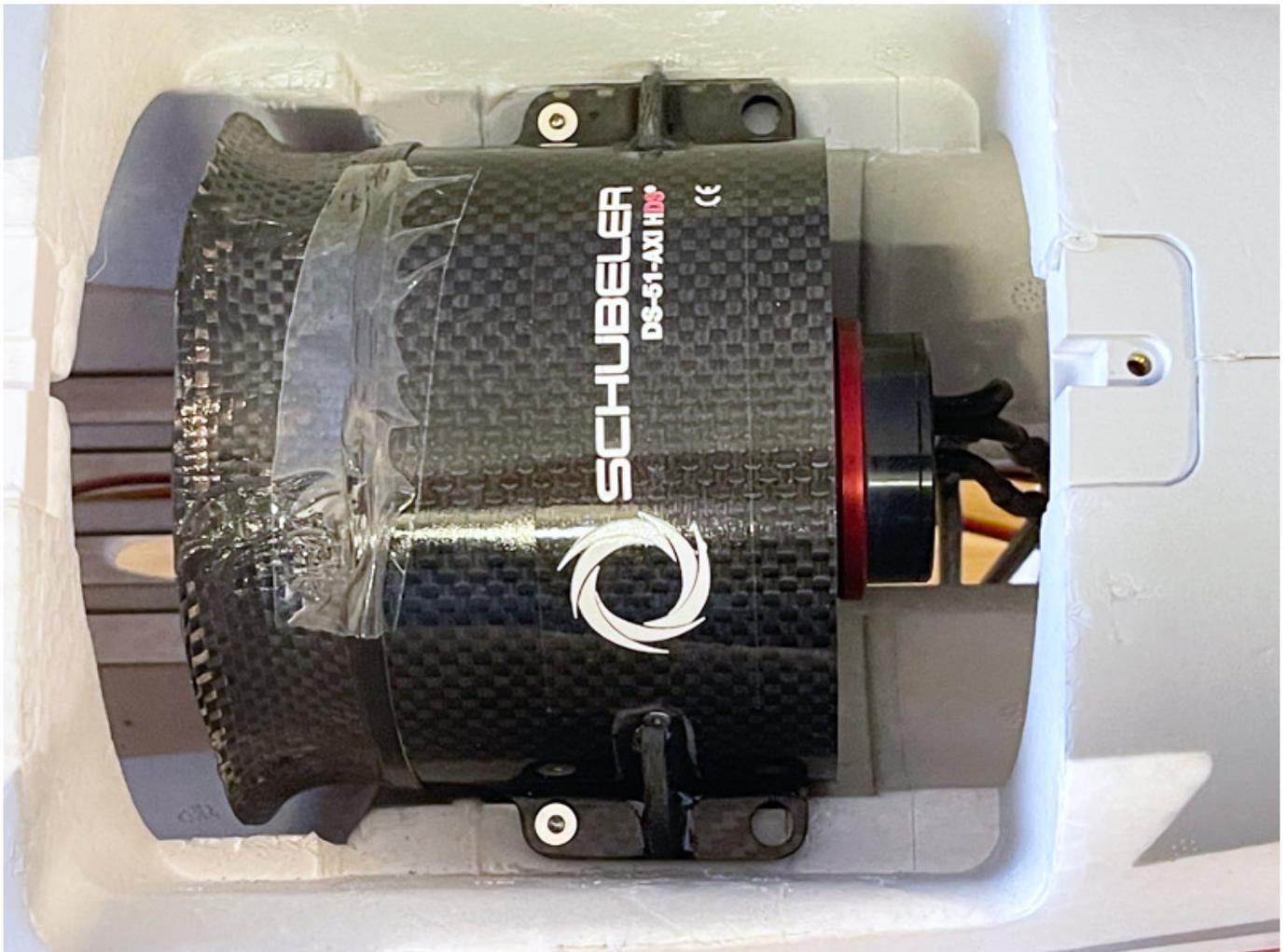
Der Impeller wird an den beiden vorderen Schraubpunkten (in Flugrichtung) befestigt. Zwei Schrauben reichen hier völlig aus da ja auch noch eine Fixierung durch die Impellerabdeckung erfolgt. Der Einlauftring wird mit Klebeband befestigt.
