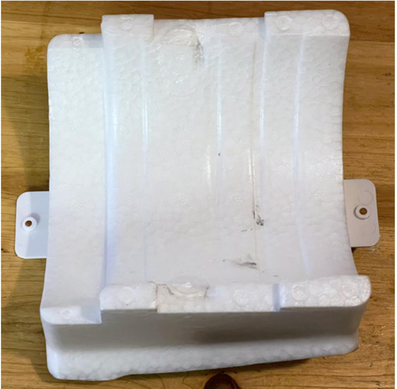
In die Abdeckung haben wir innen mit einem Skalpell, an den Stellen wo die Impeller-Verstrebung in Kontakt mit dem Schaum kommt, ein paar Schnitte gemacht, damit diese Verstrebungen da hereingreifen können. Mehr mussten wir an der Abdeckung nicht modifizieren.
