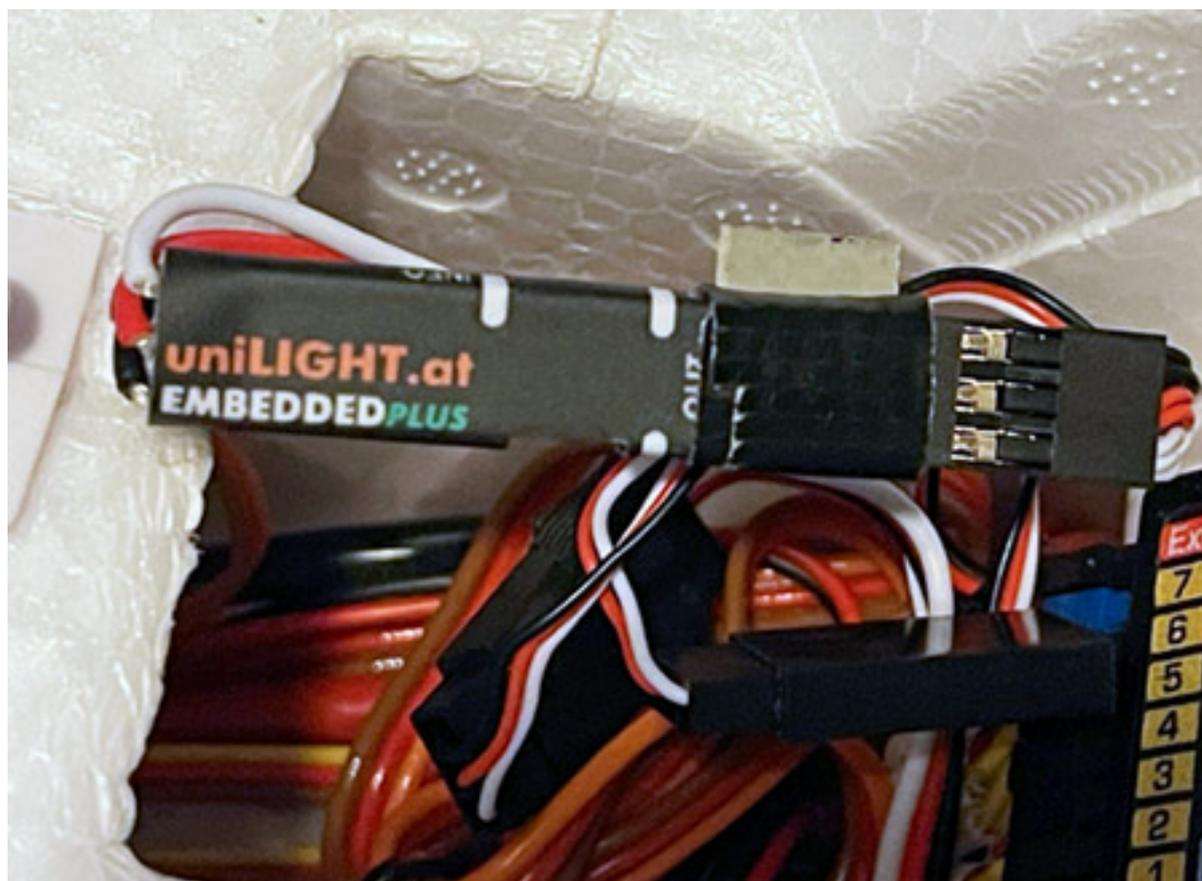
Was leider nicht geht ist, die Landescheinwerfer noch extra zu schalten, denn diese sind in den Flügeln des Modells mit den Positionslichtern fest verbunden und nicht auf getrennten Kabeln herausgeführt.
