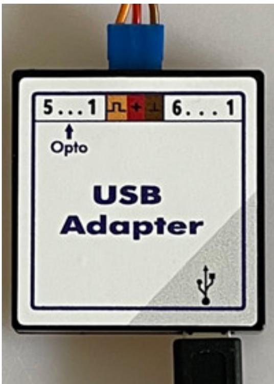
Der Regler lässt sich über eine Software programmieren. Ein USB-Interface hierfür wird direkt von YGE angeboten. Die Notwendigkeit viel einzustellen gab es aber nicht, denn die meisten Werte passten so ab Werk, Wir haben lediglich über die Programmierung den Telemetriemodus eingestellt und das Timing, wie vom Hersteller empfohlen, auf "automatisch" eingestellt. Weitere Informationen findet man auf der Seite von YGE: [www.yge.de](http://www.yge.de)
