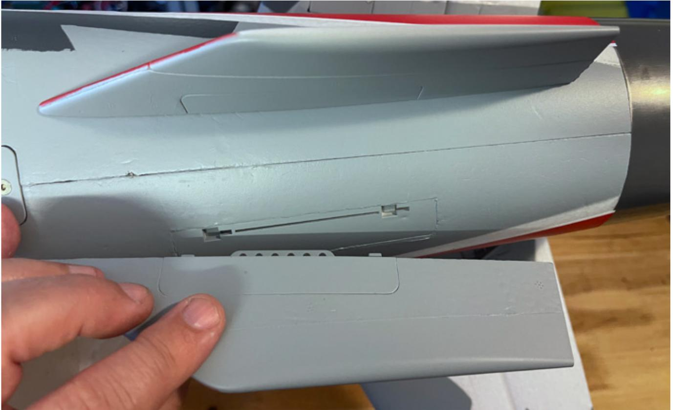
Das gleiche gilt für die Wingtips, die auch die Abdeckung für die Beleuchtung sind. Sollte man mal mit den aufgesteckten Wingtips irgendwo gegen kommen, so lösen sich diese, sitzen im Flug aber genügend fest.
