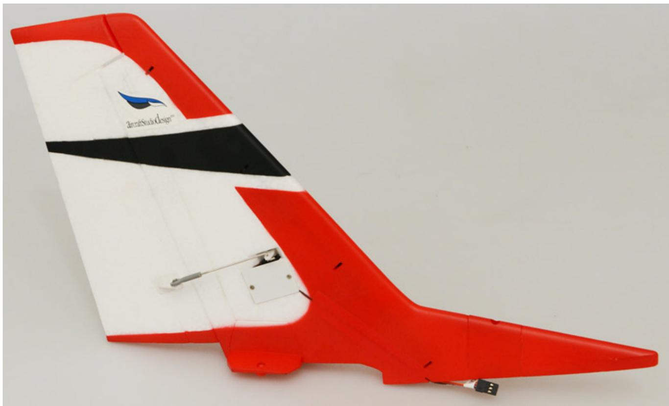
Nach Anstecken der Servo-Verbindungen werden die Leitwerke eingesteckt und mit fünf Innensechskant-Senkkopfschrauben befestigt.
