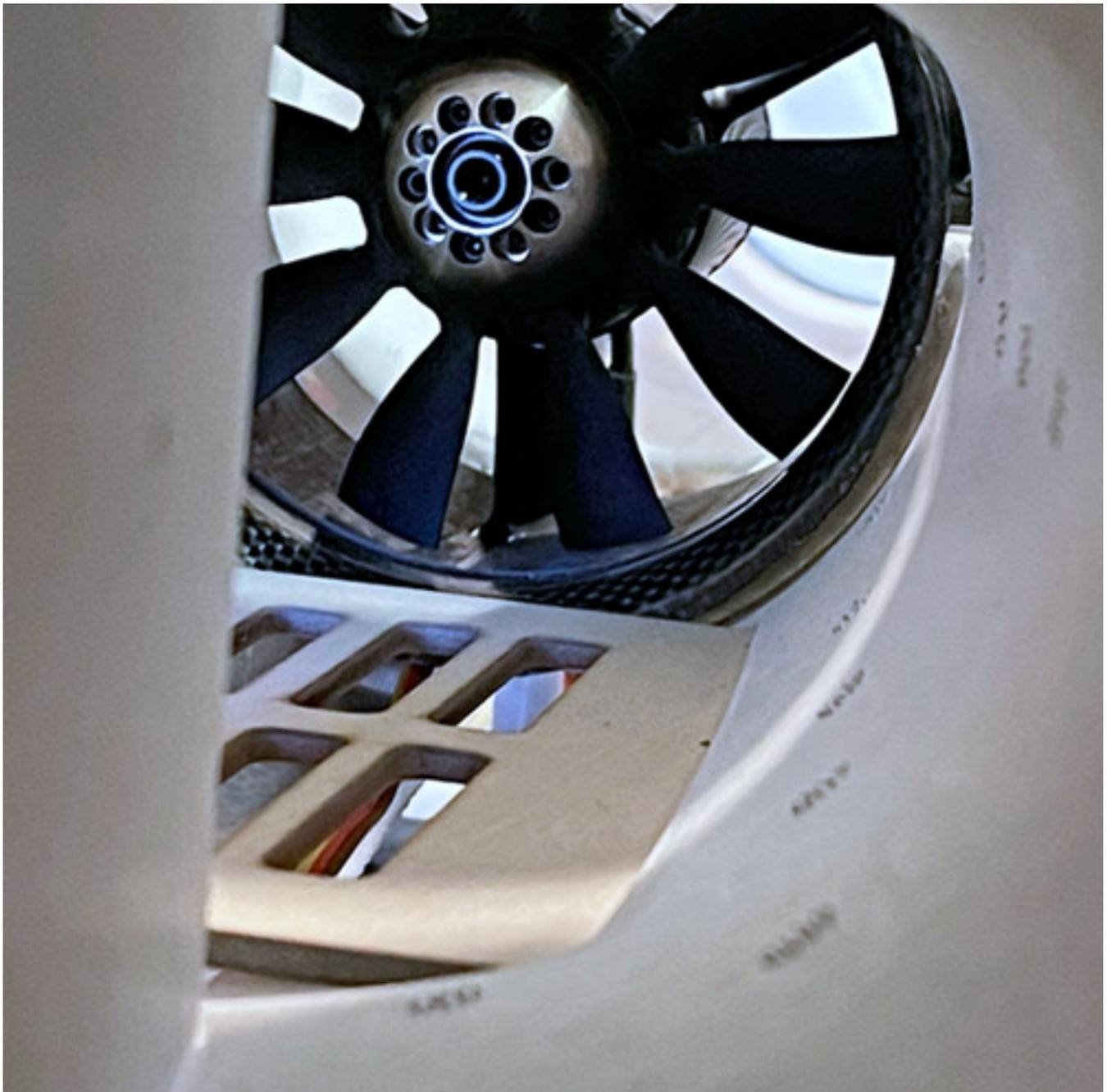
Man sieht im Foto, dass der Impeller (s. Abb. oben) nun sehr gut im Modell passt. Wir waren mit dem Kürzen des Rings sogar etwas zu großzügig. Man hätte noch etwas mehr stehen lassen können.
