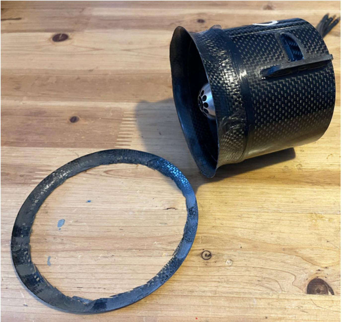
Den Einlaufring mussten wir etwas schmaler machen (s. Abb. oben), damit der Impeller mit dem Ring ins Modell passt. Das ist in kurzer Zeit mit einem Skalpell und etwas Schleifpapier, um den entstehenden Grad zu entfernen, schnell erledigt.
