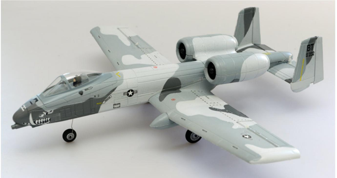
Ende 2016 wurde die UMX-Serie von E-flite um eine A-10 mit AS3X-Technologie erweitert, die wir hier vorstellen möchten. Die UMX A-10 ist mit einer Spannweite von 562 mm und 516 mm Rumpflänge das größte Impellermodell der UMX-Serie. Für die Größe ist das Modell sehr Scale-mäßig aufgebaut.
