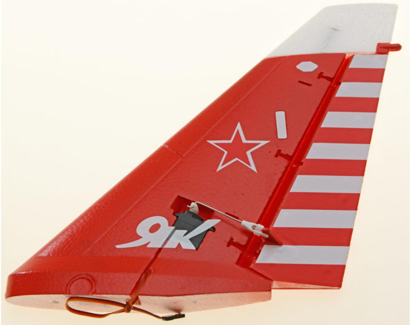
Als erstes wird das Seitenleitwerk befestigt. Hierzu muss man das Servokabel in das entsprechende Servo-Verlängerungskabel im Rumpf stecken, dann den Kleber im Rumpf aufbringen und das Seitenleitwerk einstecken. Dabei darauf achten, dass sich die Kabel im vorgesehenen Kabelkanal befinden.
