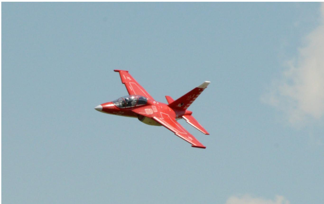
Das Modell ist in der Luft sehr gut zu sehen. Es lassen sich alle Jet-Kunstflugfiguren fliegen. Bei Vertikalfiguren sollte man nicht zu steil fliegen, damit die Strömung nicht abreisst. Die vom Hersteller angegebenen Ausschläge erscheinen mir zu groß, es sei denn man möchte Messerflug machen, denn dann benötigt man den in der Anleitung angegebenen Seitenruderausschlag.
