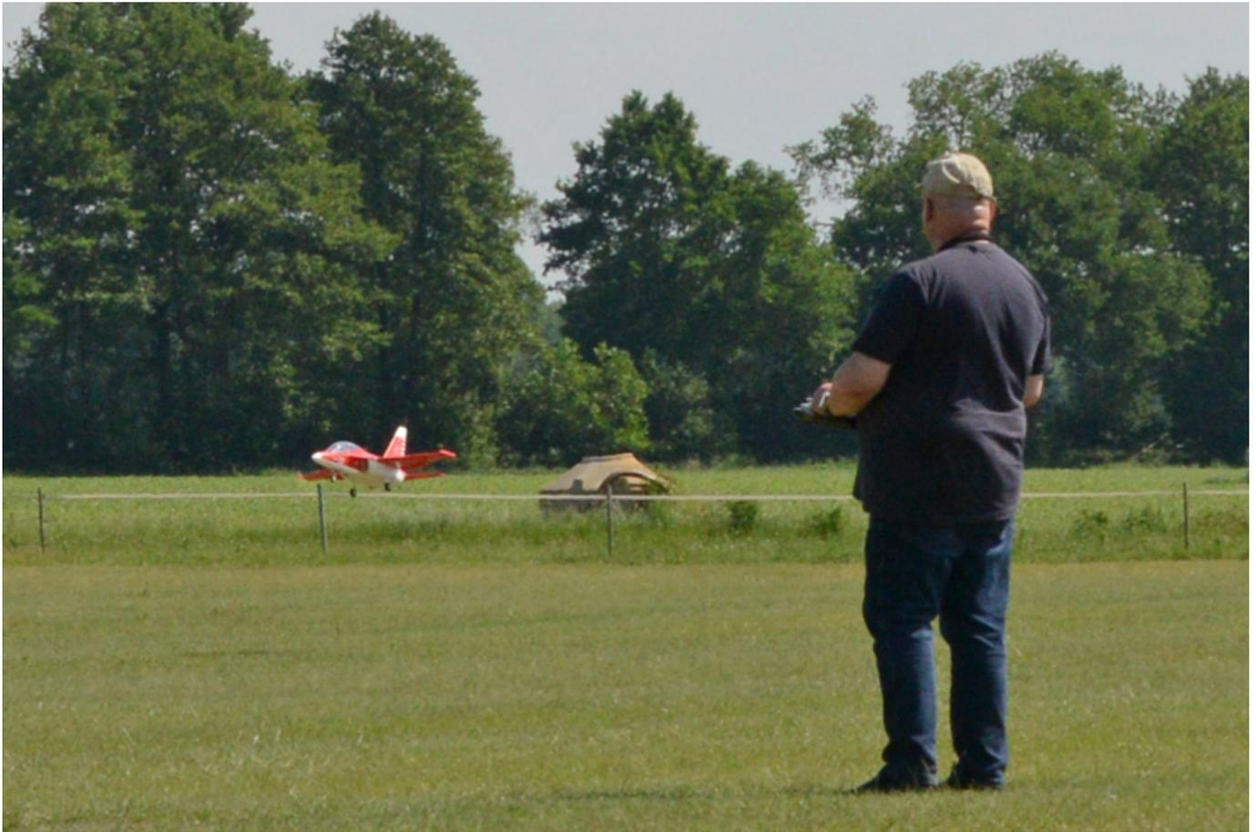
Die Landung gelingt sehr gut denn, wie man im Foto gut erkennt, lässt sich das Modell perfekt anstellen. Bei normalen Windverhältnissen landet man mit kleinen Klappenausschlägen. Ist das Modell zu schnell kann man in der Endphase der Landung mehr Klappen geben in dem man auf die zweite Position umschaltet. Selbst beim Rollen nach dem Aufsetzen kann man das Bugrad noch etwas in der Luft halten.
