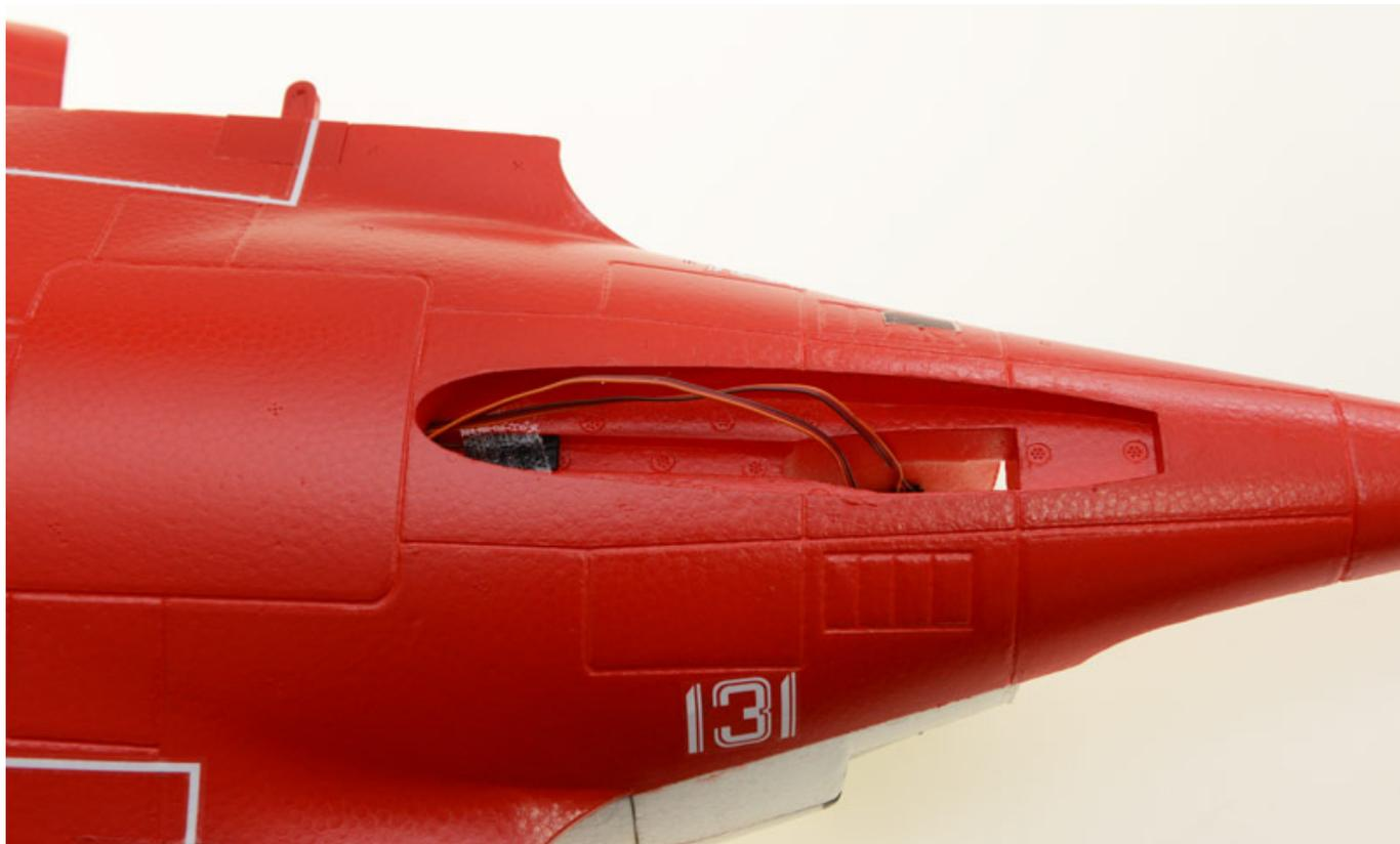
Als nächstes wird das Höhenleitwerkssegment montiert. Auch hier werden als erste die beiden Kabel der Servos an den Verlängerungskabel angeschlossen. Der Kleber wird dazu auf die entsprechenden Stellen auf der Rumpfunterseite aufgebracht.
