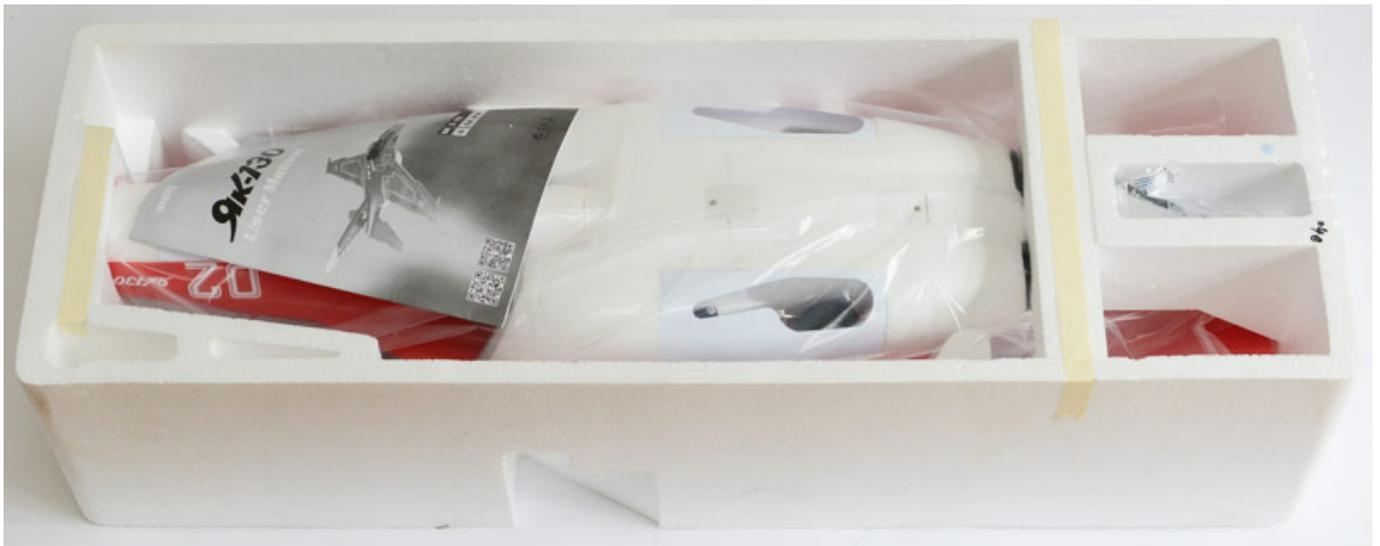
Wir haben die PnP-Version (Plug-and-Play) mit 4-S-Antrieb getestet. Im Lieferumfang dieser Version befindet sich eine komplett vorgefertigte Rumpfschnecke mit fertig eingebautem elektrischem Einziehfahrwerk, 70-mm-Impeller mit Freewing-Motor mit 2.850 kv und 60-Ampere-Regler mit BEC. Bei der 6-S-Version ist ein Sechsstab-Impeller mit einem Motor mit 2.200 kv und ebenfalls einem 60-Ampere-Regler verbaut.
