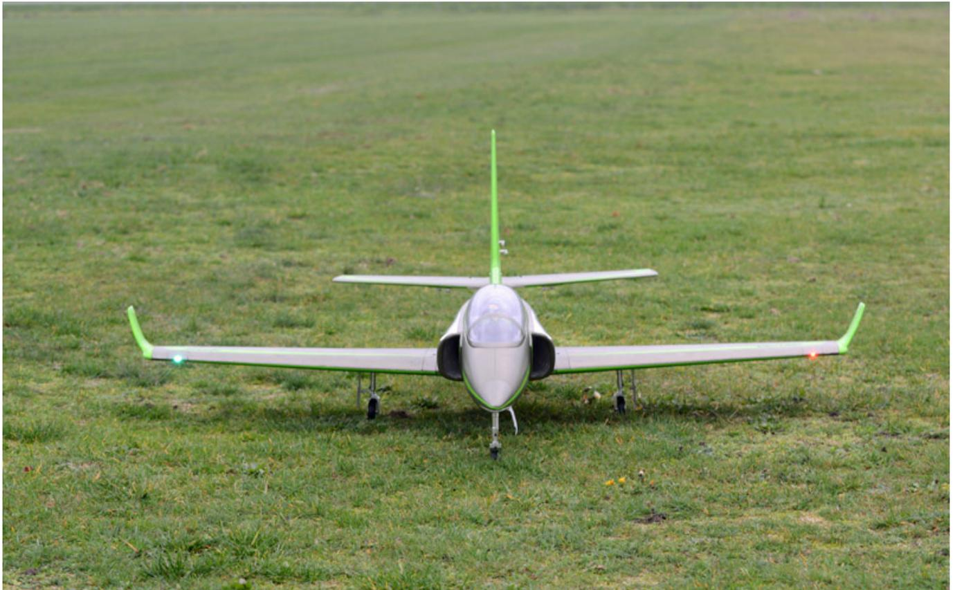
Aufgrund der zuvor aufgezeigten Leistungsbilanz haben wir uns entschlossen beim Start ca. 35 % Klappen zu setzen. Für die Landung haben wir ca. 75 % Klappen, bezogen auf den maximal möglichen Ausschlag, gewählt.
