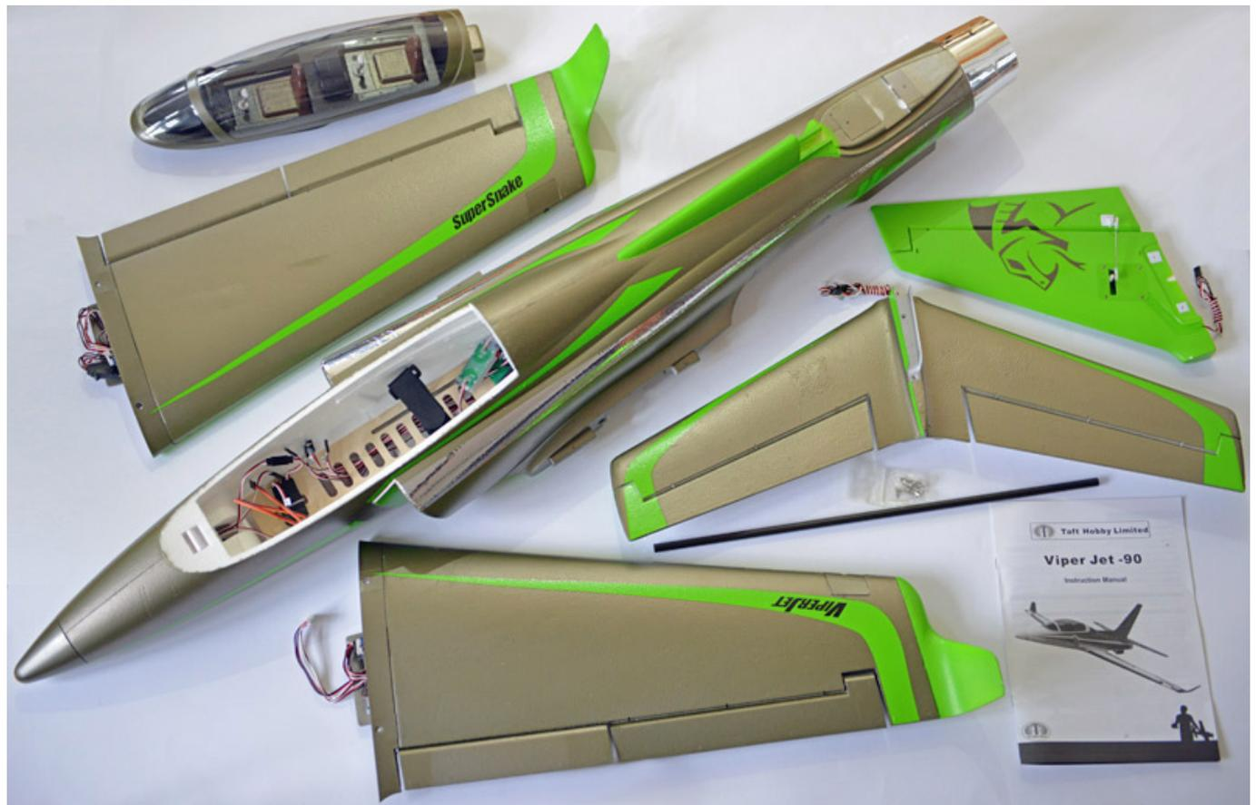
Schon der erste Blick offenbart den hohen Vorfertigungsgrad. Geliefert wird der fertige Rumpf, Höhenleitwerk, Seitenleitwerk, zwei Flächenhälften, Cockpit, CFK-Stab für die Flächensteckung, Kleinteile sowie eine englischsprachige Anleitung. Diese ist allerdings doch sehr knapp gehalten und einige wichtige Informationen werden dem Modellpiloten vorbehalten. Daher möchten wir hier einmal die einzelnen Bauschritte Step-By-Step aufzeigen.
