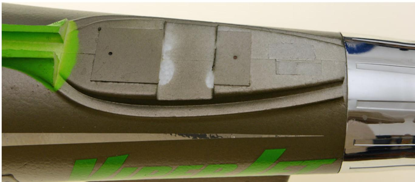
Höhen- und Seitenleitwerk sind komplett montiert und die Servos sind bereits eingesetzt und angelenkt. Die drei Servokabel muss man als erstes durch den vorgesehenen Kabelkanal ziehen. Am einfachsten geht das mit einem steifen Draht, den man an den Servosteckern befestigt und den Draht dann durch den Rumpf schiebt und die Servokabel dann durchzieht.
