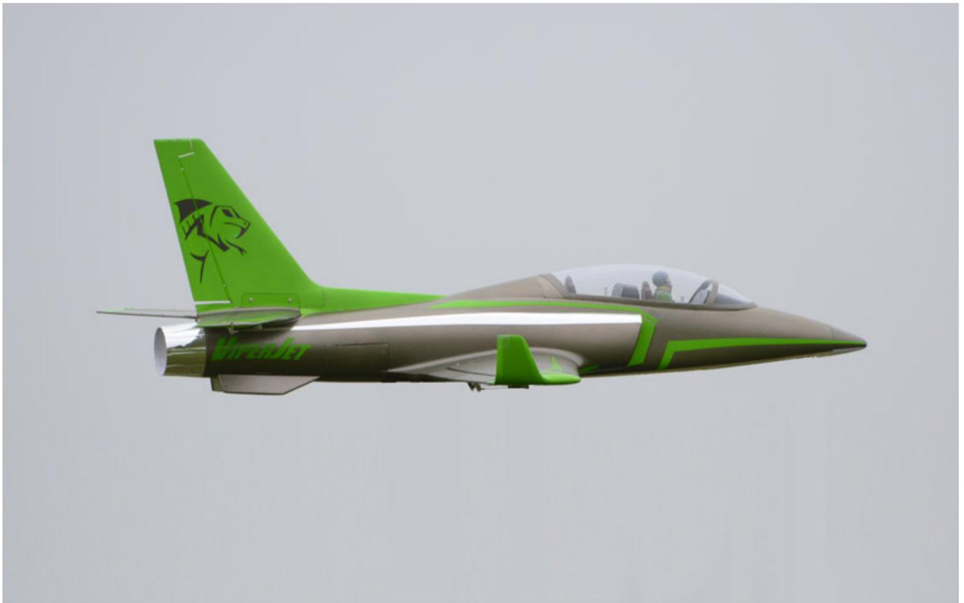
Es zeigte sich auch, dass die erst zu für groß gehaltene Ausschläge sich als optimal erwiesen und wir die programmierte Low-DualRate für normalen Flug nicht benötigten. Die Steuerung des Jets ist dabei wirklich sehr präzise und dass in allen Fluglagen. Ein Verwinden der Ruder oder Leitwerke - wie man sie oft bei Schaumjets feststellen muss - konnte nicht festgestellt werden.
