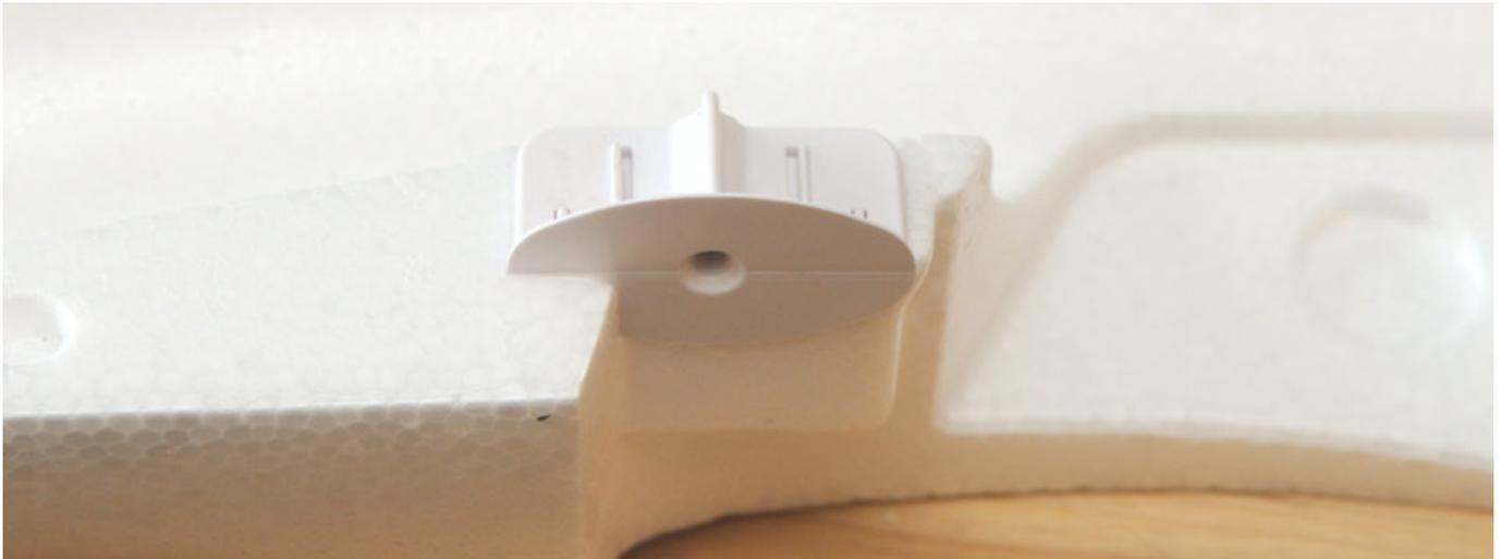
Nun muss man vor dem Verkleben der beiden Rumpfhälften den Schwerpunkt überprüfen. Hierzu Rumpf mit Tesastreifen provisorisch zusammenfügen, Akku einbauen und auf Schwerpunkt auswiegen. Bei Verwendung des von Graupner vorgeschlagenen Antriebs und Akkus müssen hinten beide Trimmgewichte von zusammen 50 g eingeklebt werden (s. unten).
