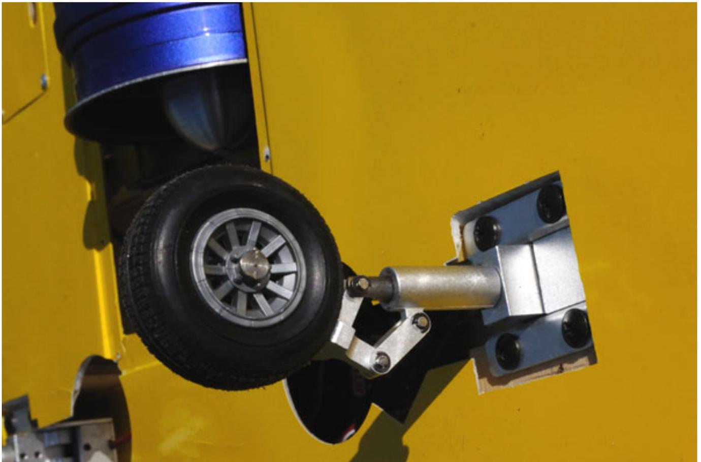
Die mögliche Länge der Federbeine ist konstruktiv begrenzt. Die gelieferten RCLander Fahrwerksbeine haben von der Länge gerade so gepasst. Es musste nur ein wenig von der Triebwerksverkleidung entfernt werden.
