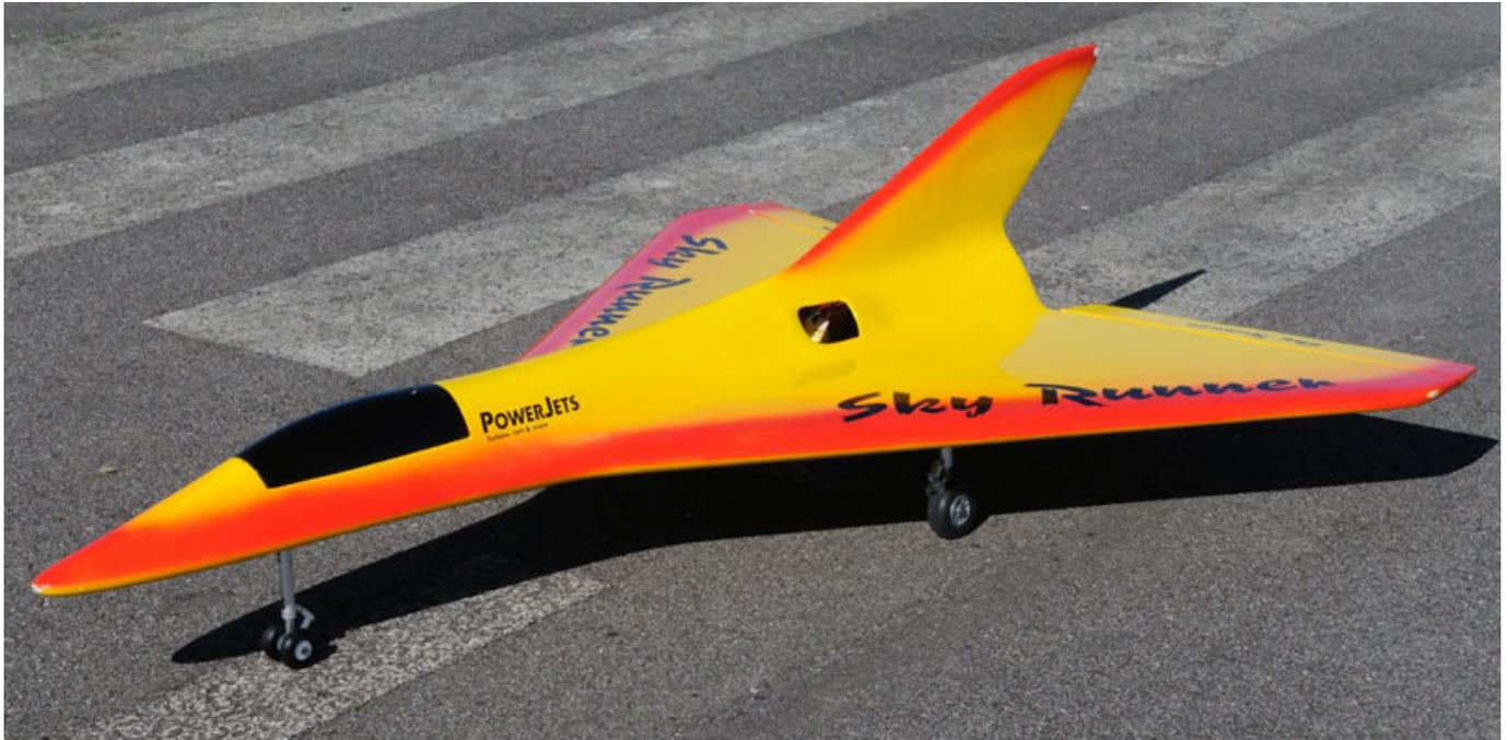
Die Startstrecke beträgt daher ca. 60 Meter. Bedingt durch die Öffnung des Impellers am Unterboden des Modells saugt sich dieses ein wenig beim Starten am Boden fest.
