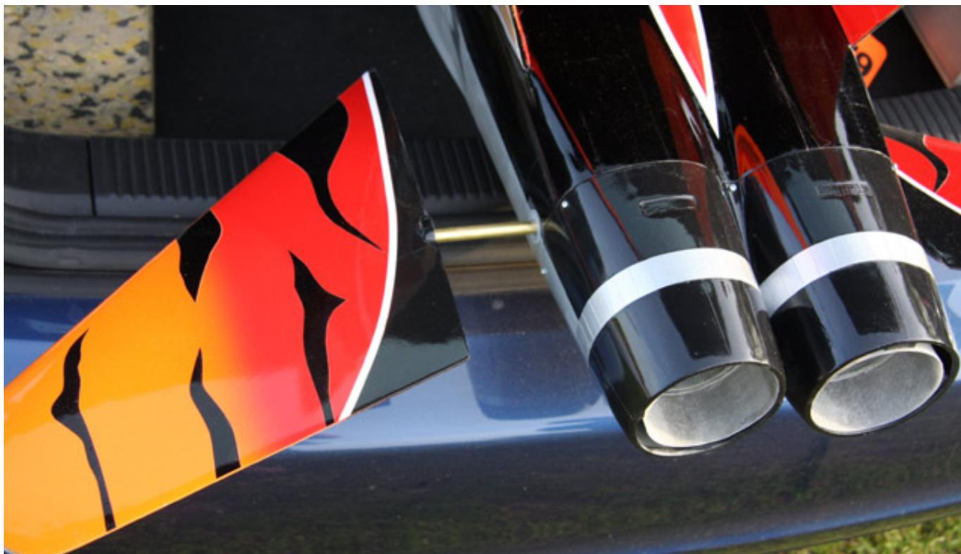
Hier sieht man ein gelöstes Messingrohr des Tailerons. Dieses war leider nicht korrekt verklebt und steckte nach dem Transport ohne Taileron im Rumpf. Zum Glück ist das Problem vor dem Erstflug aufgetreten.
