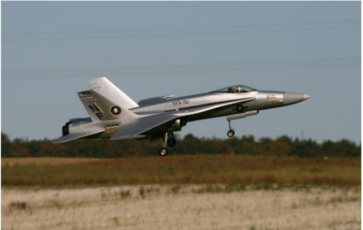
Bei der Landung kann man sie durch das Anstellen auch genügend langsam für die Landung machen. Z. B. im Verhältnis zu Rafale von aeronaut ist die F-18 leichter zu landen. Sie wird auch schneller langsam im Landeanflug und muss in der Regel mit etwas Schlepptgas angefliegen werden.
