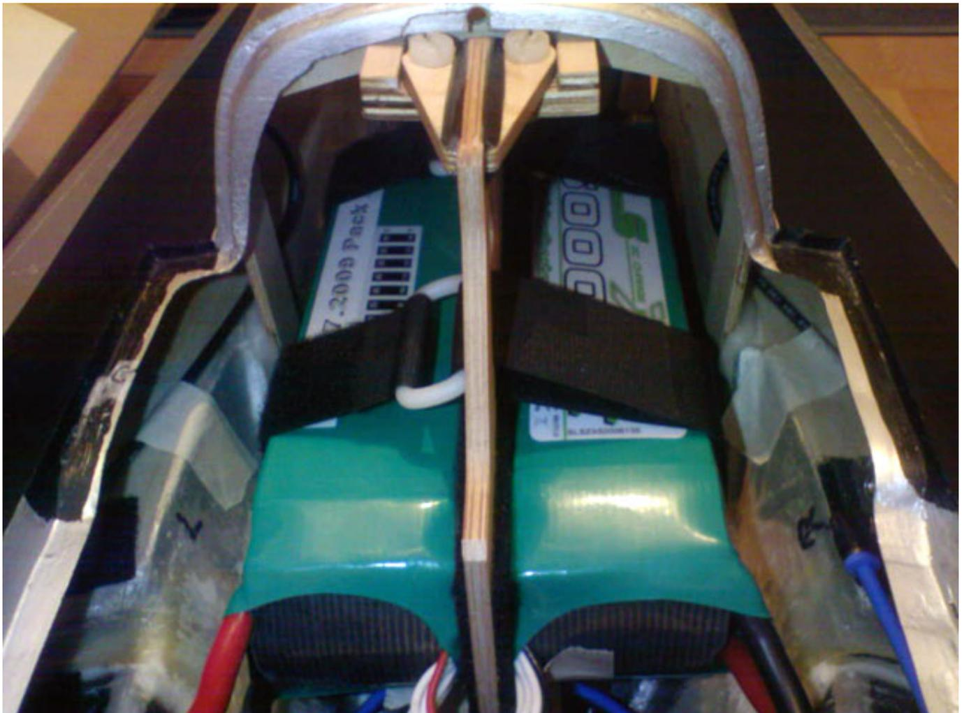
Die Empfängerstromversorgung erfolgt bei dem Modell von Steffen über ein Emcotec DPSI Micro DualBat 5,5V/5,9V mit zwei SLS 2S EP 500 mAh Lipos.
