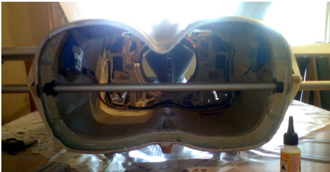
So sieht dann eine der fertigen Lagerstellen eingeklebt im Rumpf aus.
