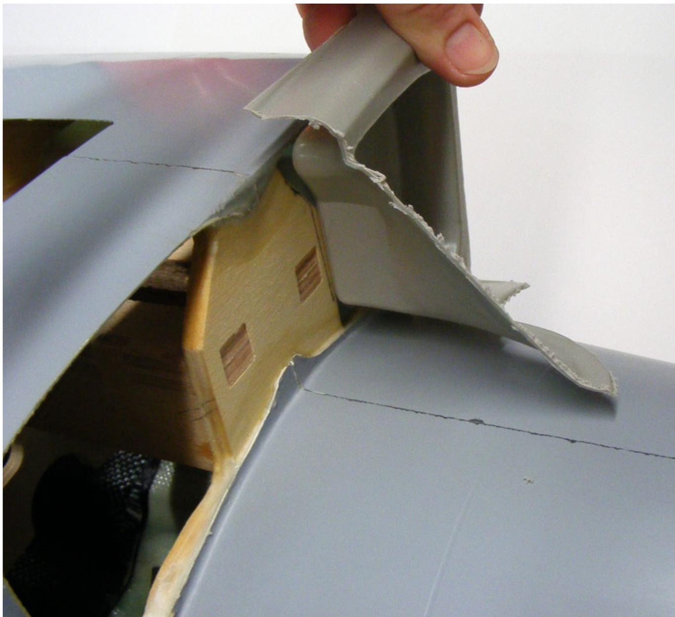
In der Zwischenzeit wurde das ABS Formteil in der Mitte durchgeschnitten und siehe da es passt in die Öffnungen. Dass es noch entsprechend angepasst werden muss versteht sich natürlich von selber.
