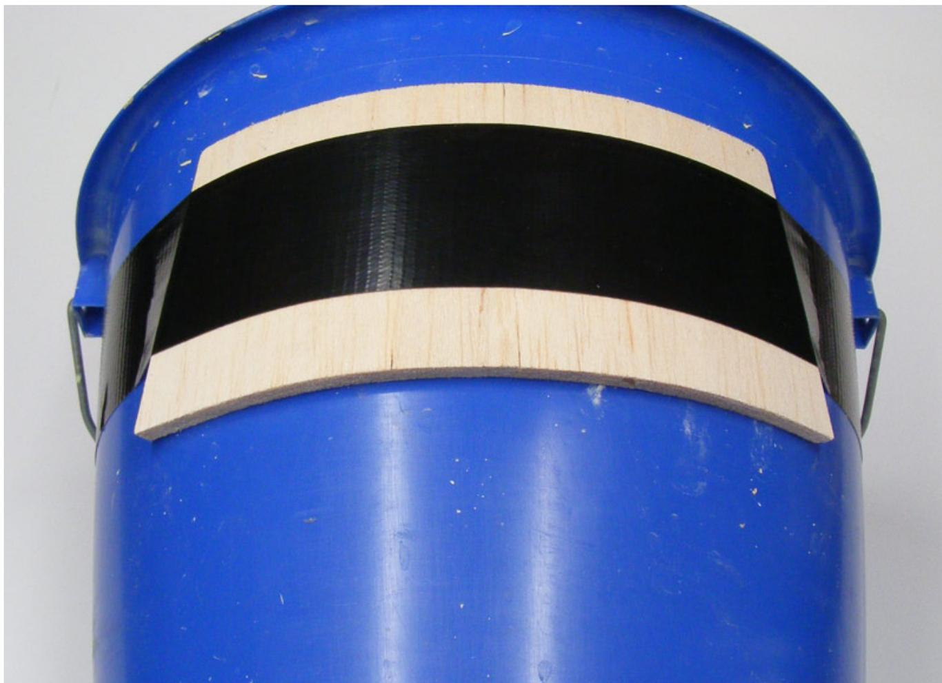
Ein kleiner Tipp zum Schleifen: Am besten gelingen solche Schleifvorgänge, wenn das zu schleifende Material mit Teppichklebeband auf einer Platte am Rand festgeklebt wird. Sollte sich das Lösen als etwas widerspenstig herausstellen, kann der Kleber mit etwas Aceton gelöst werden.
