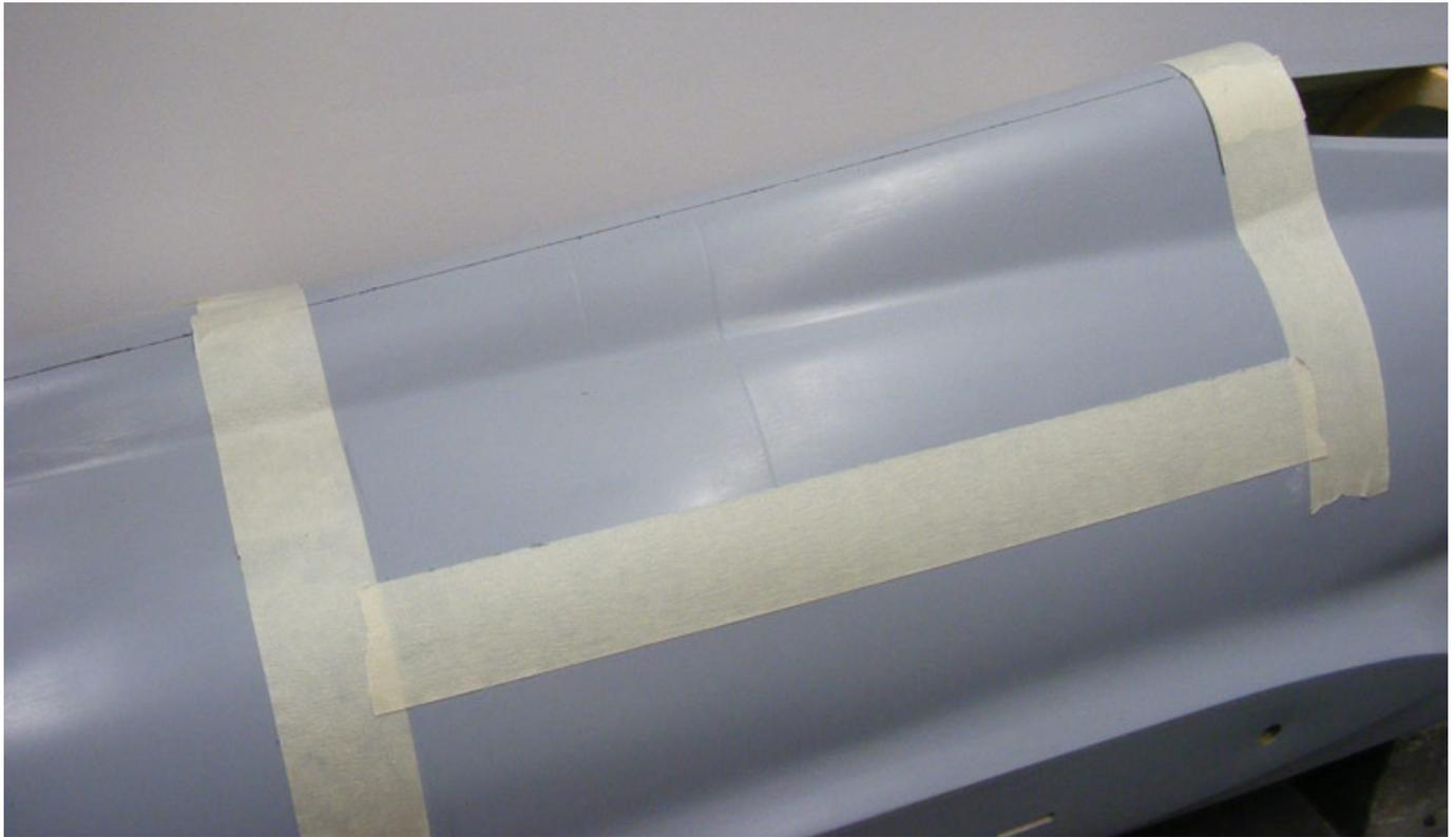
Nachdem das Laminat getrocknet war, konnte der Ausschnitt am Rumpfrücken erfolgen (s. Abb. oben). Obwohl der Rumpfdeckel durch die Kohlefaser schon recht stabil geworden ist, entschied ich mich für das Anbringen von kleinen Rumpfspanten, die die Kontur stabil halten sollten.
