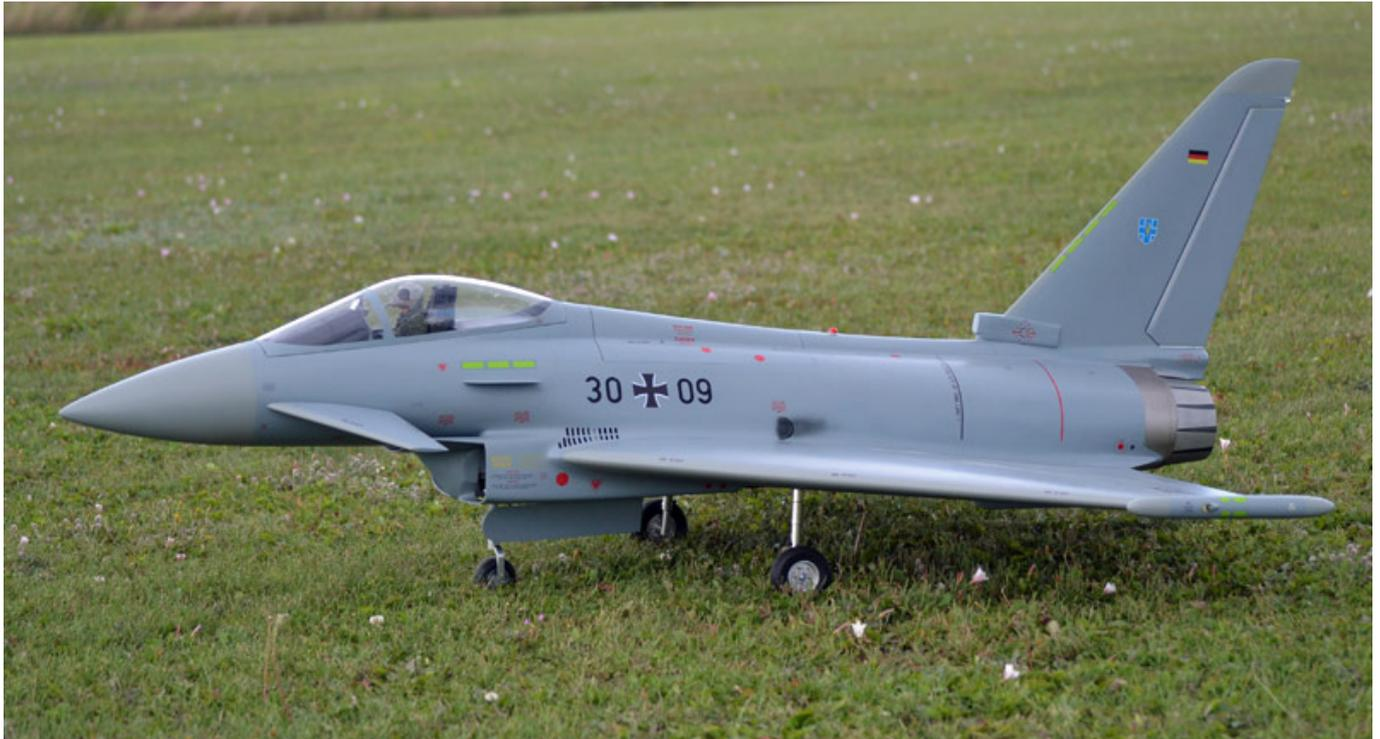
Der Eurofighter 1:10 von Grumania ist ursprünglich für eine kleine Turbine vorgesehen aber die Modellgröße und der Aufbau ist ideal für den die Impellerumrüstung. Der Grumania Eurofighter Modell selbst ist Semi-Scale, da nicht alle Proportionen dem Original entsprechen.
