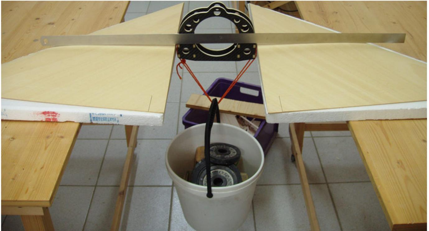
Die Impellerhalterung wurde in den Rumpf eingeleimt. Außerdem wurde im Rumpf die Lagerung für die Tailerons und die dazu gehörige Servohalterung realisiert.
