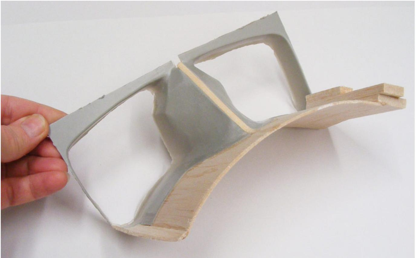
Der nun entstandene Spalt zwischen den beiden Hälften wurde durch ein Dreieck aus 5-mm-Pappelsper Holz ausgefüllt und dient gleichzeitig als Schutz bei Boden-/Fremdkörperkontakt. Nachdem der Grenzschichtzaun getrocknet ist wurde er mehrmals mit Nitro-Schnellschleifgrund behandelt und nicht mit Glasfasergewebe behandelt, da die Ecken noch nach der Montage etwas dem Rumpf angepasst werden mussten.
