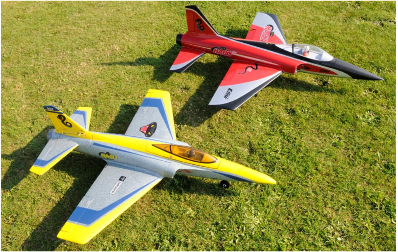
Der Habu 32 von E-flite ist eine konsequente Weiterentwicklung des Parkzone Habu. Sicherlich hätte man sich ein vielleicht größeres Modell und eine geringere Flächenbelastung gewünscht denn der Habu 32 wiegt ja mehr als das Doppelte bei lediglich zehn Prozent größerer Flügelspannweite. Aus diesem Grund ist der Habu 32 auch kein Einsteigermodell. Eine sichere Beherrschung eines Schaum-Habu ist die Mindestvoraussetzung für das Fliegen mit dem Habu 32.
