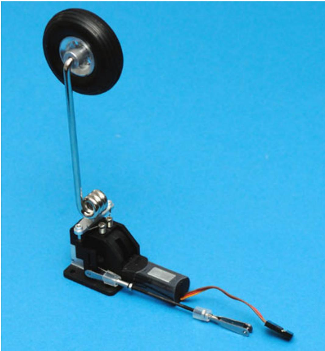
Vorne im Rumpf ist eine Abdeckung die gelöst werden muss und man kann dann relativ einfach Bugfahrwerks-Servo und Anlenkung sowie die Bugmechanik einbauen.
