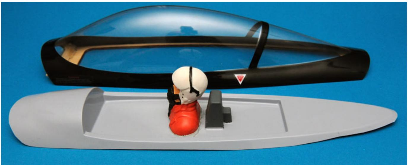
Zur Fertigstellung der Kabinenhaube bedarf es lediglich des Zuschneidens des Boden-Tiefziehteils und wenn man möchte noch das Festkleben der Pilotenbüste. Am Rumpf ist die Hauben-Arretierung auch schon ab Werk montiert. Optional kann man einen Piloten einkleben (haben wir mit Beli-Zell erledigt) und den Sitz noch farblich absetzen.
