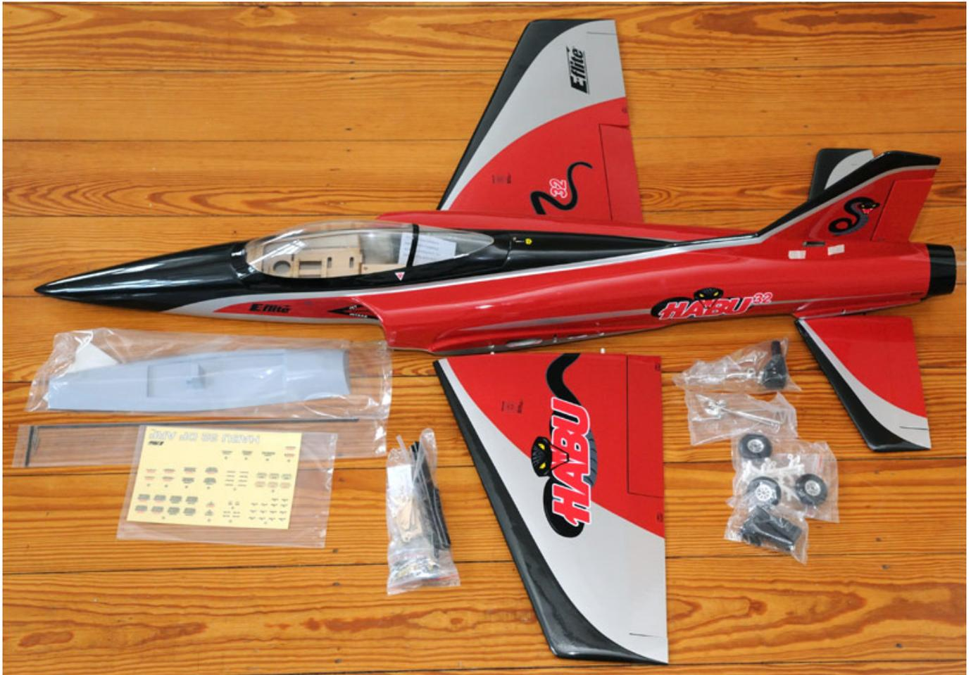
Die Bespannung mit Bügelfolie des Flügels und Höhenleitwerks ist exzellent ausgeführt. Auch die Lackierung ist von der Verarbeitung her sehr gelungen. Beim Testmodell war nur an einer Stelle ein kleiner Lacktropfen sichtbar. Weiter gehören Kabinenhaube und Kabinenboden-Tiefziehteil, festes Fahrwerk mit Rädern (Gummi mit Alufelgen) und sämtliches Kleinmaterial, wie Schrauben und Anlenkungen zum Lieferumfang.
