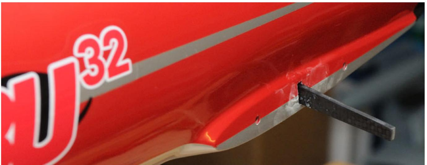
Die Höhenruder-Servos werden rechts und links neben dem zukünftigen Platz des Impellers eingebaut und über lange Stangen angelenkt. Die Stangen laufen in einem Kunststoffröhrchen, welches an mehreren Stellen am Rumpf befestigt ist und so für eine präzise Steuerung der Höhenruder sorgt.
