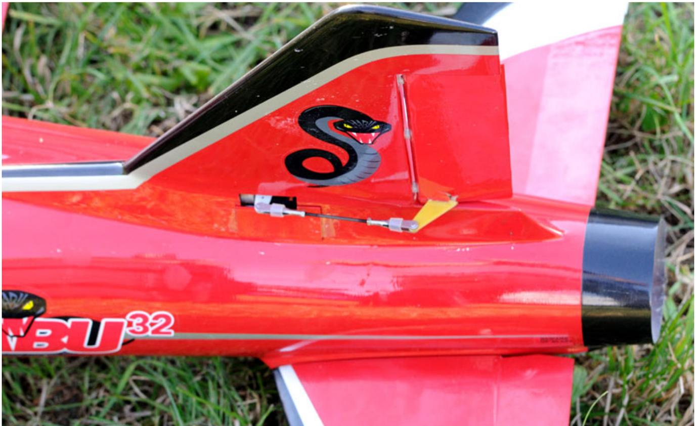
Das Höhenleitwerk ist wieder steckbar ausgeführt und zwar auch wieder mit einem CFK-Teil was in die vorbereitete Tasche im Leitwerk geklebt und dann über zwei Schrauben und einem Aluminiumblock befestigt wird. Gleiche Strategie auch wieder beim Einkleben des CFK-Teils.
