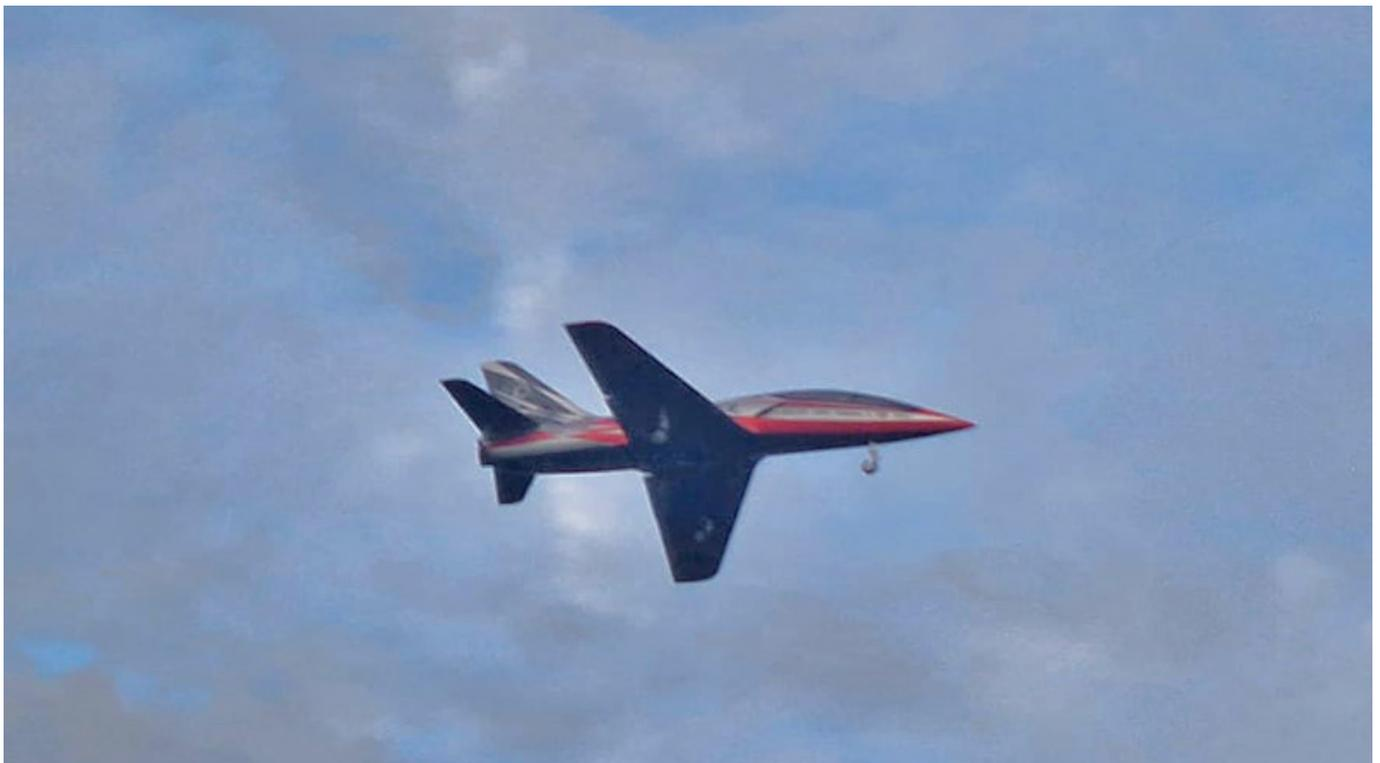
Der Erstflug erfolgte problemlos mit ein zwei Tacken Querrudertrimmung. Dank vollgesetzten Klappen gleitete der Jet zur Landung problemlos aus mittlerer Höhe auf den Rasen und verlor dabei deutlich an Geschwindigkeit, blieb aber stabil. Die Ruderausschläge wurden anhand der Vorgaben in der Anleitung von CARF eingestellt.
