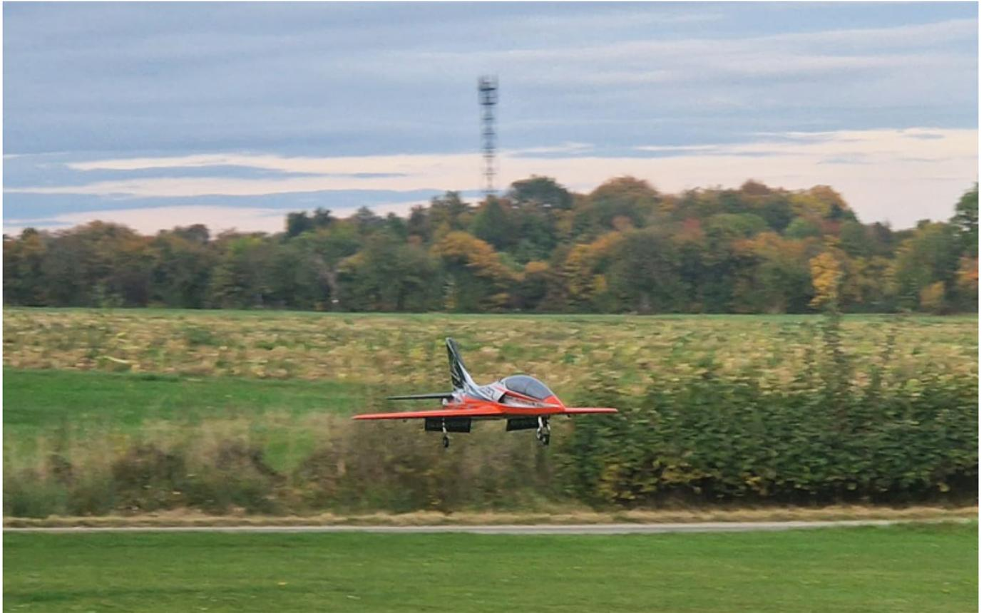
Der Rebel Classic fliegt wie der kleine Bruder Hot einfach genial, wobei größer noch etwas mehr Spaß macht und etwas stabiler bei der Landung ist. Die 14 S 8.000-mAh-Akkus bringen je nach Gas-Management eine Flugzeit von fünf bis sechs Minuten zustande.
