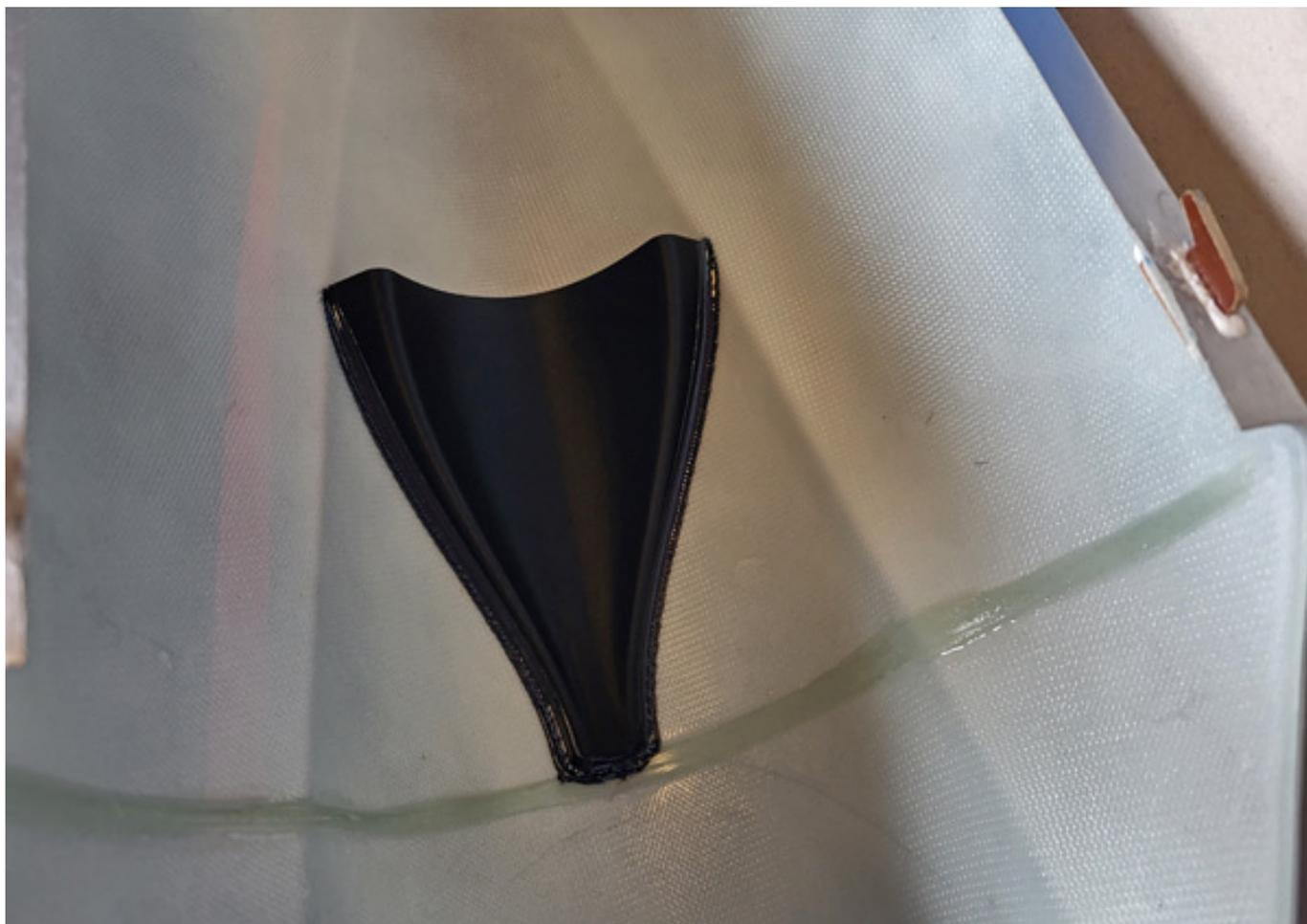
Um die Anströmung der Luft so früh wie möglich zum Impeller leiten zu können, habe ich links und rechts Ausschnitte im Bereich der Lufteinlässe gemacht. Strukturell für das Modell kein Problem. Eine Seite angezeichnet, eine Schablone erstellt und gespiegelt auf der anderen Seite angezeichnet und mit einem Dremel ausgeschnitten.
