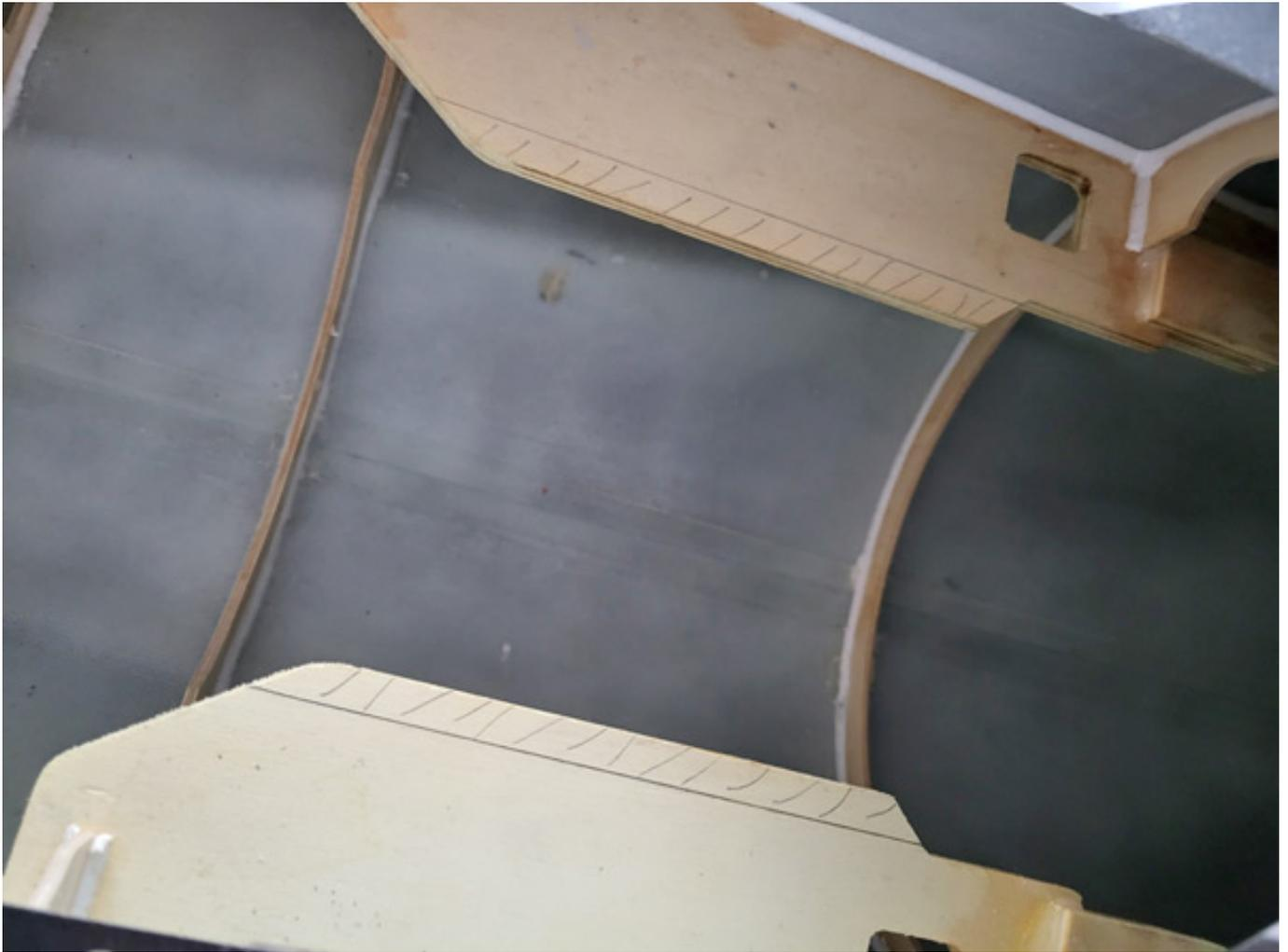
Um den Impeller montieren zu können muss der vorhandene Turbinenspannt im Ausschnitt etwas verbreitert werden. Danach wird der Impeller einfach mit vier Schrauben im Holz befestigt. Als Schrauben habe ich 4 x 25 mm Visaton-Zylinderkopfschrauben verwendet. Diese dienen auch zur Befestigung der Fahrwerksmechaniken.
