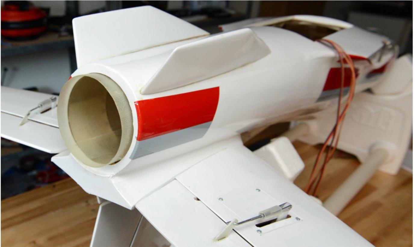
Das sollte man allerdings erst später machen denn es kann ggf. Ausgleichgewichte zum Schwerpunktausgleich erforderlich werden, den man am besten hinten unter dem Endrohr einklebt. Die Düse selbst sollte man übrigens nicht mit Epoxy verkleben sondern lediglich mit ein paar Tropfen Kleber wie UHU por fixieren und außen dann noch mit etwas Tesafilm sichern.
