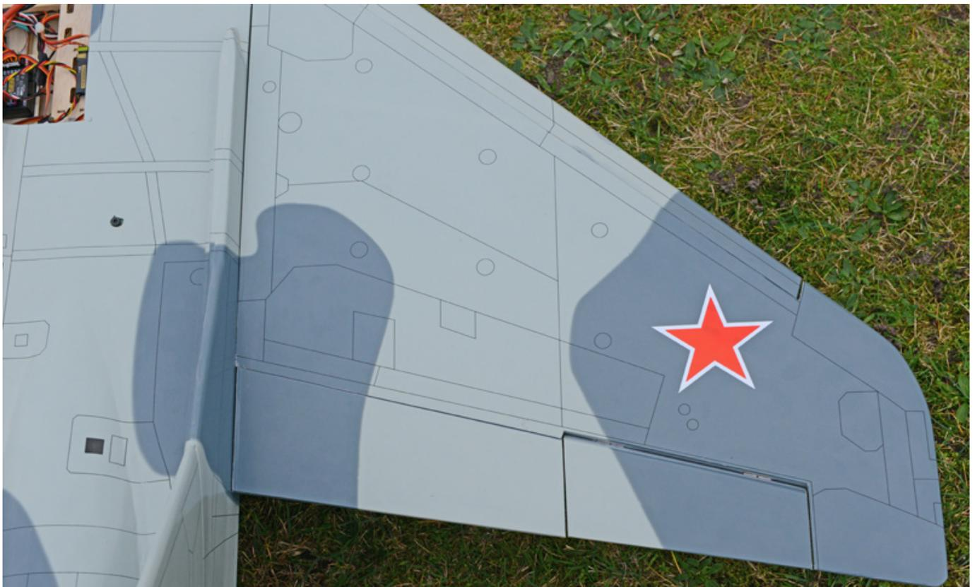
So mancher wird sich an dieser Stelle über die drei Servos wundern. Es ist so, dass pro Flügel ein Querruder, eine Landeklappe und auch noch eine funktionsfähige Vorklappe vorgesehen sind. Die Vorflügel nehmen ca. 3/4 der Vorderkante ein.
