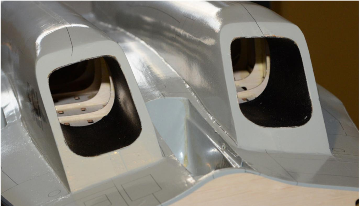
Schon den Prototyp hatten wir mit Einlaufkanälen aus 0,5 mm dicker PVC-Folie versehen. Dazu benötigt man zwei 460 \* 330 mm große Stücke, die man aufrollt und dann in den Kanal schiebt. Die Lücke zwischen Impeller und dem ggf. nachträglich eingesetzten Einlaufrohr kann einige Zentimeter betragen.
