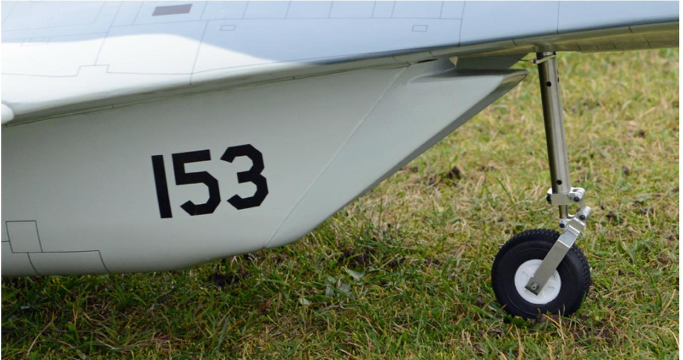
Zum Betrieb benötigt man drei Hauptfahrwerke. Das Bugradbein wird nach der Radmontage in das elektrische Fahrwerk gesteckt und wird mit einer schon am Fahrwerksbein montierten Feder gesichert.
