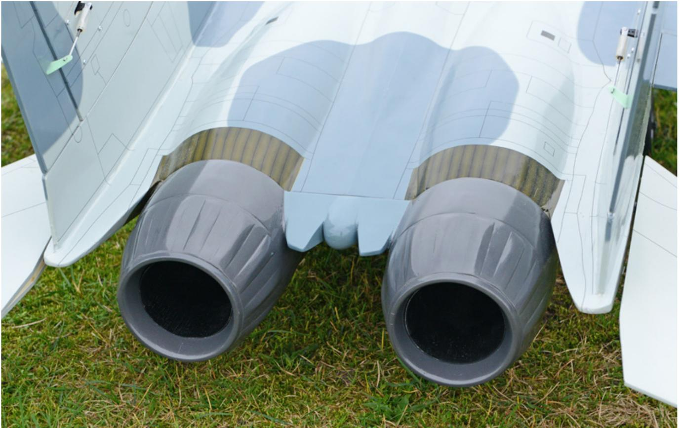
Nun muss man die Düsenabschluss noch befestigen. Vorgesehen ist hier ein stumpfes Verkleben mit dem Rumpf. Die Löcher für die Fixierung im Holz waren bei dem Testmodell etwas klein und mussten leicht vergrößert werden. Wer auf Wartungsfreundlichkeit Wert legt, sollte den Düsenabschluss ggf. nicht verkleben sondern darüber nachdenken, die Befestigung über eine Verschraubung zu realisieren.
