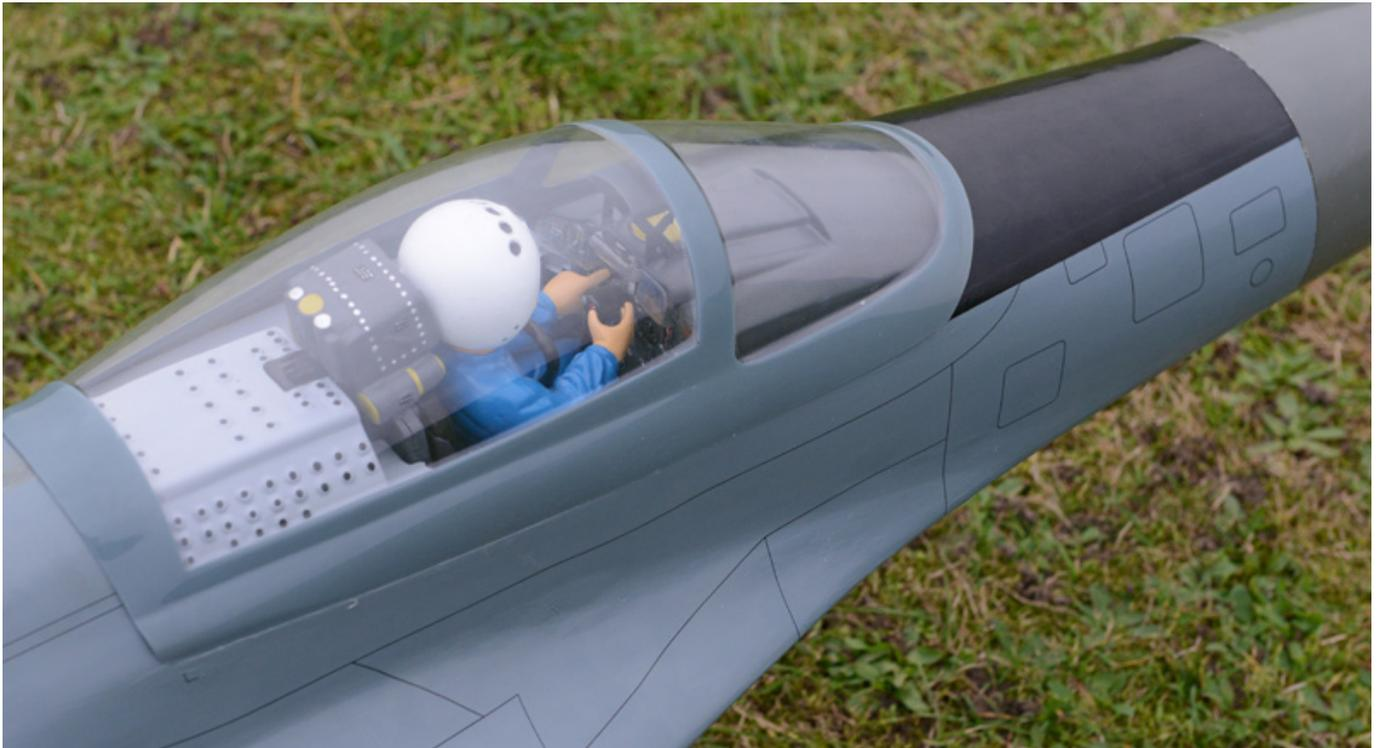
Das wirklich sehr detaillierte Cockpit ist weitgehend vorgefertigt. Man muss nur noch den Pilot einsetzen und ankleben und die Kabinenhaube befestigen. Dies erledigt man am besten mit hochtransparentem (nicht matt) Tesafilm.
