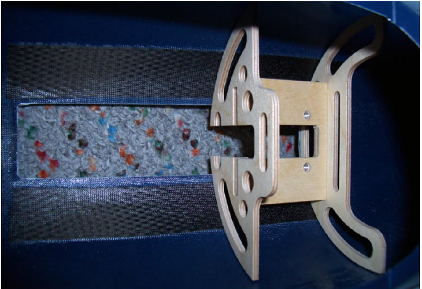
Das Hosenrohr ist bereits ab Werk im Rumpf eingebaut (s. Foto unten).
