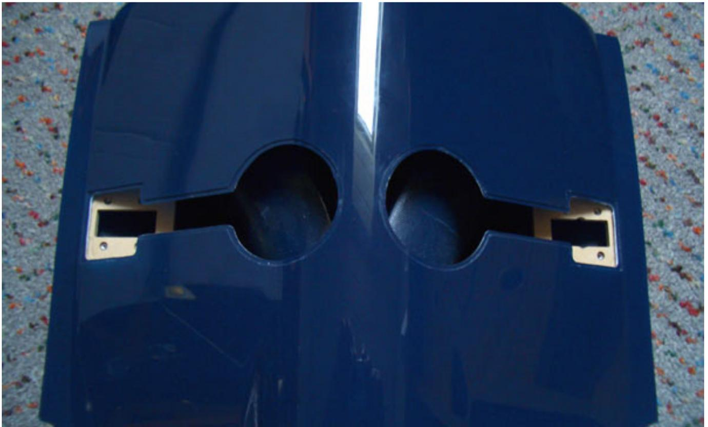
Auf diesem Foto (unten) sieht man die eingebauten Spannten für die Aufnahme des Bugfahrwerks. Dahinter liegt die Akkurutsche und dahinter ist dann das Bugfahrwerks-Servo angebracht.
