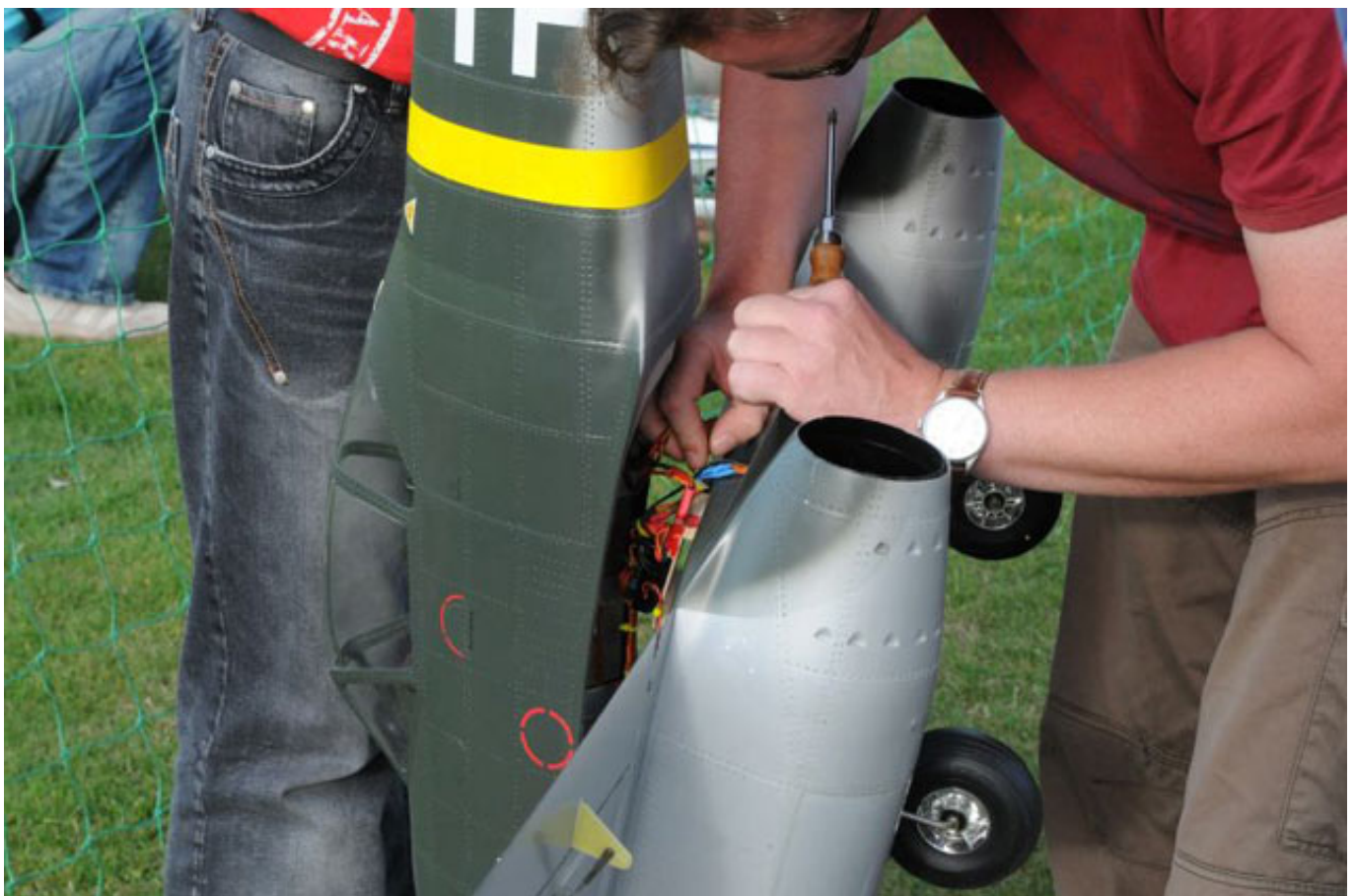
Hier sieht man das Anstecken der Rumpfservos bei der Flächenmontage.
