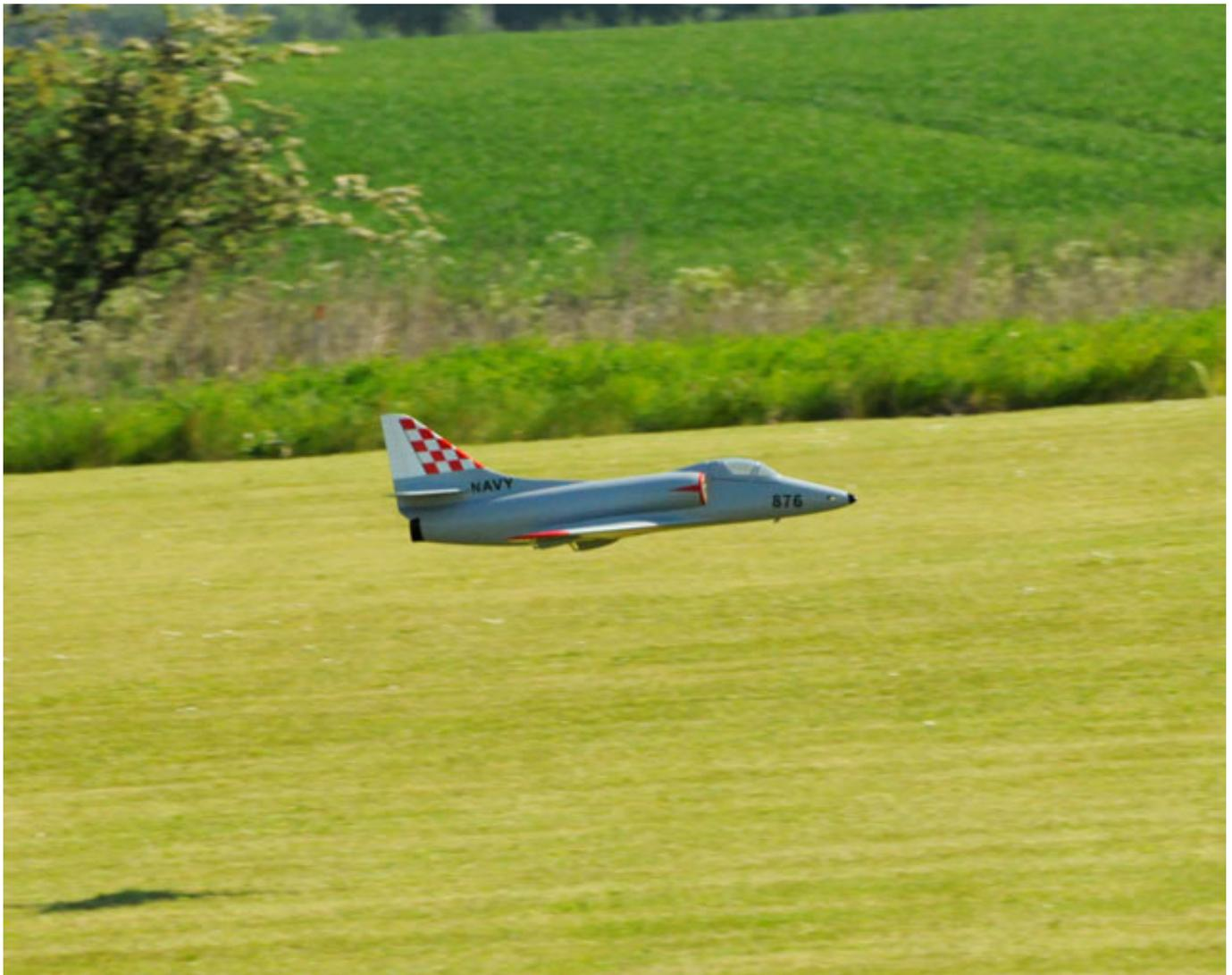
Mit den 4-S-Akkus ist die Geschwindigkeit schon sehr ordentlich und das Modell macht zudem auch einen sehr schönen Sound. Da das Modell bei Vollgas steigt, sollte man den Schubvektor nach unten korrigieren. Dazu hat Ulf ein Styroporblock in zwischen Rumpf und Schubdüse geklebt, der diese Korrektur vornimmt. Auf Grund der glänzend, grauen Lackierung ist die Fluglageerkennung etwas schwierig.
