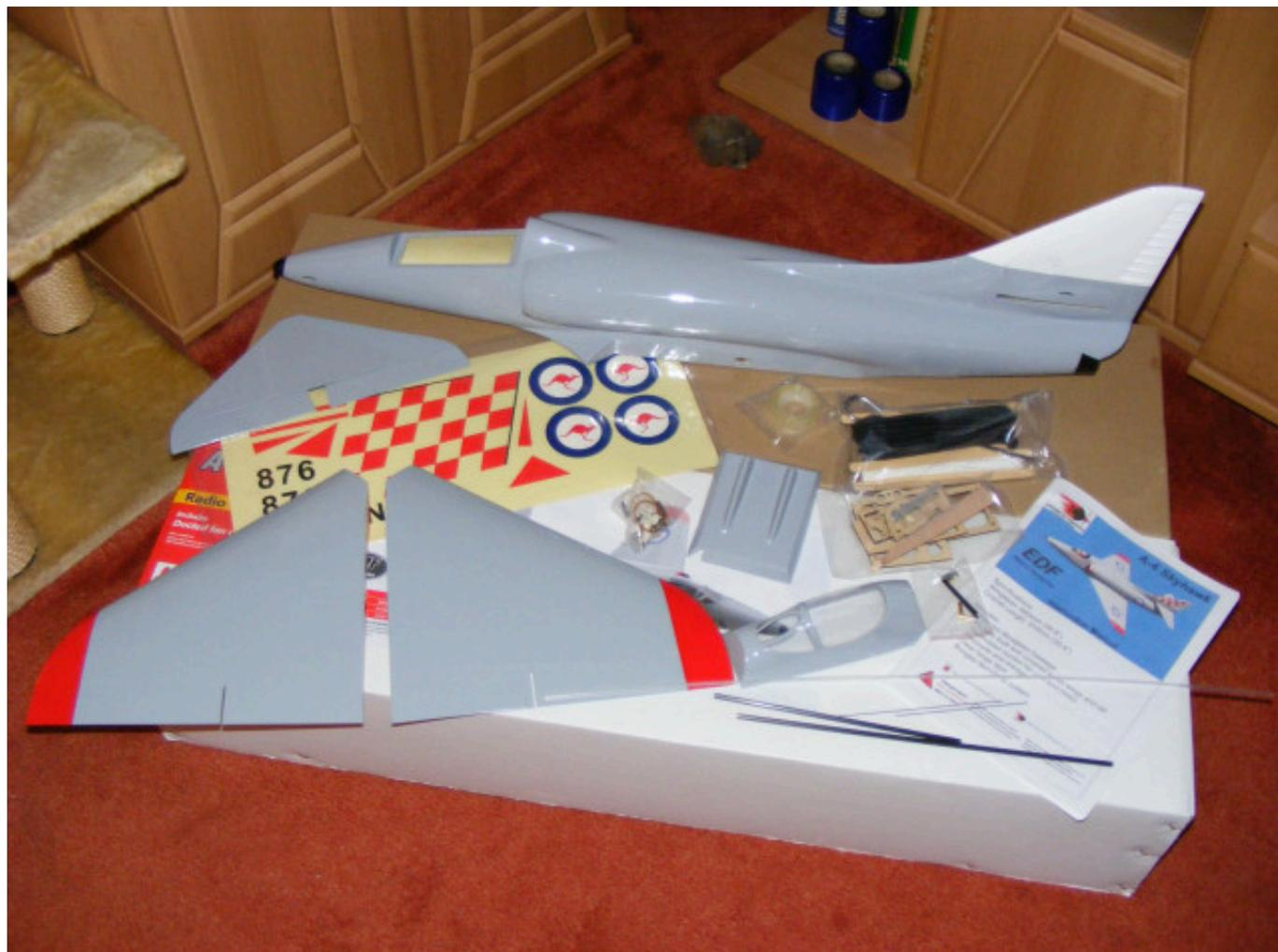
Die Spannweite des Modells ist um zehn Prozent größer in Bezug auf die Originalrelationen, was aber nicht so sehr auffällt, und ja auch eher der Regelfall bei EDF-Modellen ist. Das Modell verfügt vorne über keine Einläufe sondern es sind unter dem Rumpf Cheater Holes, die für Luftzufuhr sorgen.
