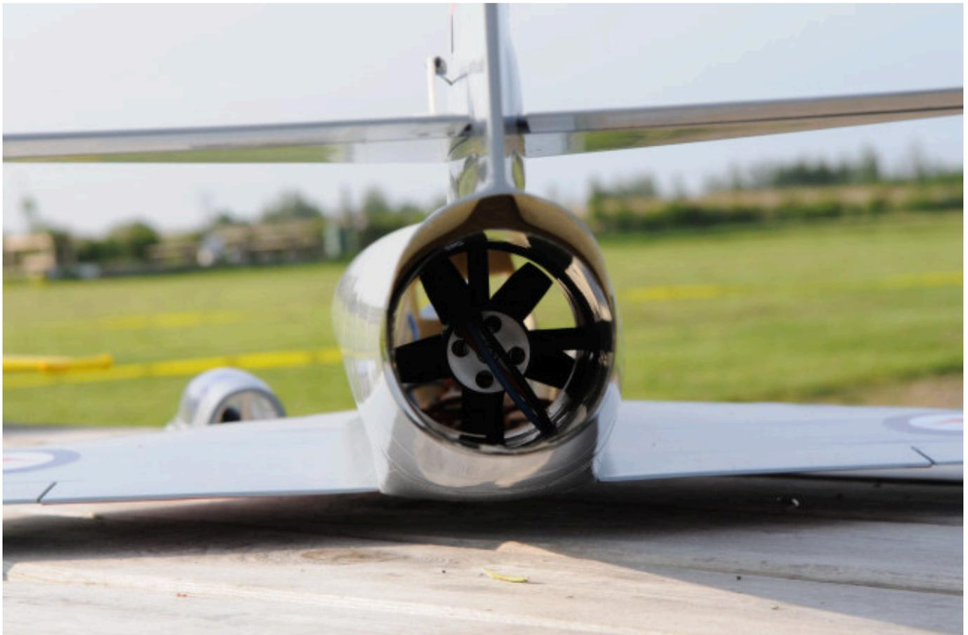
Nach dem der Impeller eingebaut war konnte der Auslass durch das Rumpfende durchgeschoben werden und mit dem Impeller durch Tesafilm gesichert werden. Die Motorkabel wurden durch die vorher hergestellte Bohrung geschoben, nach vorn verlegt und an den Kohlefaserrohren der Flächensteckung mit Kabelbindern gegen verrutschen gesichert. Anschließend kann die Wartungsklappe des Impellers verschlossen werden und an den Nahtstellen mit Tesa verklebt werden.
