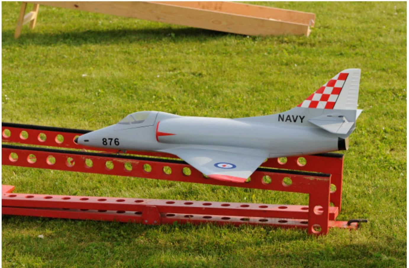
Der Start sowohl mit der beiliegenden Starthilfe, als auch über eine Rampe verläuft ohne Probleme und das Modell steigt schnell nach dem Start. Bei der beiliegenden Starthilfe wird das Modell in der Hand gehalten und dann losgelassen. Hier ist es wichtig, dass es beim Start etwas angestellt wird.
