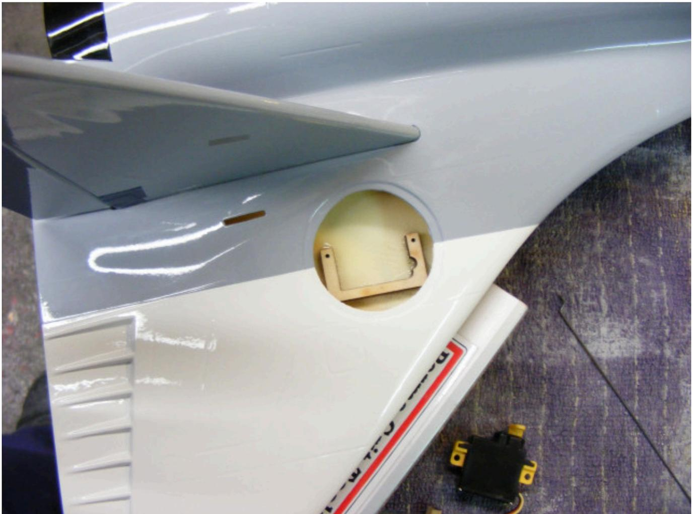
Das Höhenleitwerk wurde wieder eingesetzt und vermessen. Als alles im rechten Winkel war konnte durch die Servoöffnung des Seitenleitwerkes der obere Bereich des Höhenleitwerks im Rumpfinnenen mit ein paar Tropfen Sekundenkleber gesichert werden. Die eigentliche Verklebung erfolgte von unten durch die Düsenöffnung mit 5-Minuten-Epoxy.
