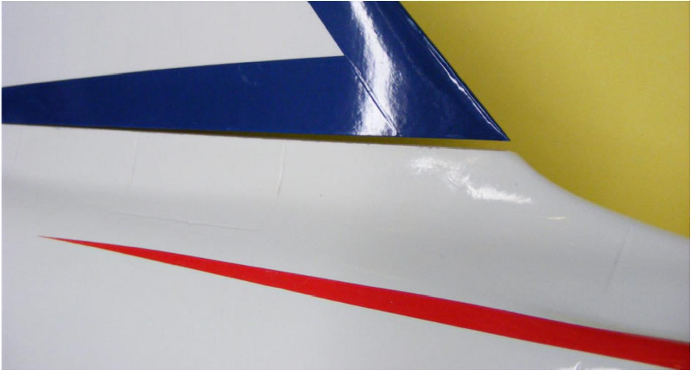
Diesen mit eingedicktem Harz auszufüllen würde nur eine eklatante Gewichtszunahme bedeuten. Daher wurde kurzerhand dieser Bereich mit Balsa aufgefüllt und verschliffen.
