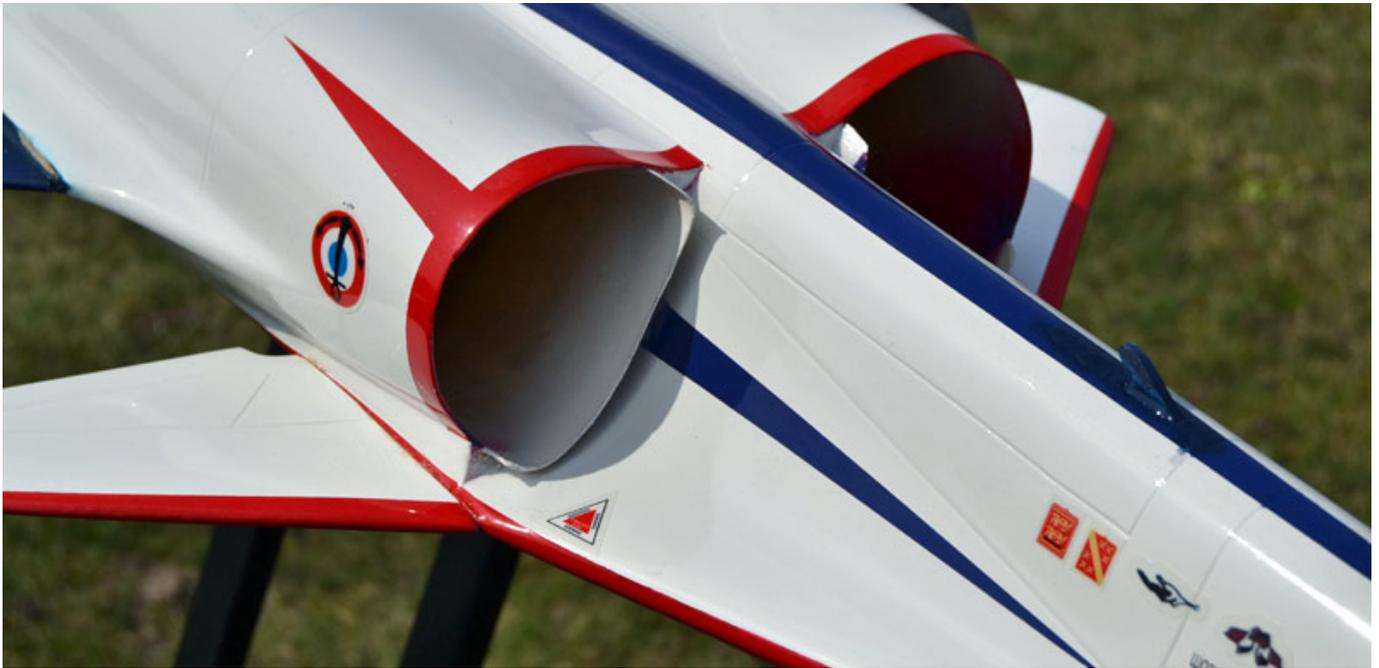
Da die Öffnungen für das Einziehfahrwerk bereits Herstellerseitig geöffnet sind, wurden diese mit Hilfe von ABS Platten, die leicht erwärmt und der Rumpfkontur angepasst wurden, verschlossen. Auf eine Verklebung wurde verzichtet und die Verschlussplatten mit durchsichtigem Klebeband befestigt.
