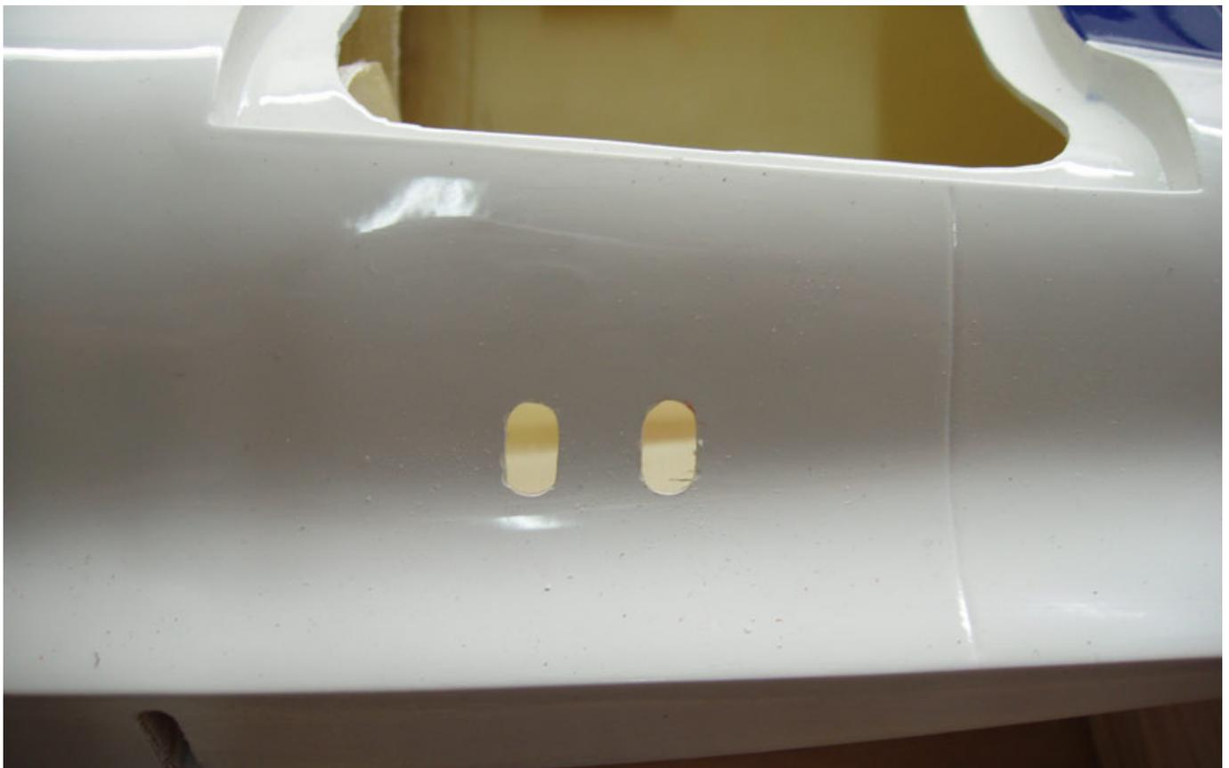
Die Einläufe weisen einen etwas größeren Durchmesser als der verwendete Wemotec Mini Fan Classic auf. Um diesen Größenunterschied zu kompensieren, muss der Mantel mit etwas Balsaholz aufgedoppelt werden.
