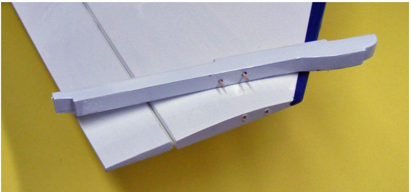
Allerdings sollten die Raketenschienen besser mit Stecknadeln fixiert werden, da sich beim Einsatz von Klebeband die Farbe abgelöst hatte.
