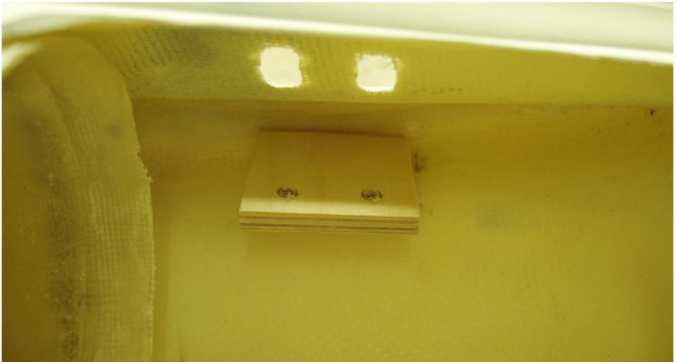
Da die Öffnung für die Impeller sehr schmal gehalten ist, müssen noch Löcher für die Impellerbefestigung in die Rumpfsseitenwand gebohrt werden.
