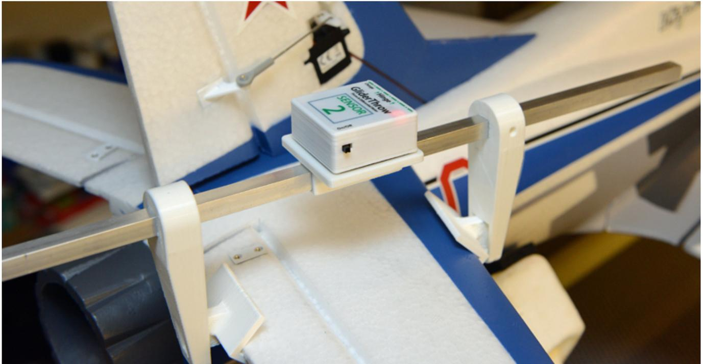
Für die Vermessung der EWD montiert man die Halterungen am Flügel und am Höhenleitwerk und setzt dann die Sensoren auf die dafür vorgesehene Fläche. Magnete sorgen hier ebenfalls für einen Halt der Sensoren.
