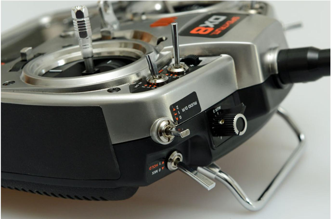
Auf der anderen Hälfte der Rückseite ist ein Schalter für Seitenruder-Dual-Rate sowie ein Schalter für eine Mischerfunktion vorhanden. Weiter gibt es noch mit dem AUX3-Drehgeber einen Regler für optionale stufenlose Funktionen.
