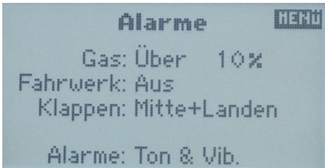
Es lassen sich weiter auch Alarme programmieren. Es werden dabei beim Einschalten oder nach Anwählen eines Modellspeichers die voreingestellten Alarmschwellen überprüft und ggf., wenn z. B. der Gashebel nicht in Nullstellung steht oder das Fahrwerk noch eingefahren ist, ein Alarm in Form von einem Ton und/oder Vibration ausgelöst.
