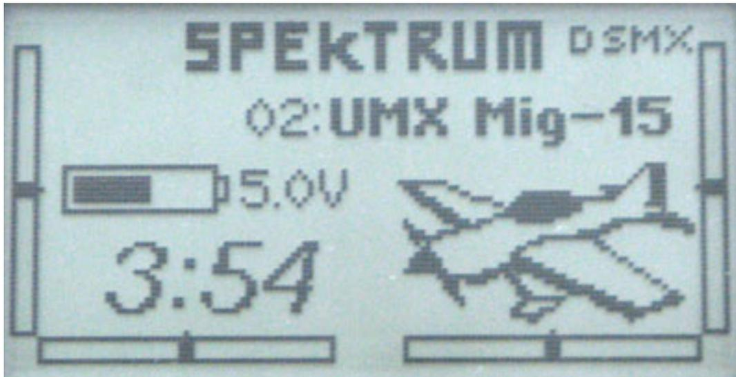
Die Menübedienung erfolgt mit den beiden Tastern CLEAR (löschen) und BACK (zurück) sowie dem Roll/Drucktaster rechts neben dem hintergrundbeleuchteten LC-Display. Mit dem Roll/Drucktaster lassen sich Menüpunkte anspringen und durch den Taster aktivieren. Mit dem Roll/Taster wird dann der Wert eingestellt und mit dem BACK-Taster kommt man wieder in die vorherige Menüebene.
