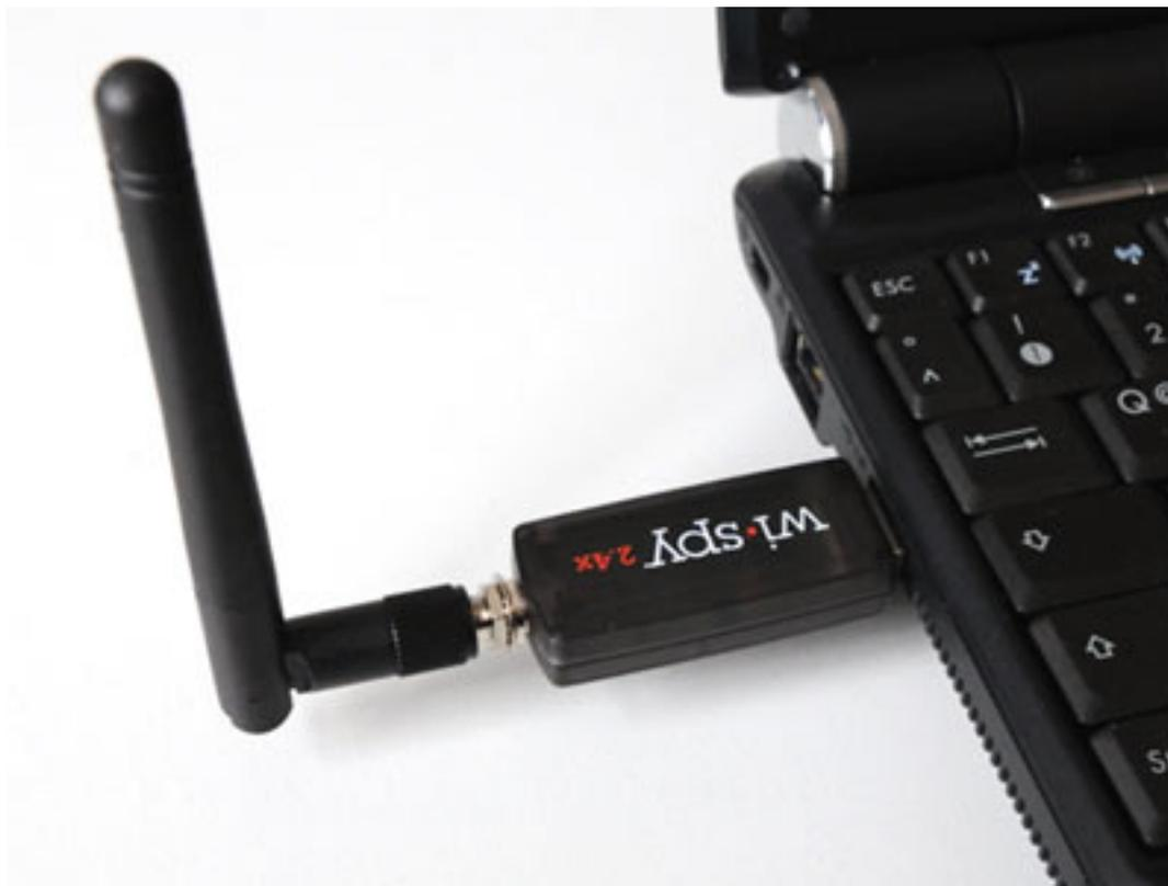
Ein USB-Stick mit einem Empfänger und einer aufgeschraubten Antenne wird mit dem PC verbunden. Auf dem Rechner wird die Software Chanalyzer installiert, mit der man einen sehr guten Überblick bekommt, aber auch sehr gute Detailmessungen durchführen kann.
