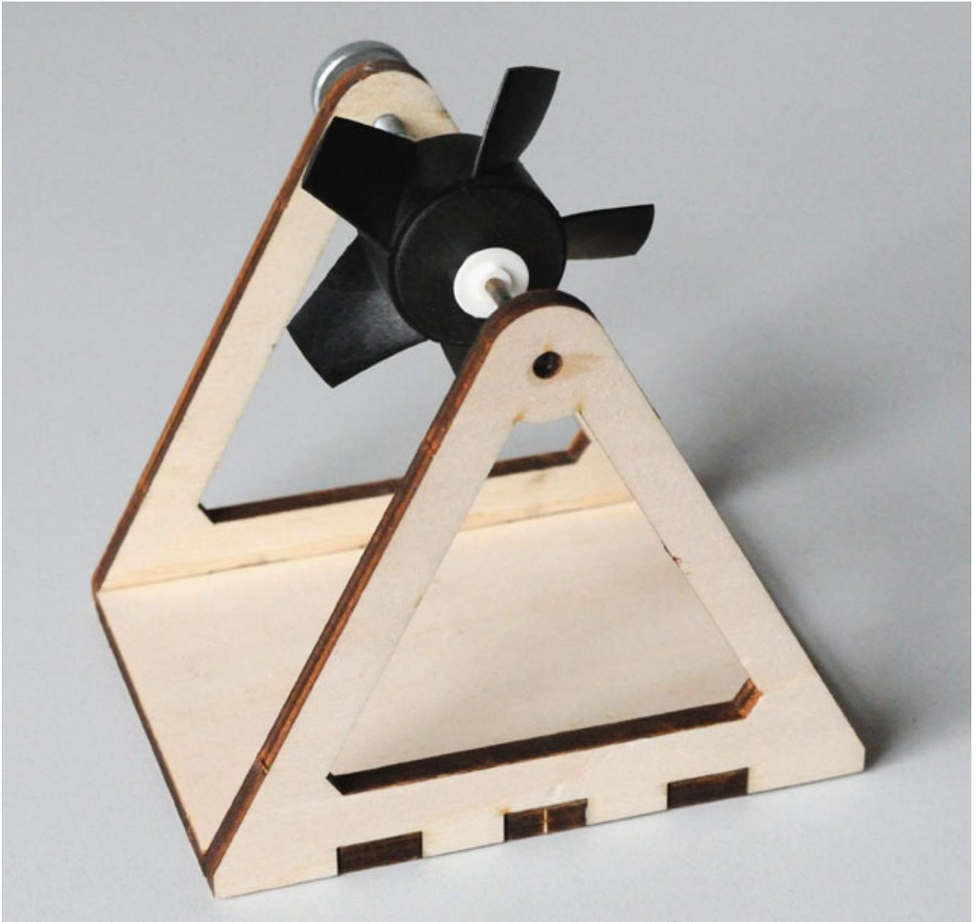
Der Impeller wird zur Vermessung auf die Achse gesteckt und mit zwei beiliegenden, konisch zulaufenden Plastikteilen auf der Welle fixiert.
