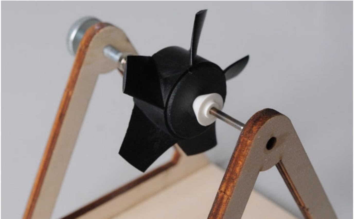
Die Welle wird durch die beiden Neodym-Magneten gehalten. Um die Reibung so gering wie möglich zu halten, und so die Messgenauigkeit zu erhöhen, berührt nur eine Spitze der Achse einen Magneten. Der Abstand lässt sich mit einer Stellschraube so einstellen, dass er die zweite Spitze nicht berührt. Die Spitzen sind in einem speziellem Profil geschliffen, um auch hier nur die geringst mögliche Reibung zu verursachen.
