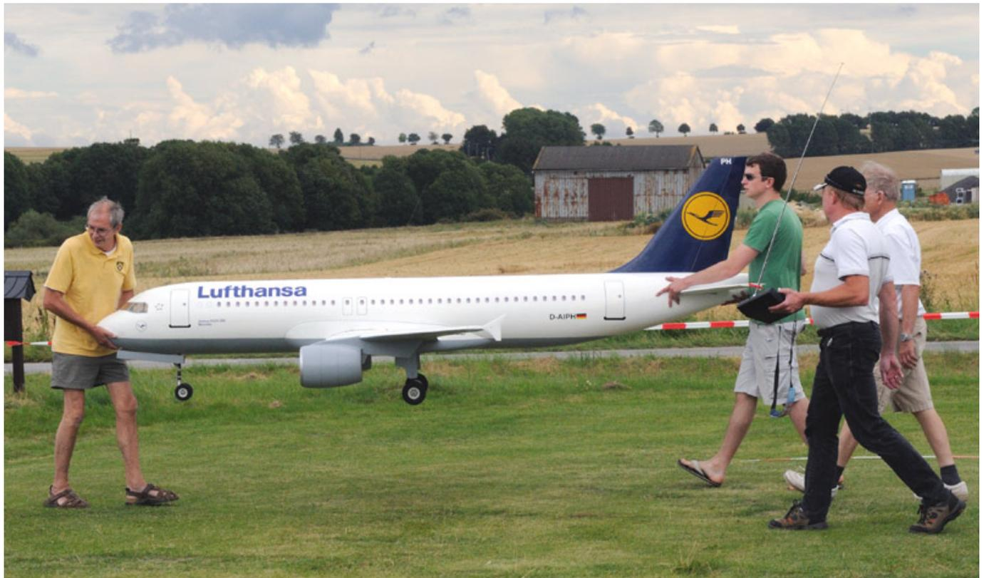
Der Rumpf besteht aus normalem Baustyropor und zwar aus ein Meter großen Blöcken geschnitten. Die einzelnen Segmente wurden verklebt und die entstandene Röhre mit einer Wandstärke von zwei Zentimeter trägt auch statisch das ganze Modell.
