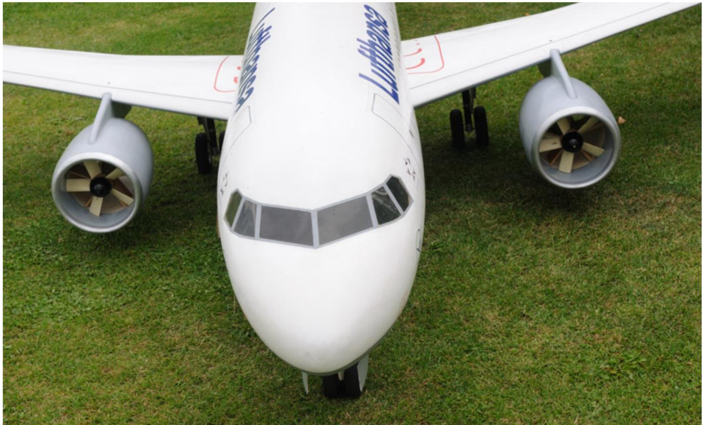
Die Cockpitscheiben sind transparent und in Rahmen gesetzt. Das Cockpit selbst ist nicht ausgebaut. Die Scheiben der Kabine werden mit schattierten Folien angedeutet.
