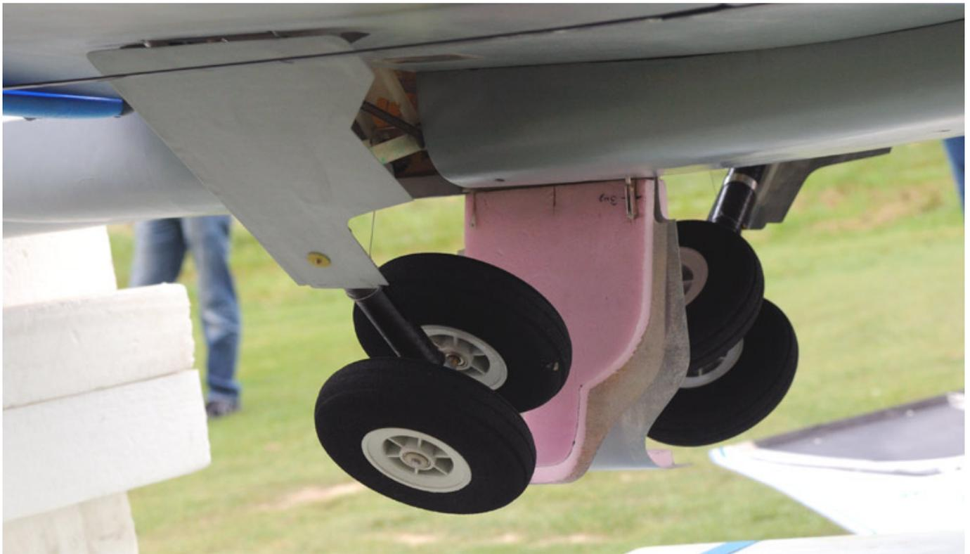
Was auch noch sehr viel Arbeit bereitet hat war die Konstruktion des Fahrwerks. Aber auch hier spielte die Gewichtsoptimierung eine große Rolle. Eine Ursache warum am Fahrwerk relativ lange gearbeitet wurde war auch, dass die Bauhöhe im Flügel lediglich 30 Millimeter betrug. Es musste das 15-mm-Rohr sowie Gelenke etc. untergebracht werden, was nicht ganz so einfach war.
