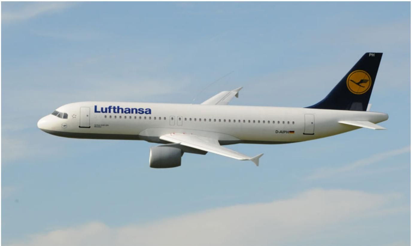
Der Schwerpunkt liegt bei ca. 50 Prozent der Wurzeltiefe. Der Einstellwinkel ist ca.  $1/2$  Grad. Die Maschine lässt sich sehr lange ziehen und ist sehr abrissicher, es ist leicht beherrschbar und stabilisiert sich gut in der Luft. Die ungefähr ein Kilowatt Eingangleistung pro Motor sorgt dafür, dass sich der Flieger sehr gut auf Rasen starten lässt. Ist die A-320 einmal in der Luft lässt es sich schon mit Viertelgas fliegen.
