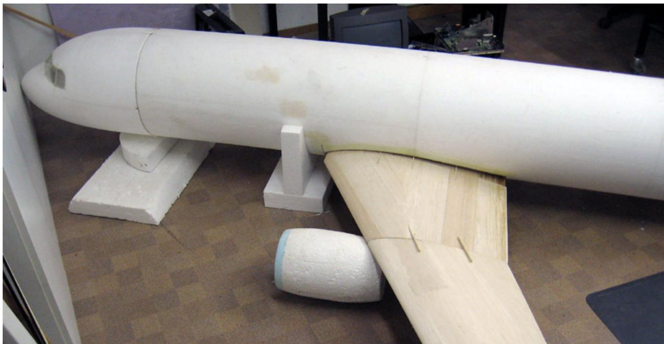
Die Nase wurde in einer Schnitttechnik hergestellt, zunächst grob mit zwei Schnitten vorgearbeitet und dann den Rest entsprechend weggeraspelt. Die Hecksektion ist genau so entstanden. Mit dem heißen Draht grob vorgearbeitet und dann geraspelt. Der gesamte Rumpf ist in einem Stück aufgebaut und nicht in Segmente teilbar. Auch der Flügel besteht aus einem Stück. Eine andere Lösung wäre nicht nur mit einem erheblichen Mehraufwand zu realisieren gewesen sondern zudem auch deutlich schwerer.
